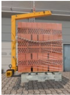
Abb. 90 Krangabel mit Sicherungskette
