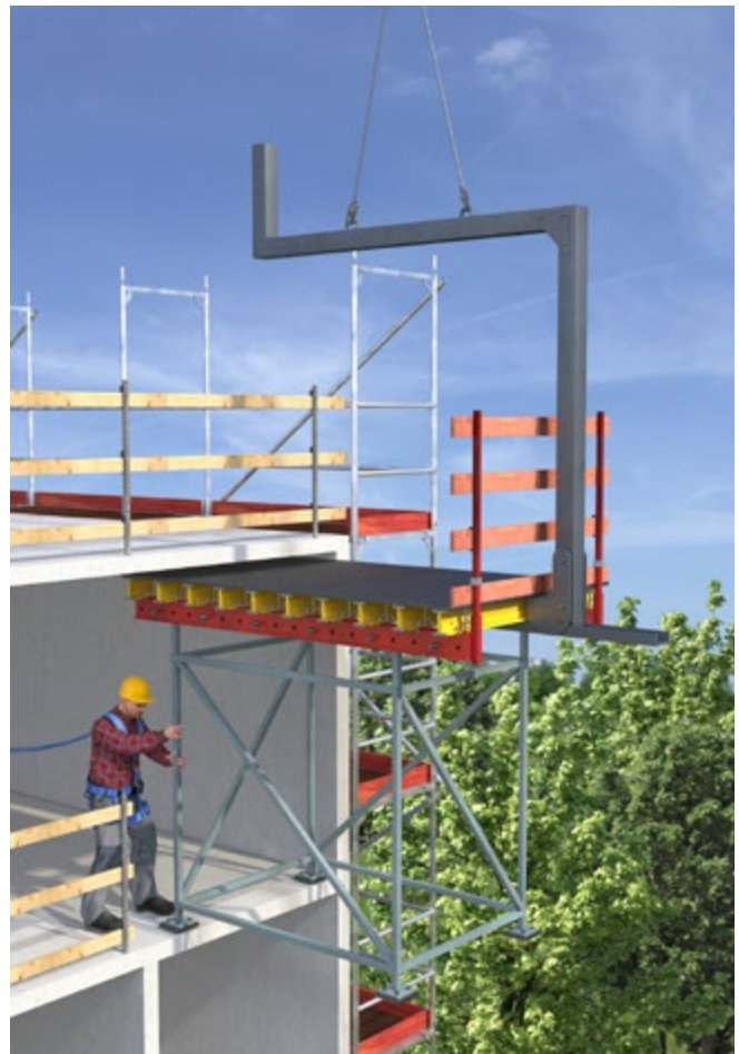
Abb. 120 Schaltisch mit integriertem Seitenschutz
