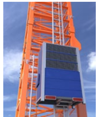
Abb. 142 Aufzug am Turmdrehkran
