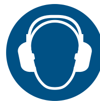
Abb. 25 Das Gebotszeichen kennzeichnet Bereiche in denen das Tragen von Gehörschutz Pflicht ist (M 003)
