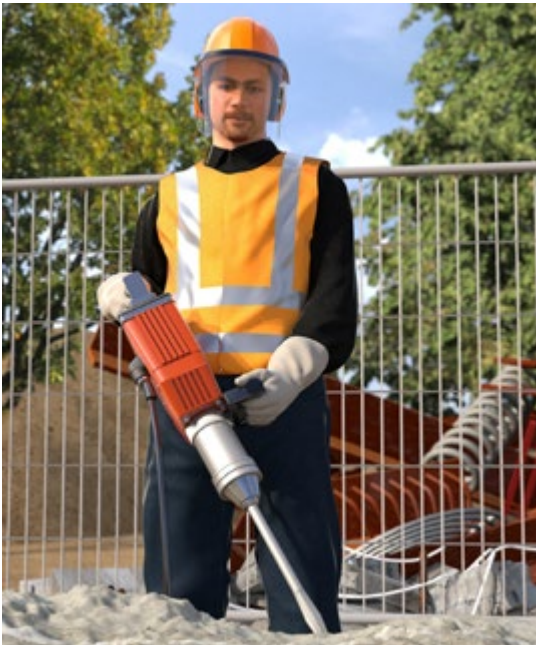
Abb. 26 Persönliche Schutzausrüstung bei Arbeiten mit dem Stemmhammer
