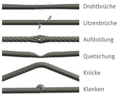
Abb. 91 Beispiele für Ablegekriterien von Drahtseilen
