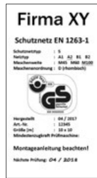
Abb. 60 Beispiel einer Kennzeichnung des Schutznetzes nach EN 1263-1
