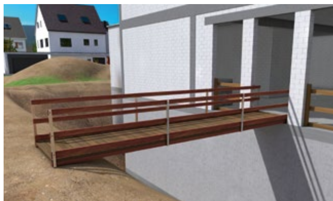
Abb. 8 Laufsteg mit Seitenschutz als Verkehrsweg
