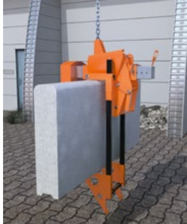
Abb. 112 Lastaufnahmemittel mit Sicherungsbügel für großformatige Teile
