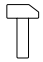
Abb. 15b Mit dem Hammersymbol werden Betriebsmittel gekennzeichnet, welche für den „rauen Betrieb“ geeignet sind
