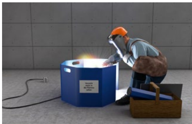
Abb. 68 Schutz weiterer Personen durch Abschirmung beim Lichtbogenschweißen
