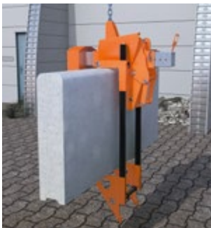
Abb. 89 Lastaufnahmemittel mit Sicherungsbügel für großformatige Steine
