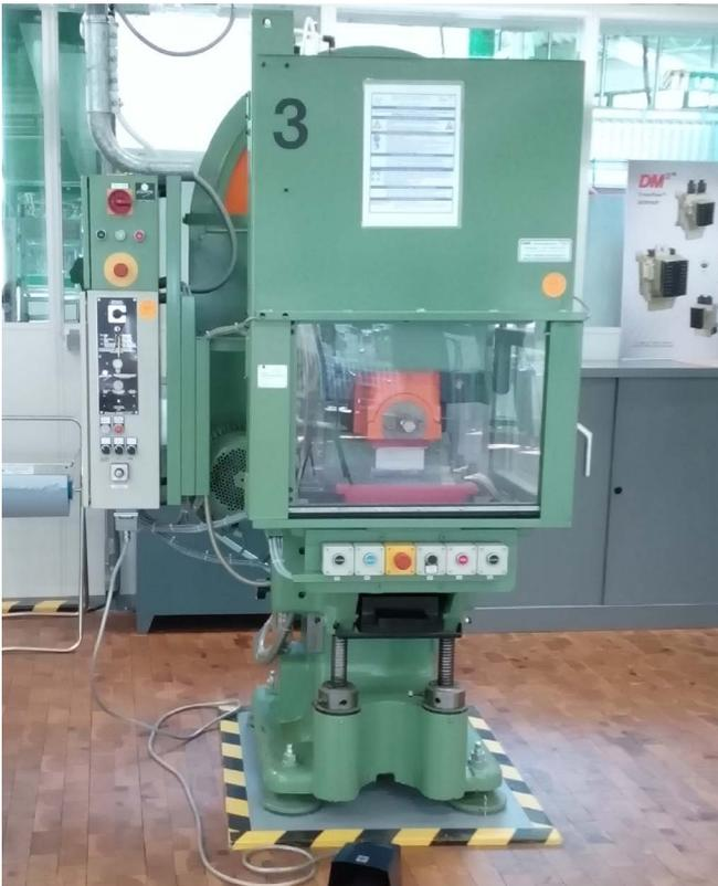
Abb. 21 BA „Schutzschirm“ an Exzenterpresse
