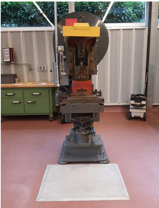
Abb. 19 SWZ an Exzenterpresse
