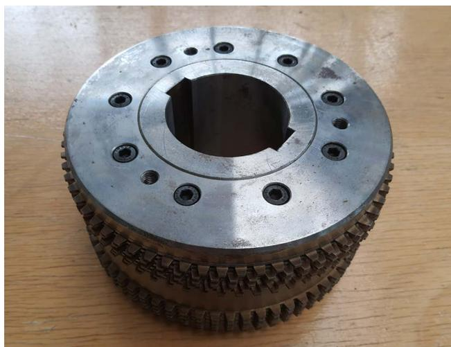
Abb. 13 Kupplungs-Brems-Kombination
