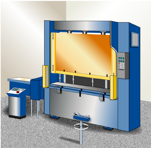
Abb. 5 Hydraulische Presse, Antrieb
