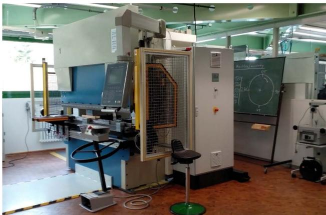
Abb. 33 Hydraulische Gesenkbiegepresse
