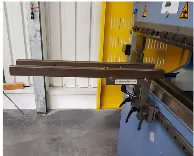
Abb. 41 Werkstückauflagen an Gesenkbiegepresse
