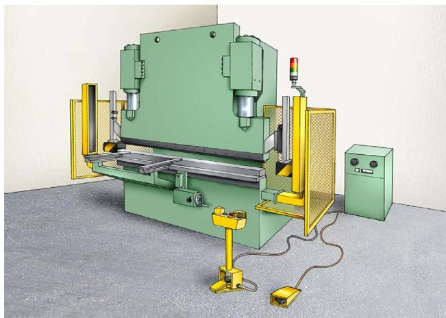
Abb. 6 Hydraulische Gesenkbiegepresse
