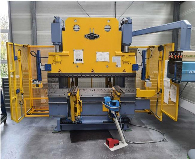
Abb. 39 Hydraulische Gesenkbiegepresse
