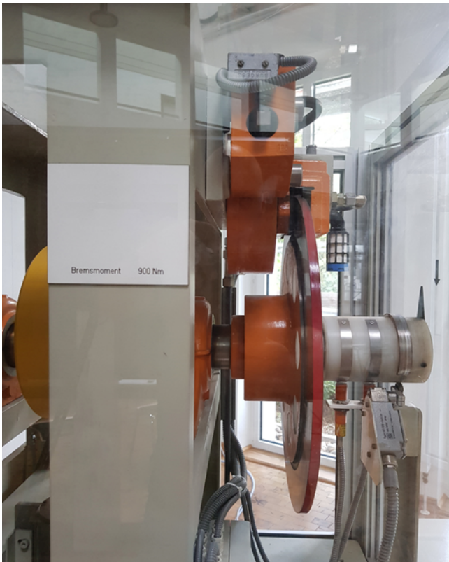
Abb. 15 Durchlaufsicherung (in Form einer Zusatzbremse)
