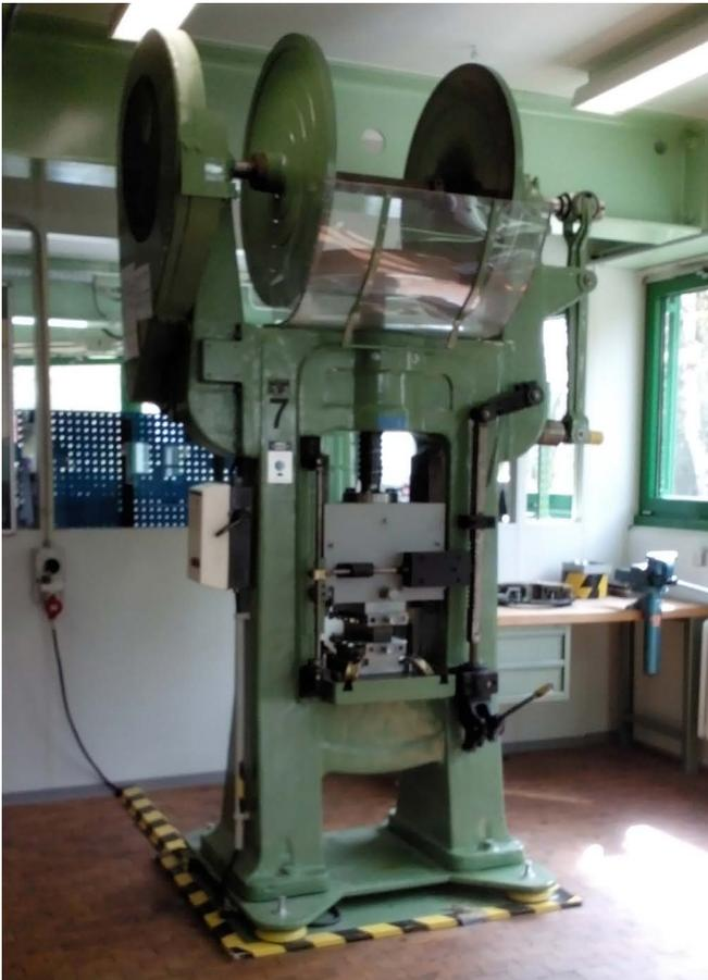
Abb. 4 Reibspindelpresse, Antrieb
