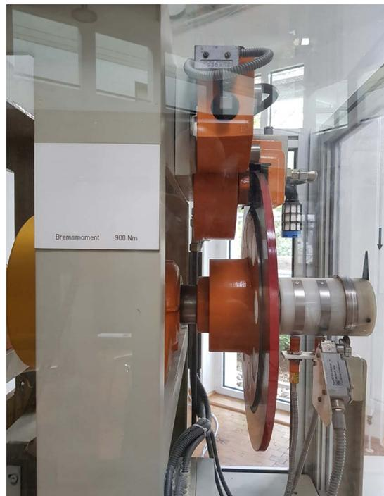
Abb. 15 Durchlaufsicherung (in Form einer Zusatzbremse)
