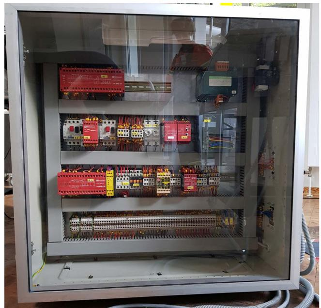
Abb. 11 Elektrische Pressensteuerung
