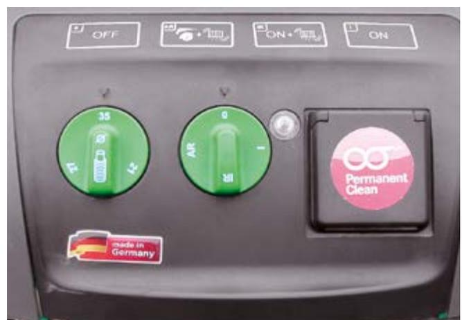
Abb. 9 Wahlschalter „Schlauchdurchmesser/Mindestluftvolumenstrom“ an einem Entstauber
