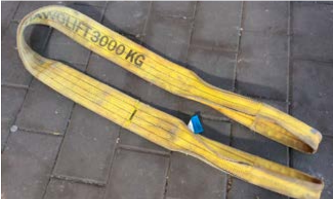
Abb. A1.9 Beispiel für Anschlaggurte zum Transport
