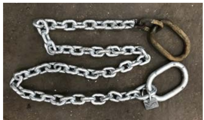
Abb. A1.8 Beispiel für Anschlagketten zum Feuerverzinken
