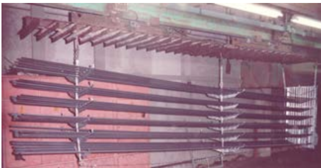
Abb. A1.3 Kombination aus Traverse und zugehörigem Gestell (hier ein Beispiel für ein Steckgestell).
