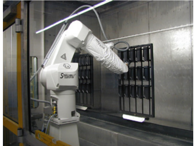
Abb. 9: Nassabscheidung mit Roboterapplikation
