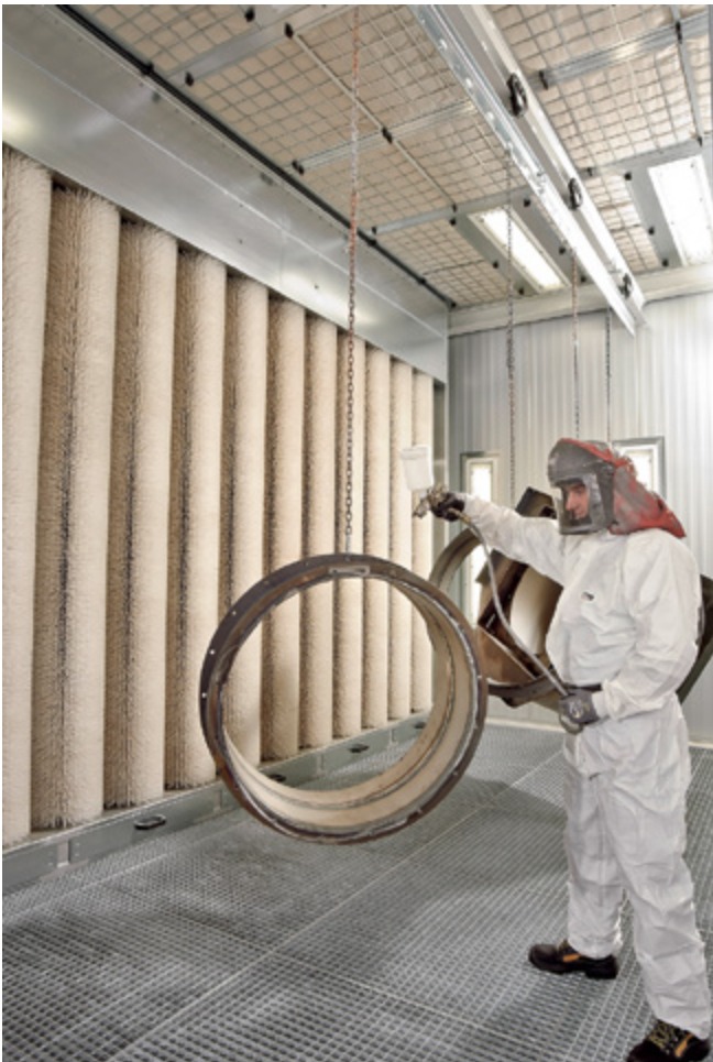
Abb. 8: Trockenabscheidung mit Rotationsbürsten
