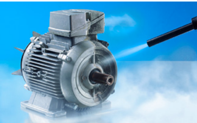
Abb. 11: Werkstückreinigung mit CO 2
