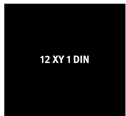
Abb. 6-1 Kennzeichnung eines Schweißschutzfilters entsprechend der Norm (Ausschnitt)
