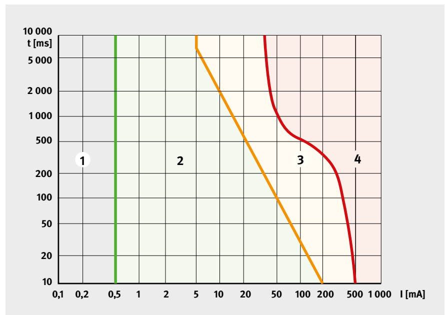
Abb. 3-3 Zeit-Stromstärke-Abhängigkeit der Auswirkungen von Wechselstrom bei Körperdurchströmung in Anlehnung an VDE V 0140-479-1
