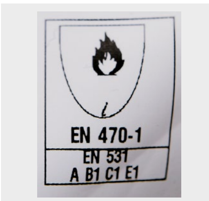
Abb. 8-8 Kennzeichnung schwer entflammbarer Kleidung
