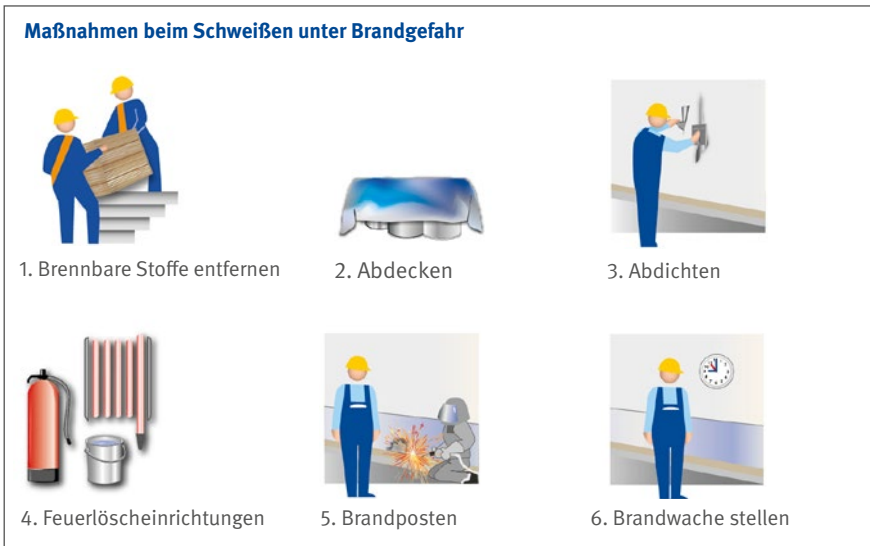
Abb. 8-3 Maßnahmen beim Schweißen unter Brandgefahr
