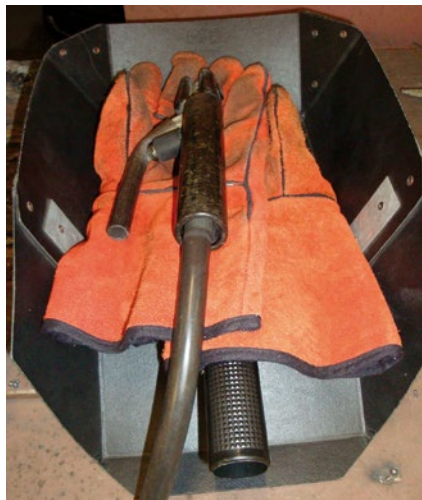
Abb. 4-2 Ohne Elektrodenrest isoliert abgelegter Stabelektrodenhalter
