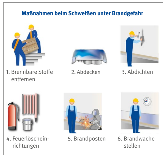
Abb. 15 Maßnahmen beim Schweißen unter Brandgefahr
