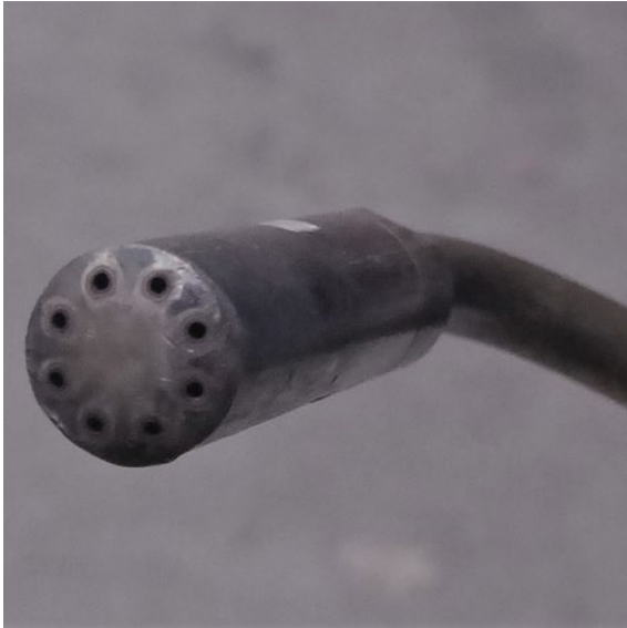
Abb. 8 Geräuscharmer Wärmebrenner mit Mehrlochdüse
