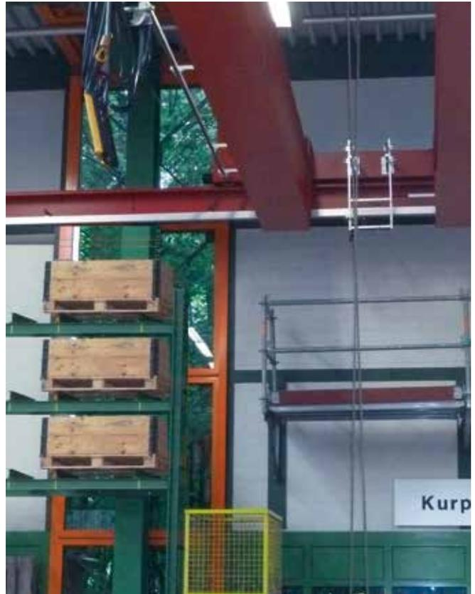
Bild 4-8: Die im Regal gelagerten Kisten ragen in den Verkehrsbereich des Kranes. Der Sicherheitsabstand nach unten von 0,5 m ist nicht eingehalten
