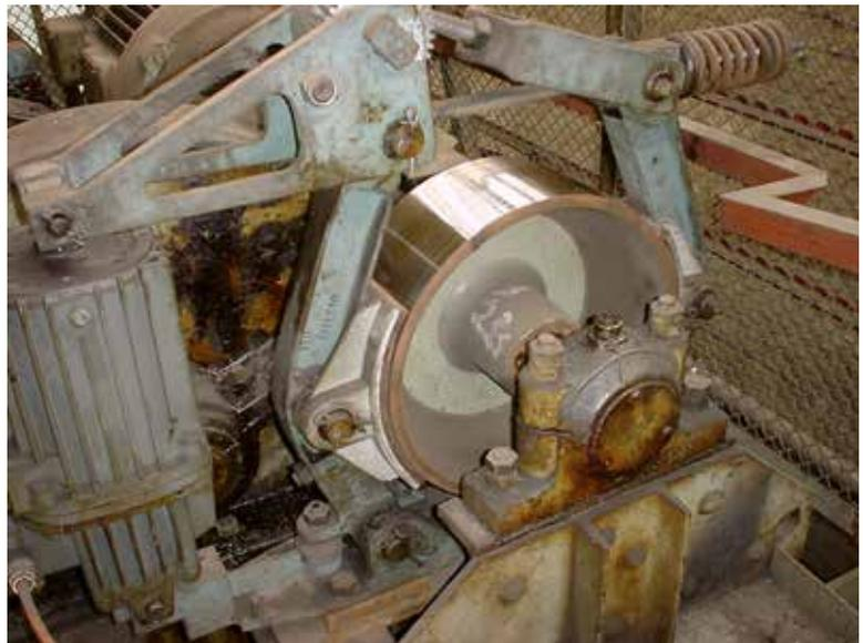
Bild 4-4: Inaugenscheinnahme einer Trommelbremse
