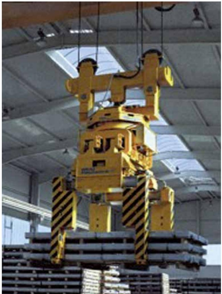
Bild 5-10: Motorisch angetriebene Zange
