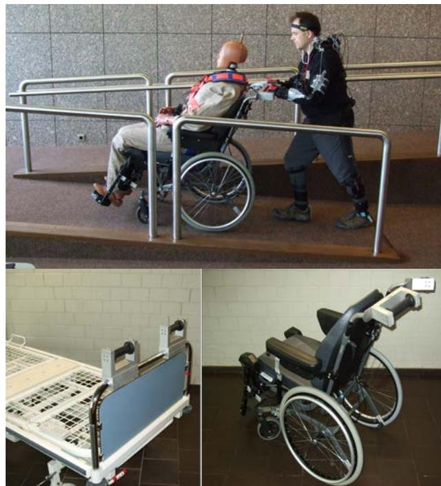
Körperhaltungsmesssystem und Dummy im Rollstuhl beim Befahren einer Rampe (oben). Kraftmessgriffe an Bett und Rollstuhl (unten),
