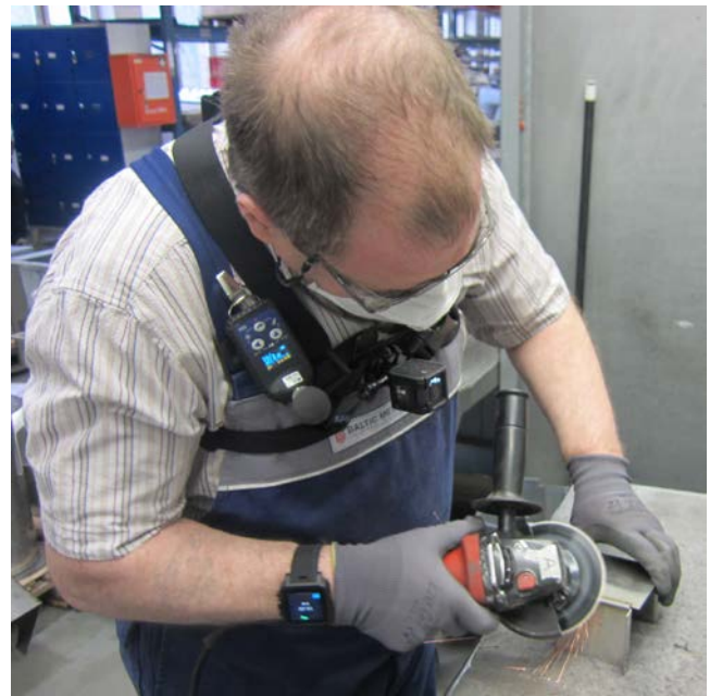
Kontrolle der Vibrationsexposition beim Schleifen mittels Smartwatch
