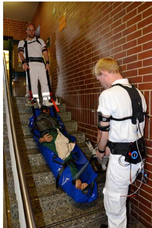
Versuchsaufbau für den Patiententransport mit dem Treppengleittuch
