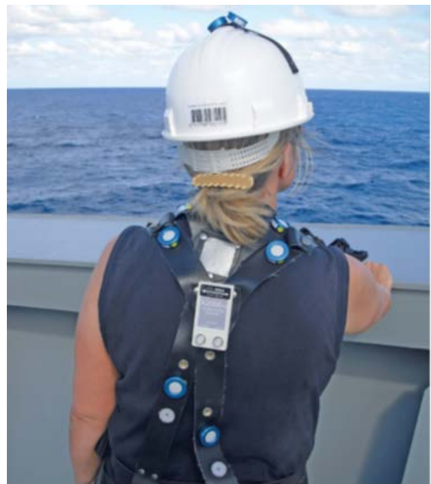
Anordnung der personengebundenen UV-Dosimeter
