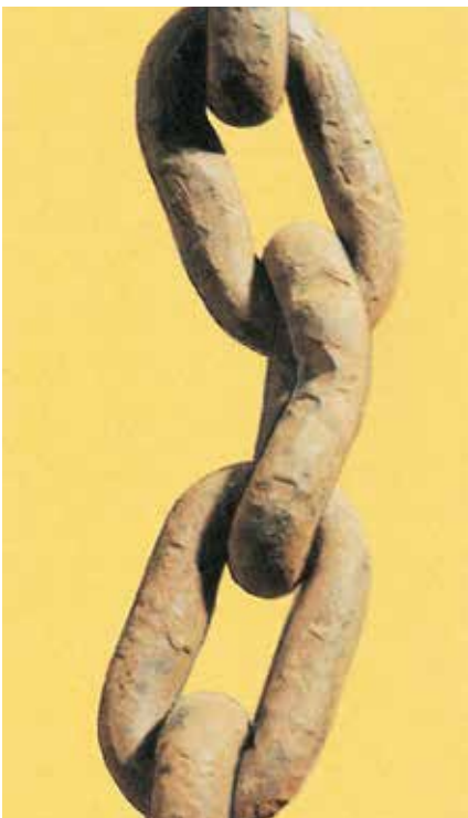
Bild 23-10: Kette mit verbogenem und eingekerbtem Kettenglied
