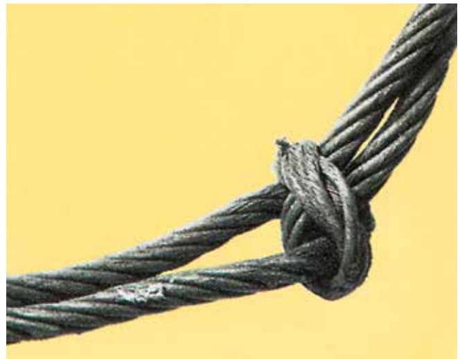
Bild 9-2: Unzulässiger Knoten zerstört den Seilverbund
