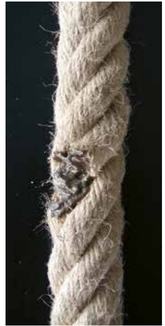
Bild 23-9: Wärmeeinfluss hat eine Litze zerstört
