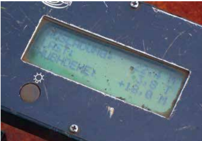
Bild 5-3: Steuerbirne mit digitaler Lastanzeige
