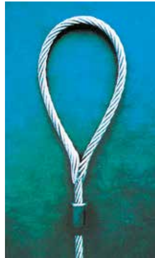
Bild 9-7: Die beiden Enden sind gegeneinander verseilt
