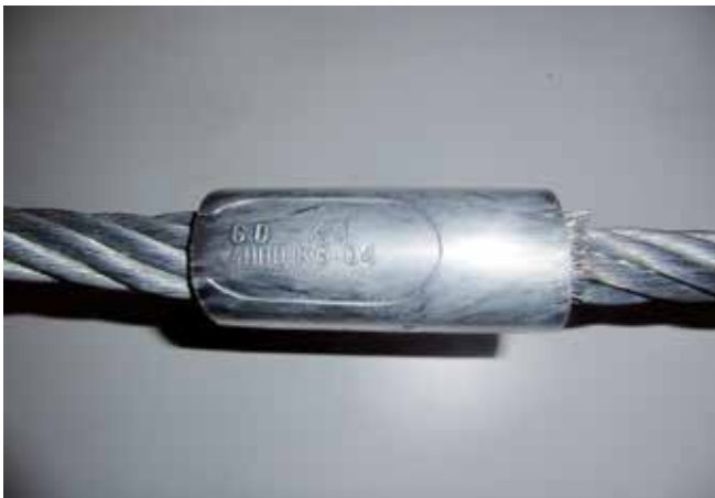
Bild 9-1: Pressklemme mit Verpresserkennzeichen
