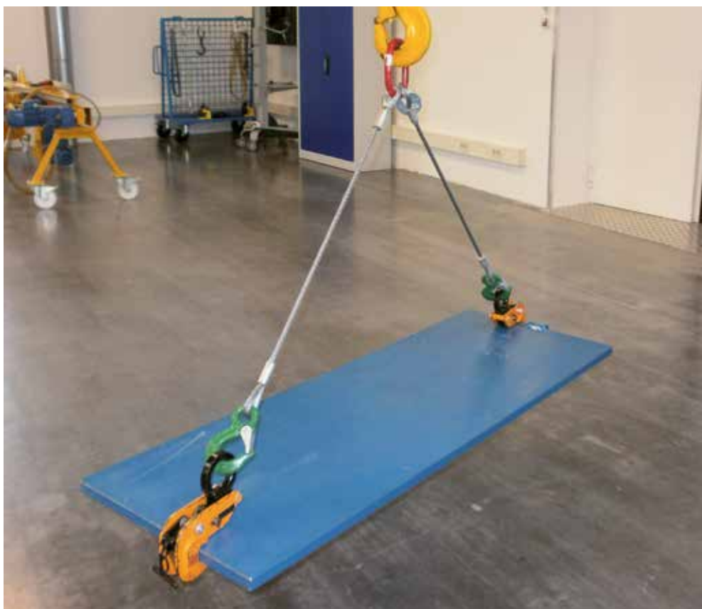
Bild 13-1: Blech horizontal sicher transportiert
