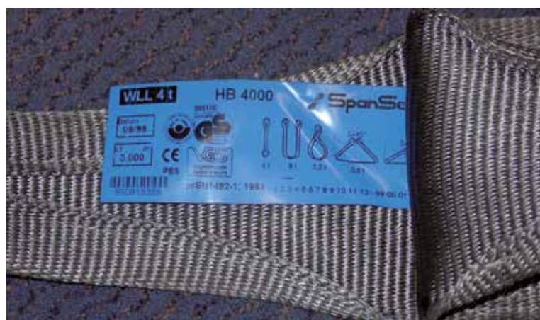
Bild 10-1: Polyester-Hebeband mit eingenahtem Etikett
