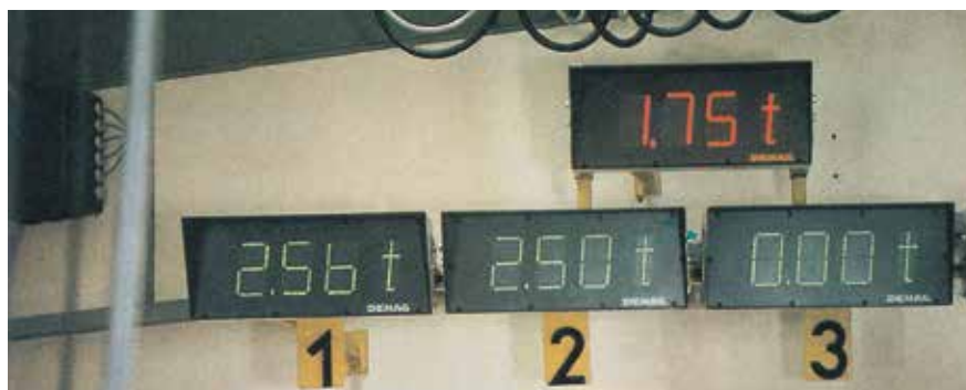
Bild 14-3: Im Einzelstrang werden über 2,5 t gemessen, obwohl das Gewicht der Last nur 1,75 t beträgt
