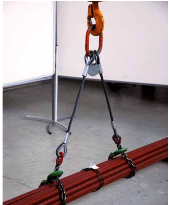
Bild 6-1: Kombination Seil/Kette zur Schonung der Drahtseile
