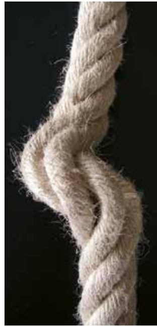
Bild 23-8: Durch Klanke zerstörter Litzenverbund
