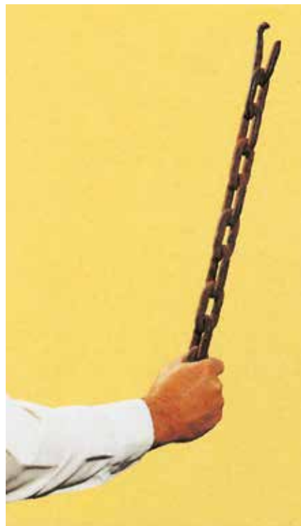
Bild 23-11: Durch Überlastung steif gezogene Kette
