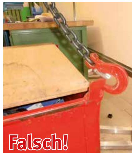
Bild 16-4: Haken rutschen bei Schlaffketten aus den Ösen
