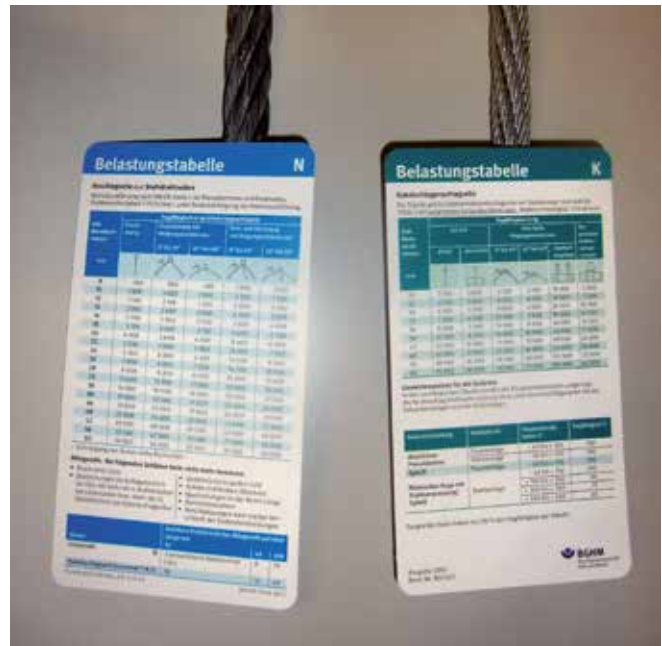
Bild 8-1: Die Belastungstabelle gibt für das schmiegsame Kabelschlagseil (rechts) eine geringere Tragfähigkeit an als für die links dargestellten Litzenseile
