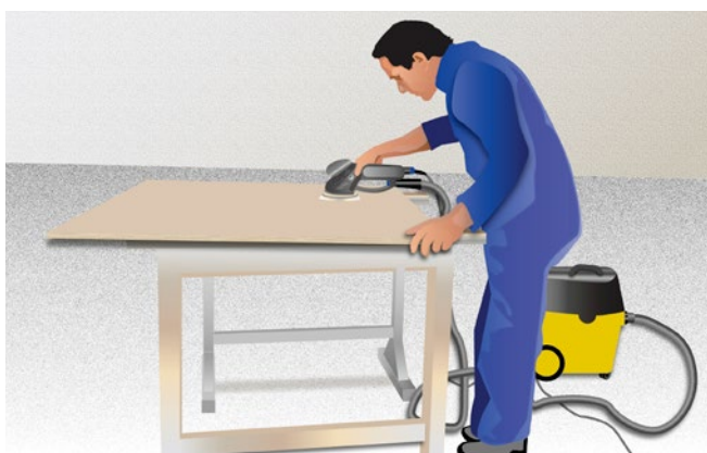
Abb. 17 Schleifen mit Absaugung
