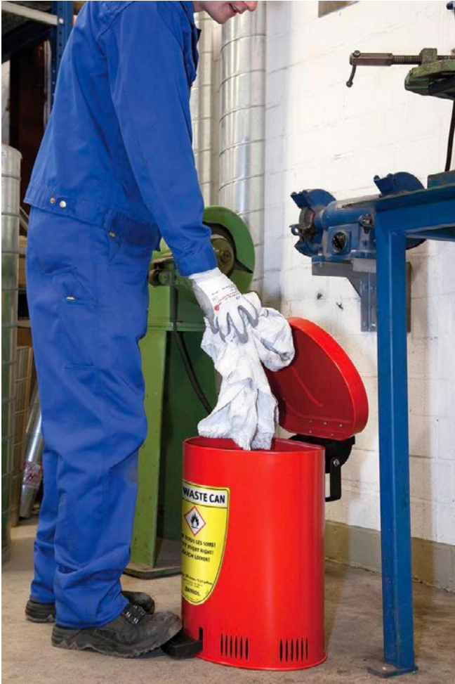
Abb. 30 Sammlung von gebrauchtem Putzmaterial
