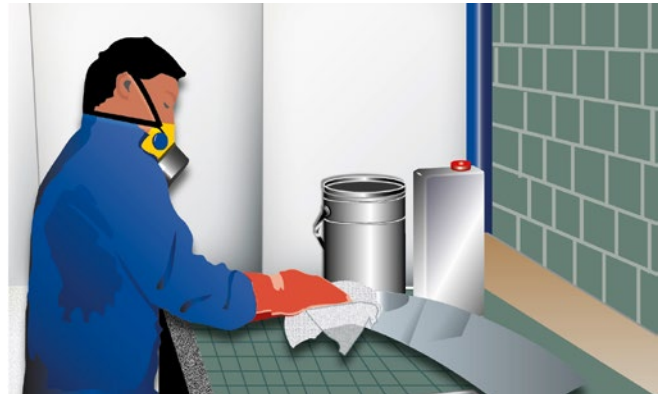
Abb. 21 Reinigen und Entfetten
