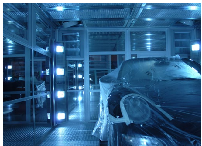
Abb. 26 Kombikabine in Spezialausführung mit UV-Strahlern
