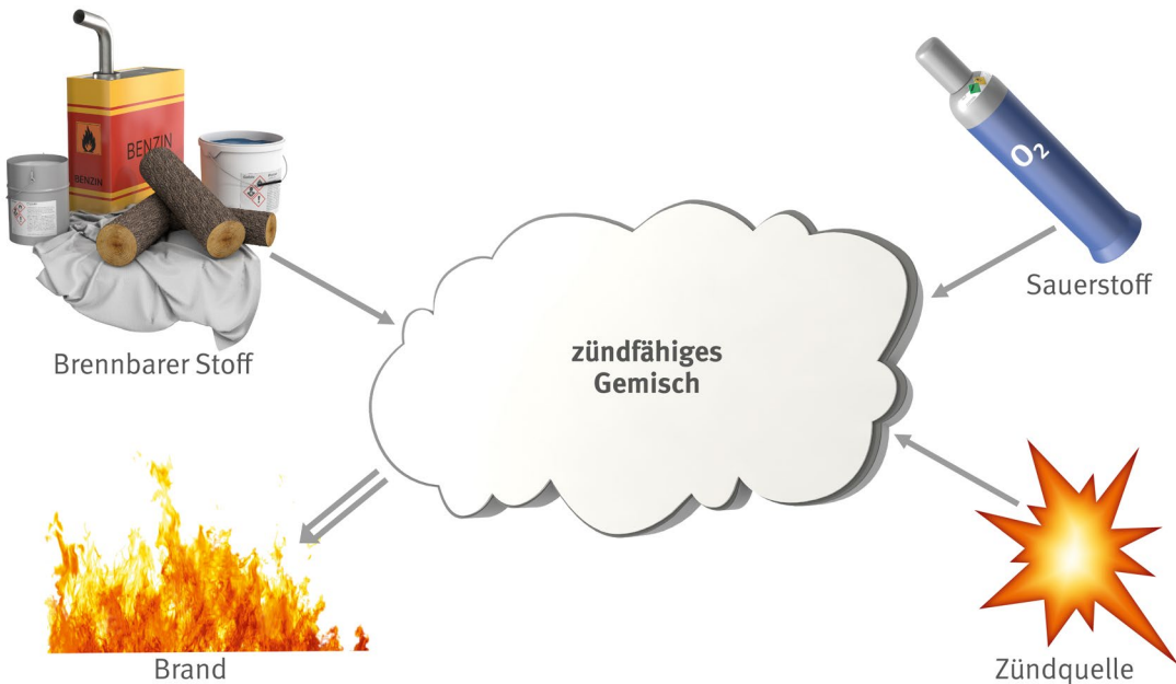
Abb. 3 Voraussetzungen für einen Verbrennungsvorgang
