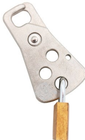
Abb. 41 Beispiel eines Schließbügels für bis zu drei Vorhängeschlösser, der erst nach Entfernen aller Schlösser geöffnet werden kann.
