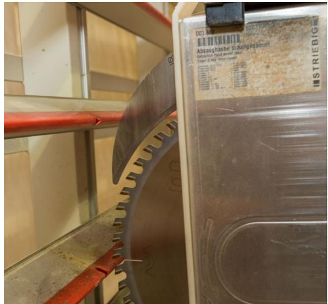
Abb. 87 Der Spaltkeil verhindert ein Schließen der Schnittfuge, sodass beim Horizontalschnitt keine Abschnitte weggeschleudert werden.
