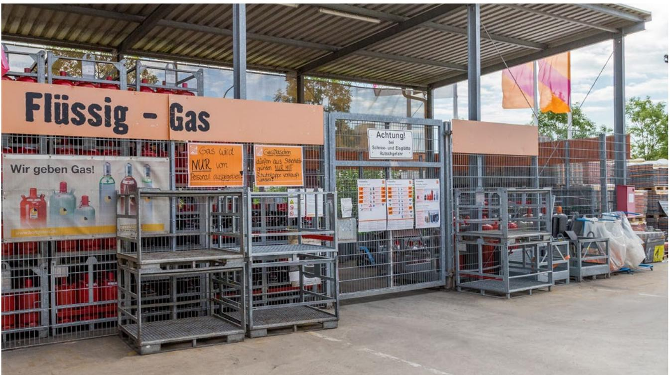
Abb. 92 Größere Mengen an Flüssiggasflaschen am besten im Freien lagern, da durch die natürliche Belüftung das Vorhandensein explosionsfähiger Atmosphären weitgehend verhindert wird.
