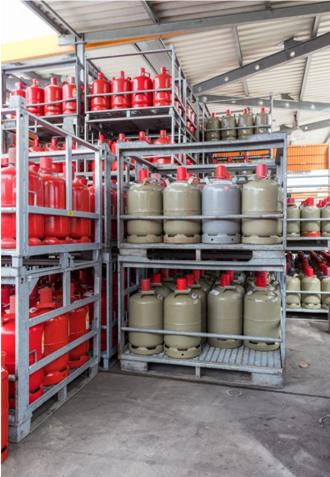
Abb. 94 Flüssiggasflaschen standsicher und gegen Umfallen und Herabfallen gesichert z. B. durch Ketten, Bügel. Bei größeren Mengen empfehlen sich spezielle Gasflaschenpaletten.
