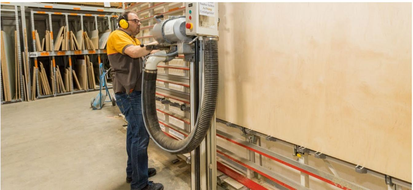
Abb. 86 Bearbeiten Sie nur Material auf der Säge, welches der Hersteller bezüglich Art, Form und Größe für die Säge gemäß Betriebsanleitung vorgesehen hat, und verwenden Sie das hierfür geeignete Sägeblatt.
