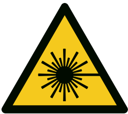
Abb. 34 Kennzeichnung am Gerät mit Warnhinweis „Achtung Laserstrahlung“.
