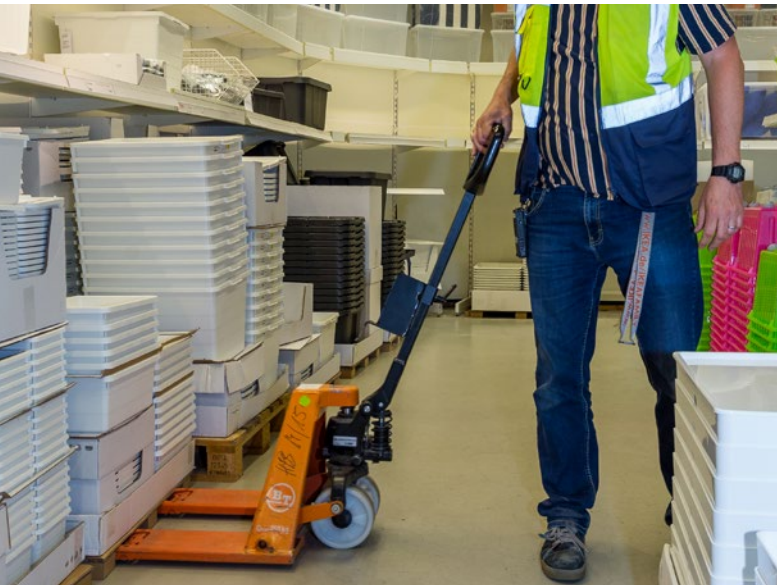
Abb. 10 Ist wenig Rangierraum vorhanden, ist der Handhubwagen gut geeignet, besonders bei geringen Lastgewichten. Handhubwagen gibt es auch mit elektrischer Unterstützung zur Reduzierung der körperlichen Belastungen Ihrer Beschäftigten.
