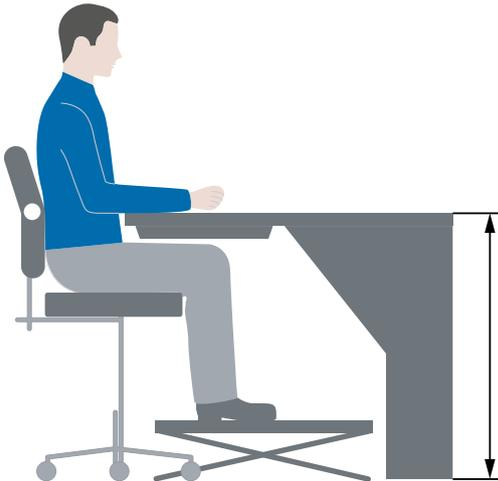
Abb. 48 Beim Sitz-Kassenarbeitsplatz beträgt die Arbeitshöhe in der Regel zwischen 0,73 m und 0,82 m.
