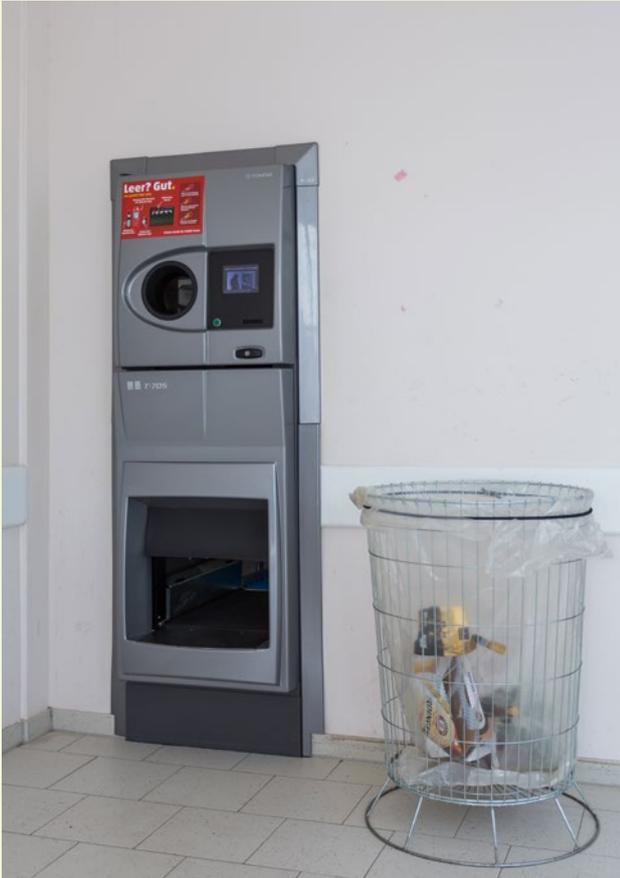
Abb. 81 Automatisierte Leergutrücknahmesysteme unterscheiden zwischen Einweg- und Mehrwegverpackungen sowie Getränkekästen
