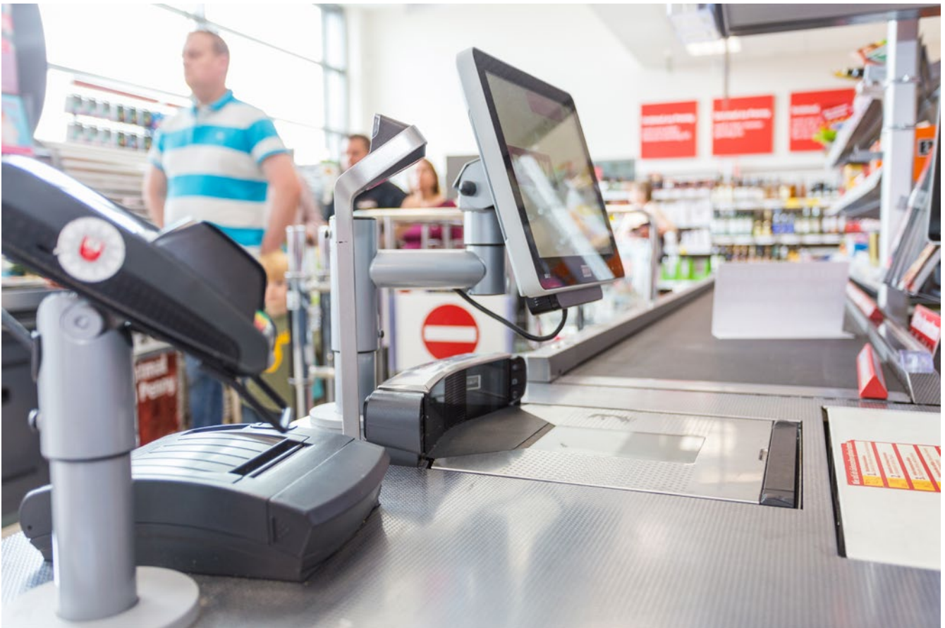
Abb. 47 Scanner sollten so eingebaut sein, dass die Ware leicht darüber oder daran vorbei geschoben werden kann, ohne sie anheben oder drehen zu müssen.
