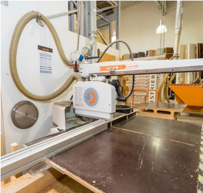
Abb. 88 Die Gehrungskappkreissäge wird zum Kürzen von Latten, Kanthölzern u. ä. oder für den Zuschnitt von Bilderrahmen eingesetzt.
