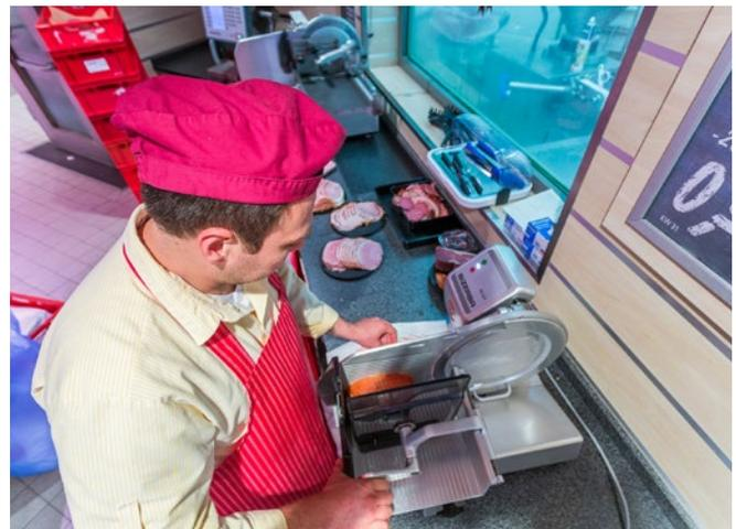
**Abb. 73** Resthalter zum Aufschneiden von Endstücken zu benutzen und Endstücke so zuzuschneiden, dass sie hinter den Resthalter passen.
