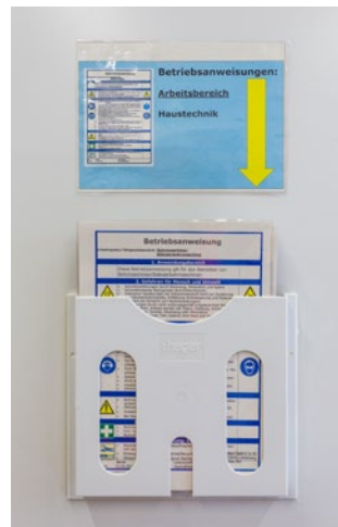
Abb. 4 Betriebsanweisungen müssen, bezogen auf Inhalt und Sprache, leicht verständlich formuliert und für die Beschäftigten griffbereit ausgelegt/-gehängt werden.
