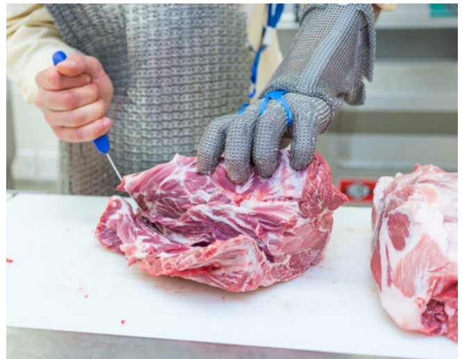
Abb. 71 Werden Messer in Richtung Körper geführt, sind Stichschutzhandschuhe evtl. mit Unterarmstulpe sowie Stichschutzschürze, -poncho oder -bolero zu tragen.
