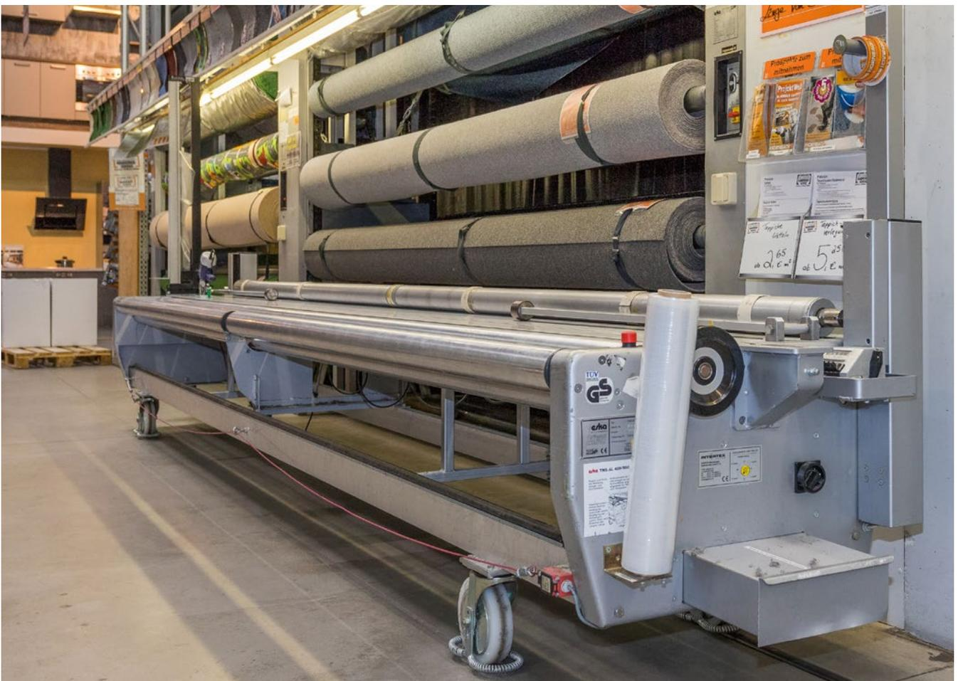
Abb. 89 Erleichtern Sie den Zuschnitt der Ware, indem Sie geeignetes Werkzeug am Paternoster anbringen; Dies können z. B. Schienen mit integrierten Messern, Schneidetische oder Schneidemaschinen sein.
