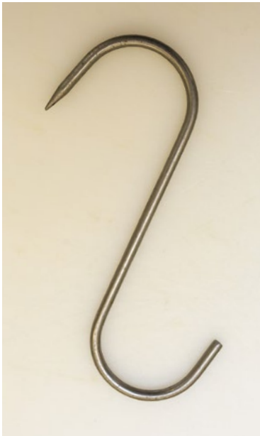
Abb. 72 S-Haken zum Aufhängen von Fleisch müssen einseitig abgestumpft sein. Für alle anderen Verwendungsarten dürfen nur beidseitig abgestumpfte S Haken eingesetzt werden.
