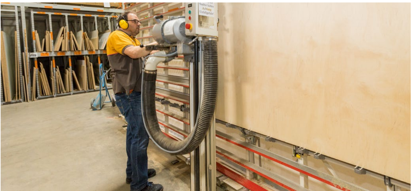
Abb. 86 Bearbeiten Sie nur Material auf der Säge, welches der Hersteller bezüglich Art, Form und Größe für die Säge gemäß Betriebsanleitung vorgesehen hat, und verwenden Sie das hierfür geeignete Sägeblatt.
