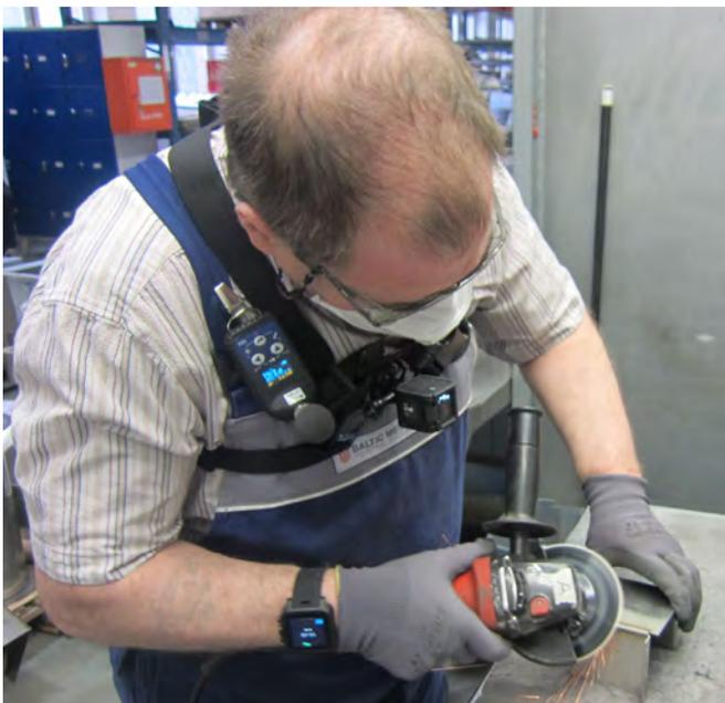
Hand-Arm-Vibration: Erprobung von Smartwatches zur Gefährdungsbeurteilung
