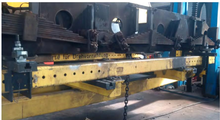
Wendevorrichtung mit aufgespanntem Werkstück
