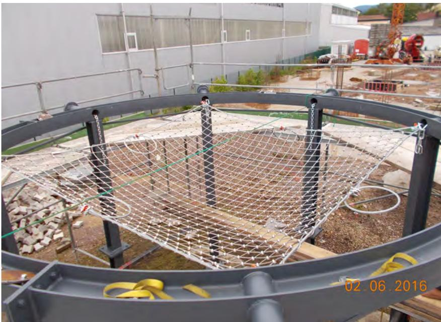
Prüfstand mit eingebautem Drahtseilnetz
