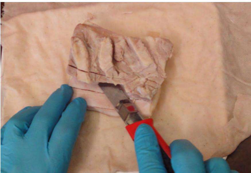
Vorbereitung eines Präparates für die Permeationsmessung
