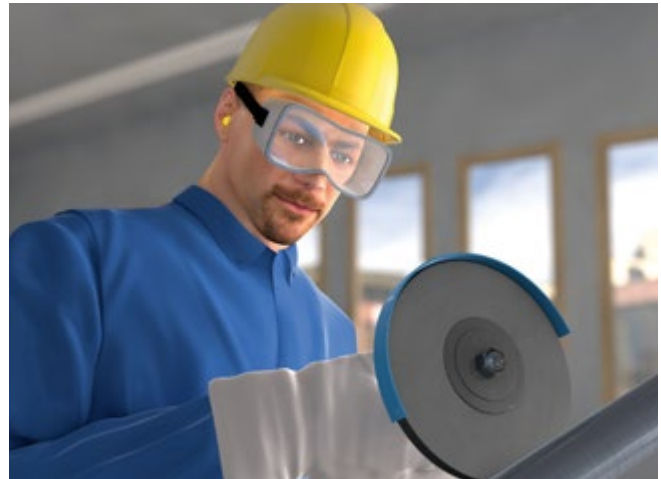
Abb. 126 Augenschutz bei Schleifarbeiten
