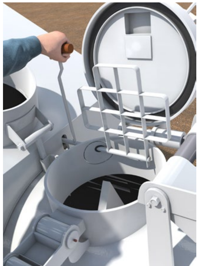
Abb. 103 Einwurf mit Schutzgitter an Estrichmaschine
