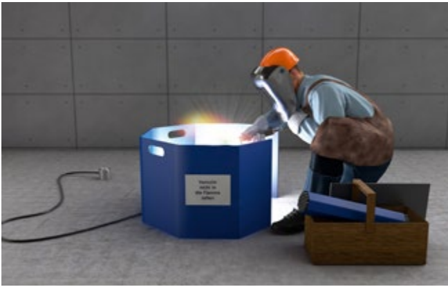
Abb. 85 Schutz weiterer Personen durch Abschirmung beim Lichtbogenschweißen
