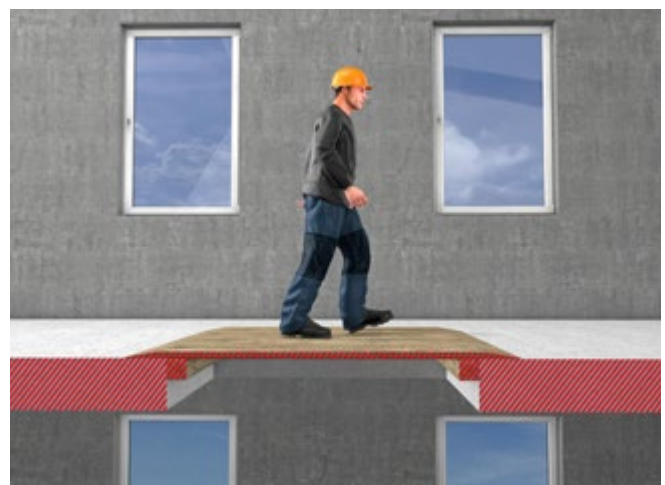
Abb. 8 Darstellung einer Bodenabdeckung im Schnitt
