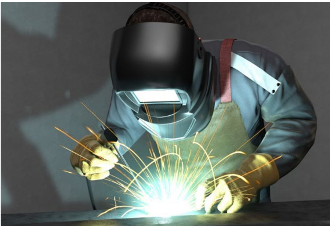
Abb. 83 Schweißen nur mit Schutzausrüstung
