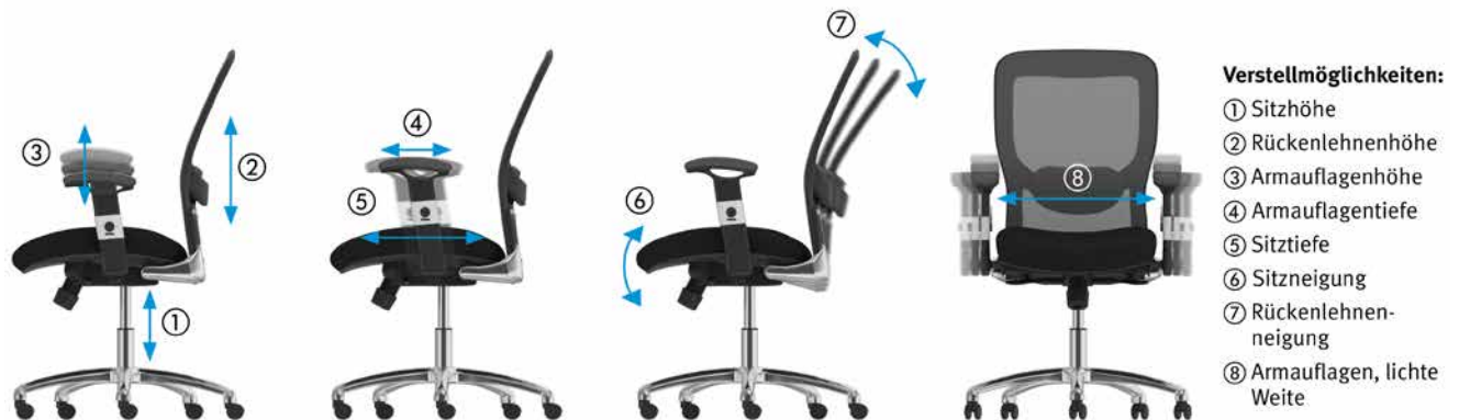
Abb. 19 Verstellmöglichkeiten an einem Büroarbeitsstuhl
