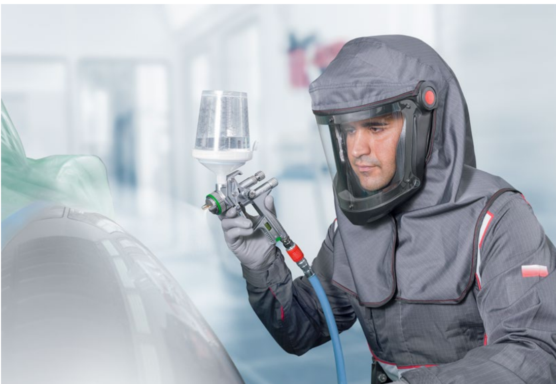
Abb. 2 Spritzlackieren mit HVLP-Pistole
