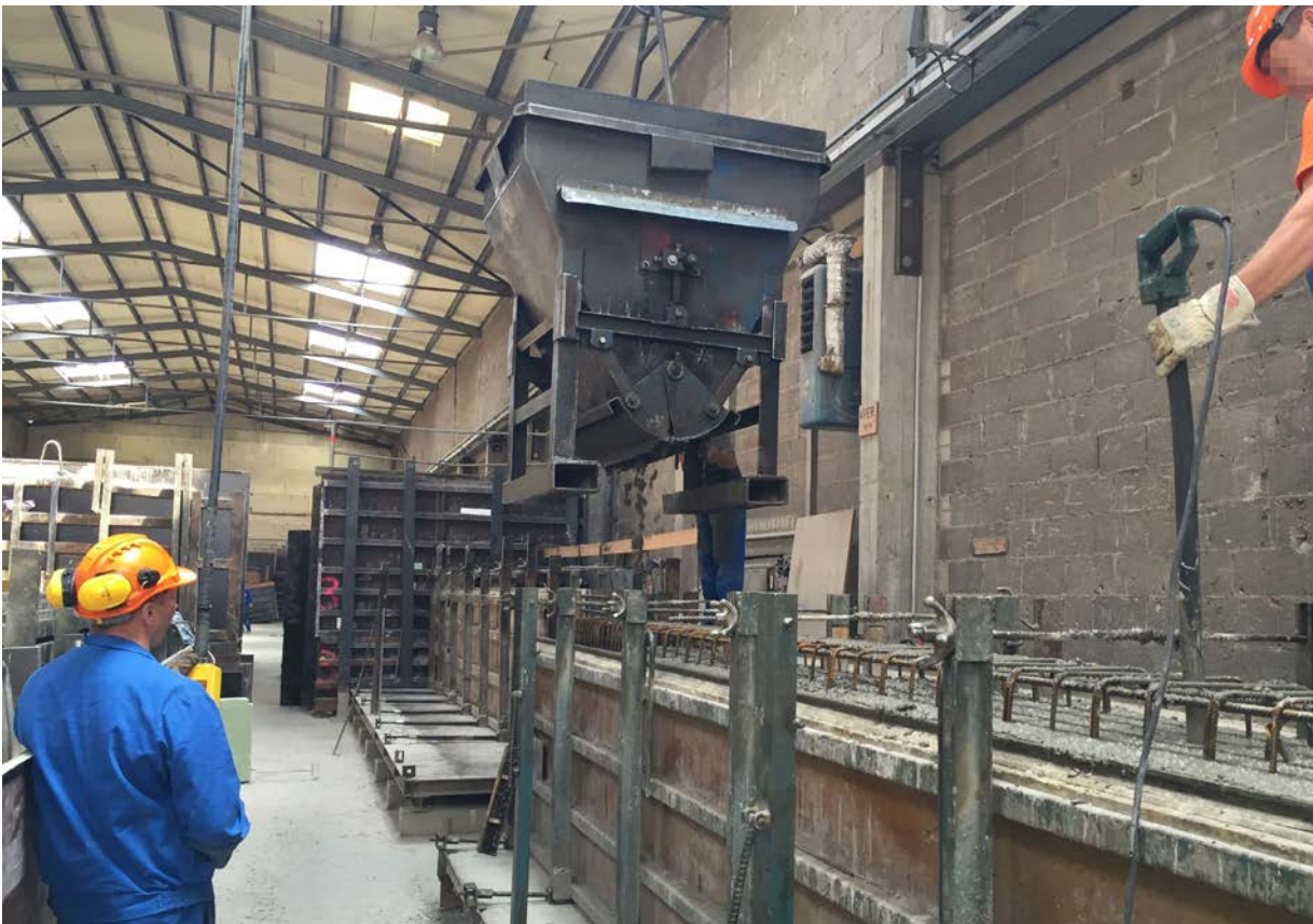
Abb. 31 Verdichtungsarbeiten mit Innenrüttler
