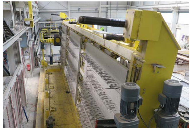
Abb. 15 Verfahren 2 – Wenden mittels Vakuumwenderahmen
