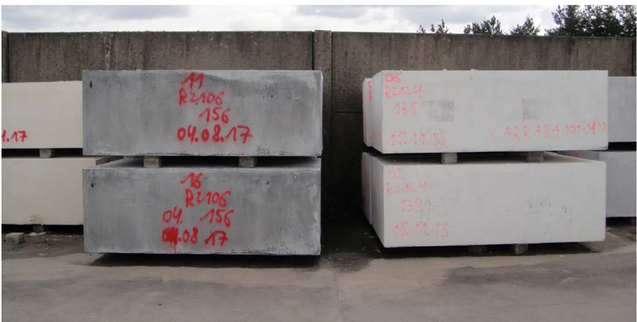
Abb. 97 Betonblocklager für die Herstellung von Betonwerksteinprodukten
