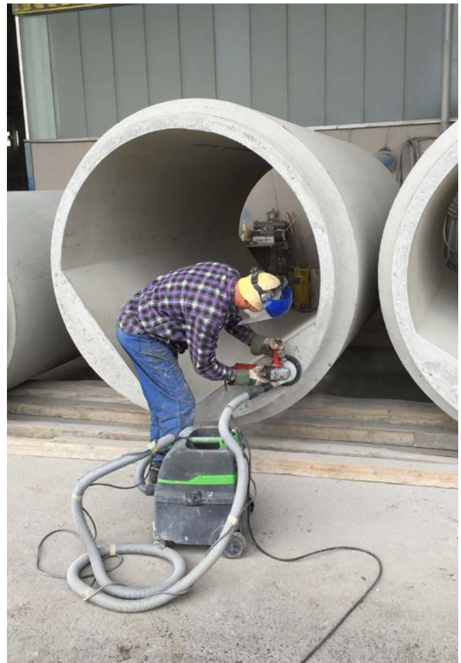
Abb. 51 Nachbearbeitung mit einem Winkelschleifer und Absaugung
