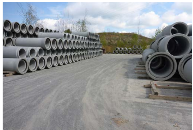
Abb. 108 Freilager-Wegrollsicherung durch Kanthölzer
