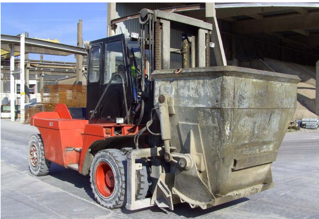
Abb. 103 Gabelstapler mit Transportkübel
