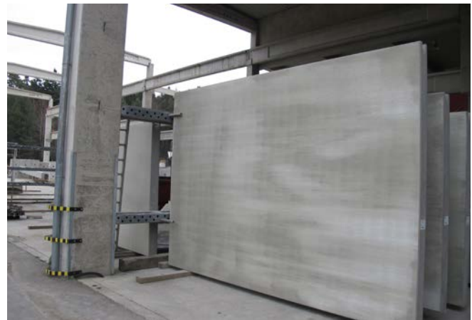
Abb. 110 sichere Lagerung von flächigen Betonfertigteilen
