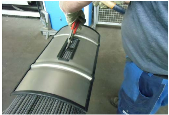
Abb. 42 Einrichtung zum sicheren Aufschneiden eines Stabstahlgebündes
