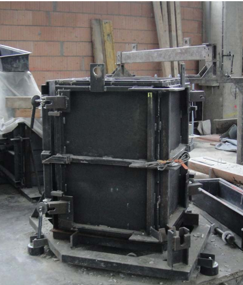
Abb. 94 Schalung für Betonsonderteil
