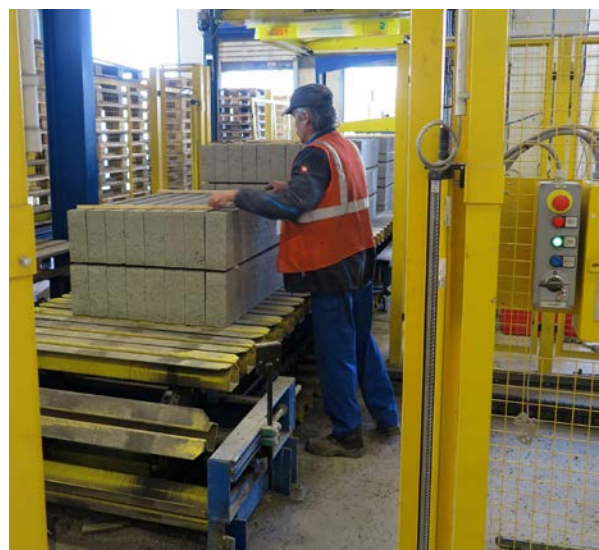
Abb. 64 Bereichsabsicherung mit Anmeldung für das Einlegen von Leisten
