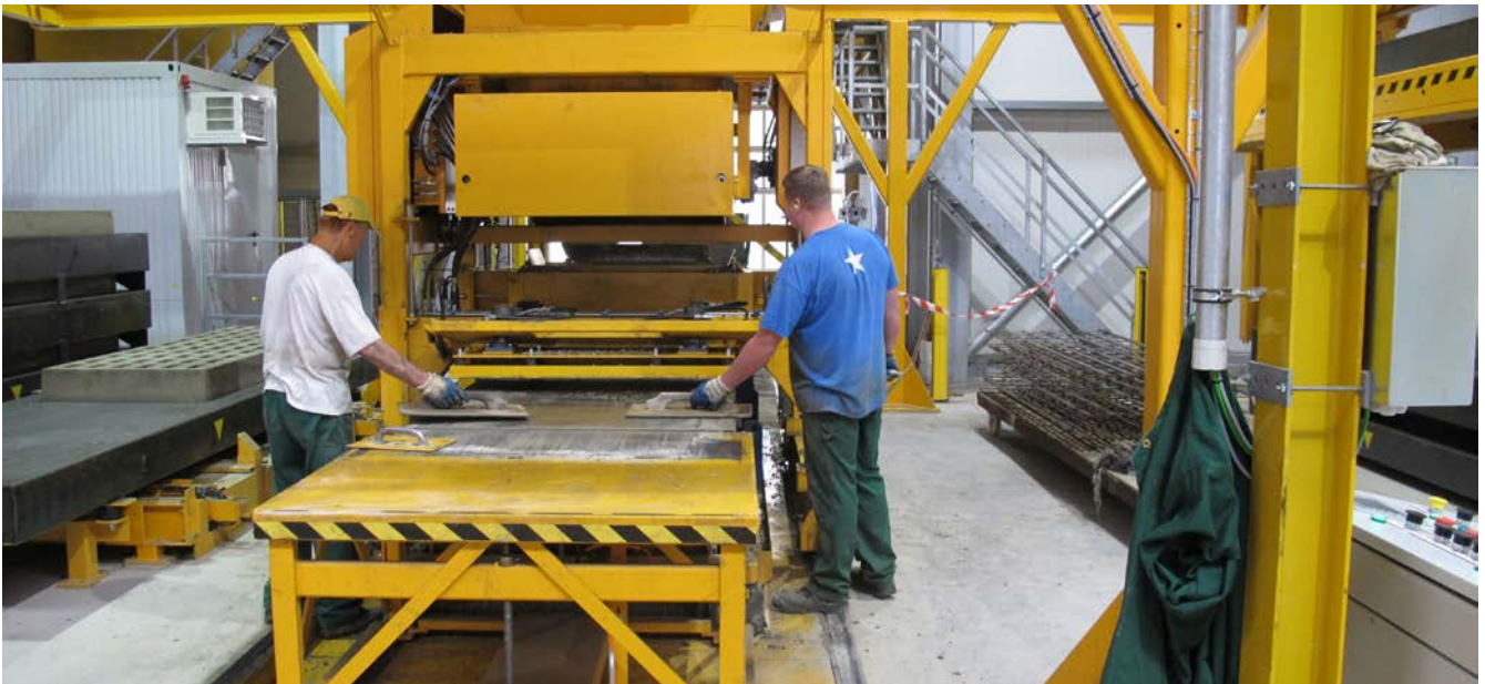
Abb. 99 manuelles Glätten der Spaltenböden
