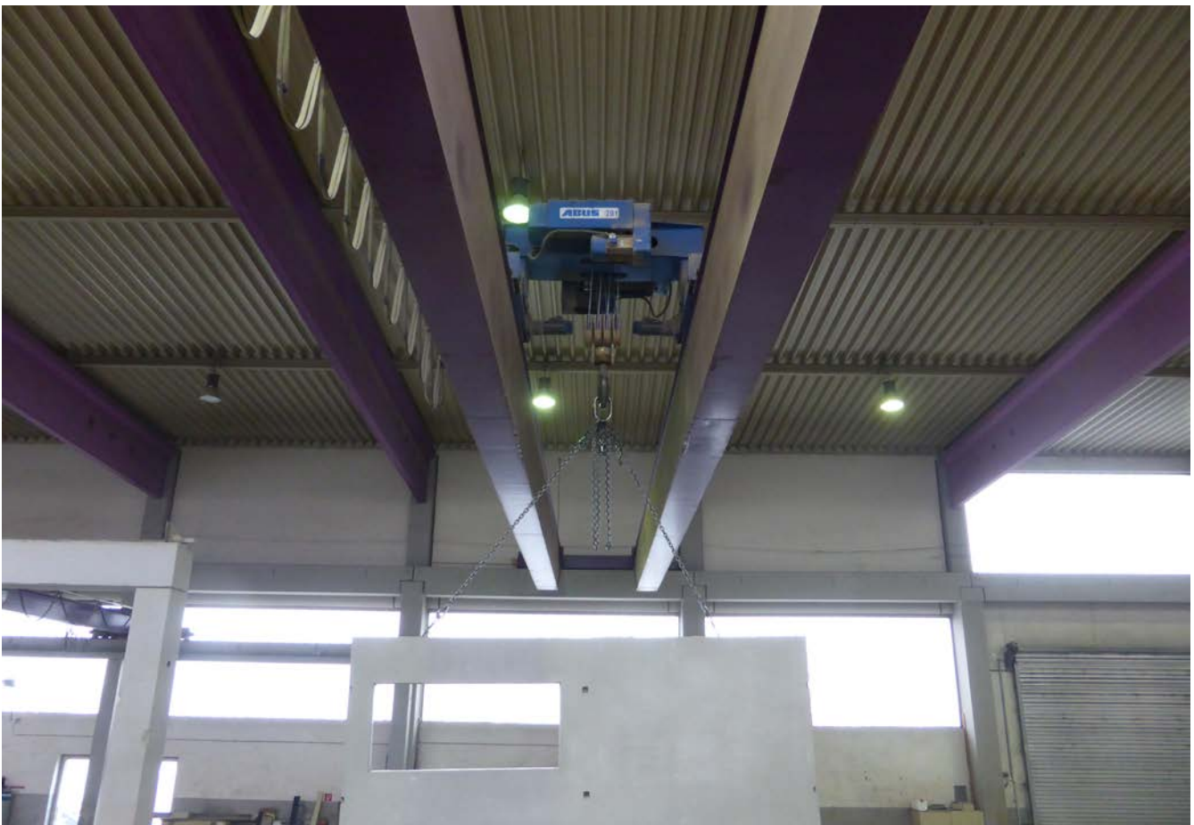
Abb. 105 Transport eines Doppelwandelementes mit Hallenkran
