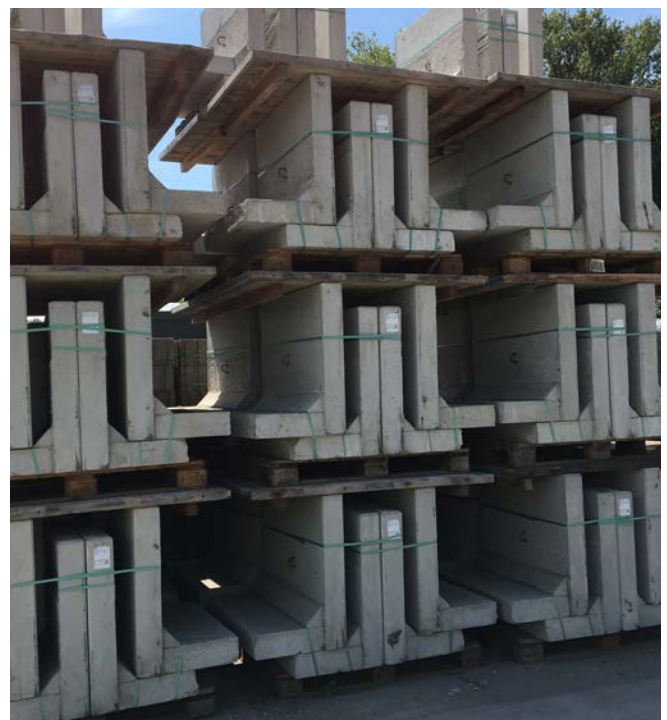
Abb. 112 Lagerung von Winkelstützen
