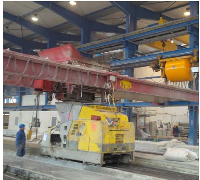
Abb. 38 Betonverteiler für Spannbetonbahn
