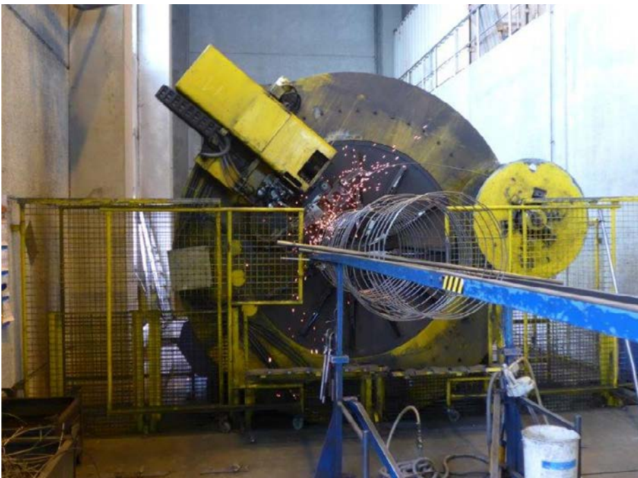
Abb. 40 Schweißautomat für die Bewehrungskörbe
