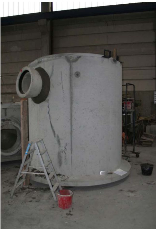
Abb. 55 Rohransatzstück mit Abstützung
