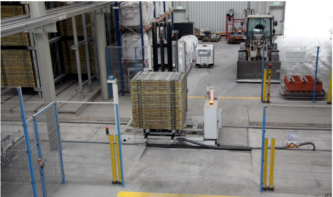
Abb. 67 abgesicherter Kreuzungsbereich beim Transport von Brettstapeln
