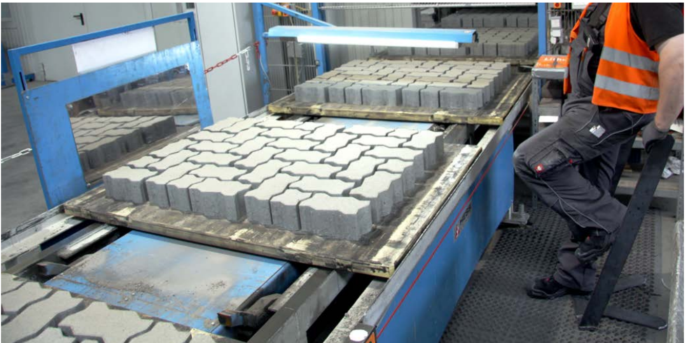
Abb. 61 Ergonomisch gestalteter Sortierarbeitsplatz
