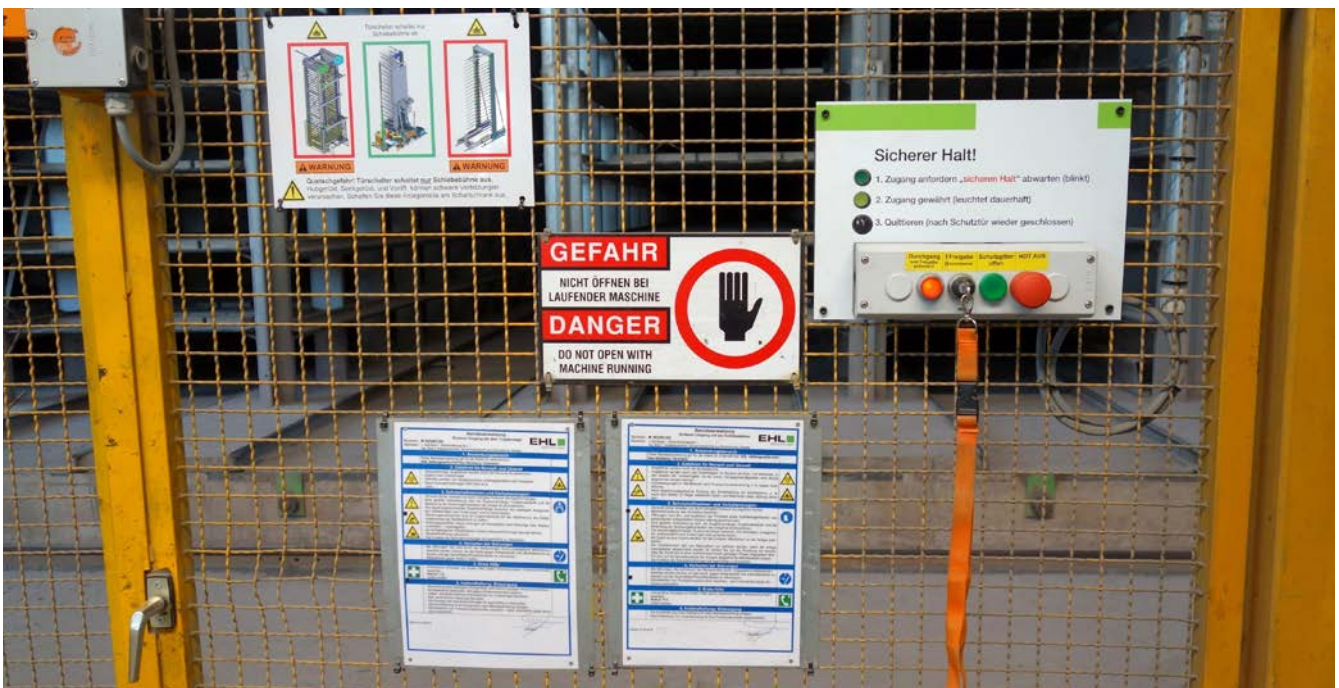
Abb. 57 Zugang zum Gefahrenbereich mit Zuhaltung und Sicherheitshinweisen
