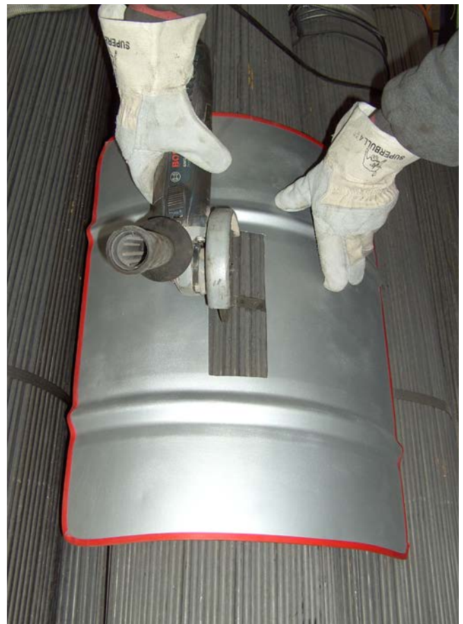
Abb. 26 sicheres Öffnen der Umreifungsbänder
