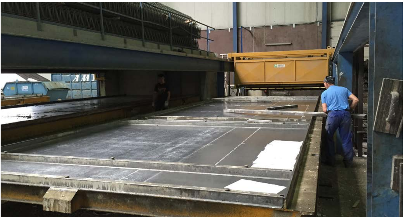
Abb. 7 Belegen der geplotteten Paletten
