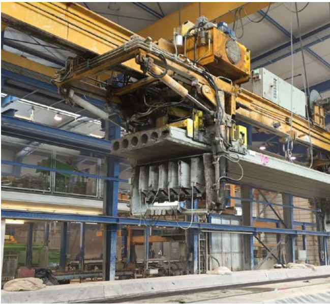
Abb. 37 automatisches Bohren der Entwässerungslöcher
