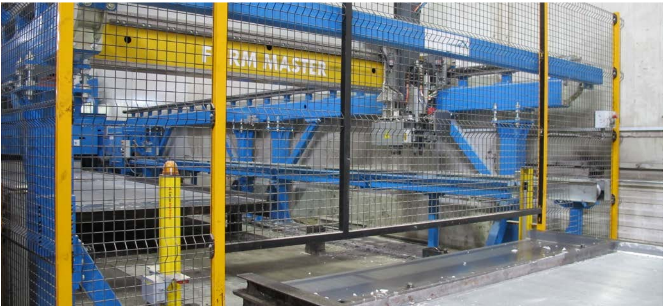
Abb. 19 abgesicherter automatischer Betrieb
