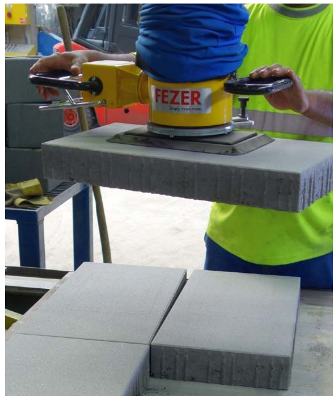
Abb. 62 Einsatz von Hebehilfen
