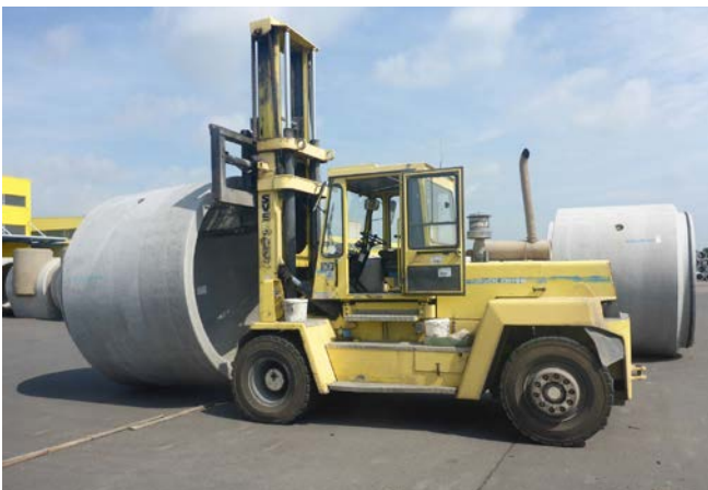
Abb. 107 Stapler mit großformatigem Rohr
