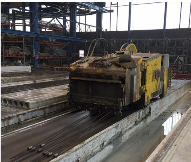
Abb. 35 Universalwagen beim Ausziehen der Spannritzten
