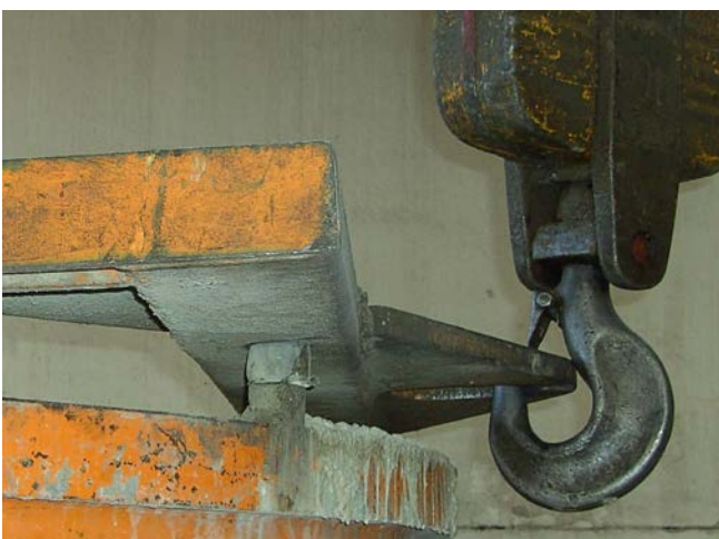
Abb. 106 Kranhaken mit Sicherung
