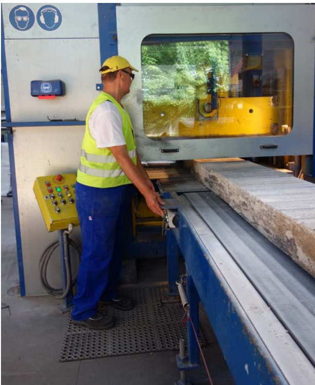
Abb. 69 Zweihandbedienung einer Spaltanlage
