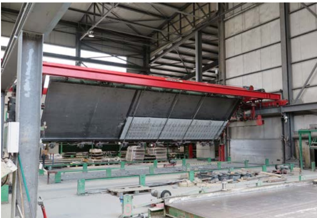
Abb. 14 Verfahren 1 – Wenden der gesamten belegten Palette
