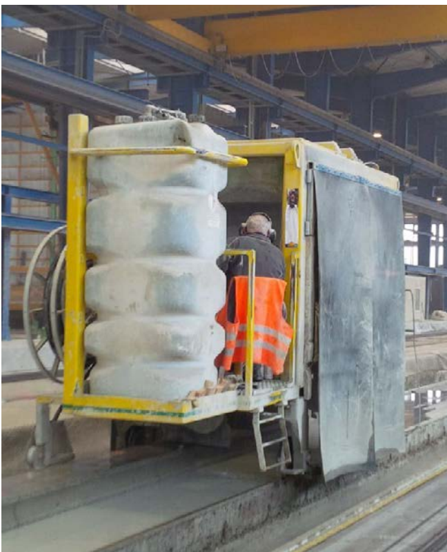
Abb. 39 Säge für Spannbetonbahn
