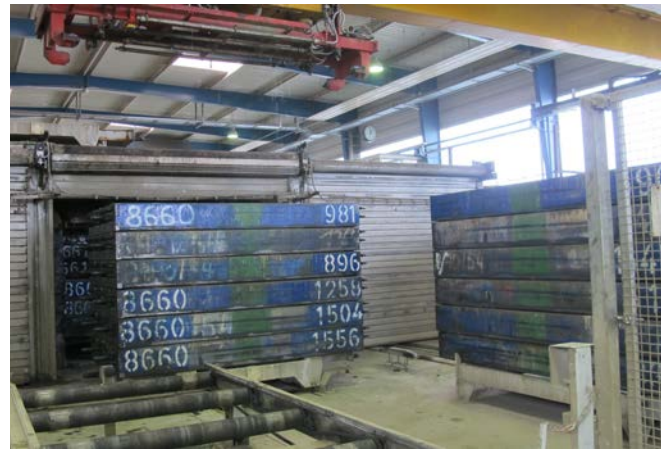
Abb. 77 Verschieben der Schalungen in die Härtekammer
