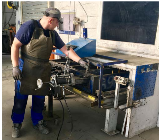
Abb. 75 Spannstahlmessung mit Schutzschürze und Prallwand
