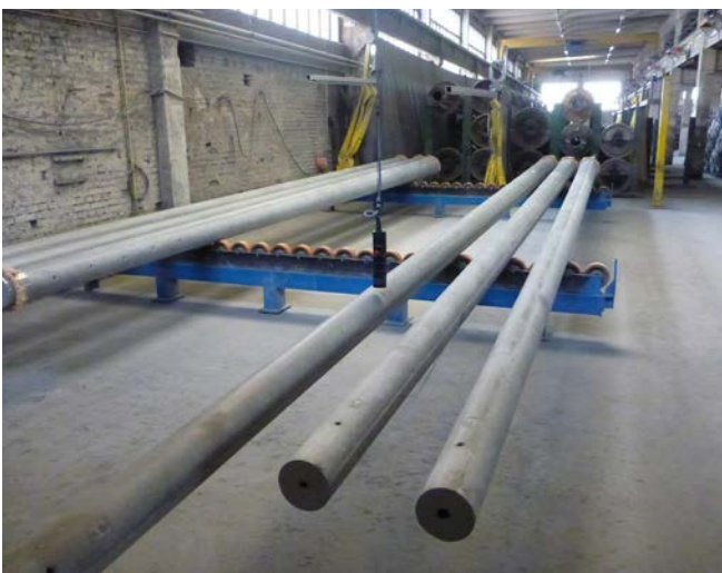
Abb. 93 sichere Lagerung von Schleuderbetonfertigteilen
