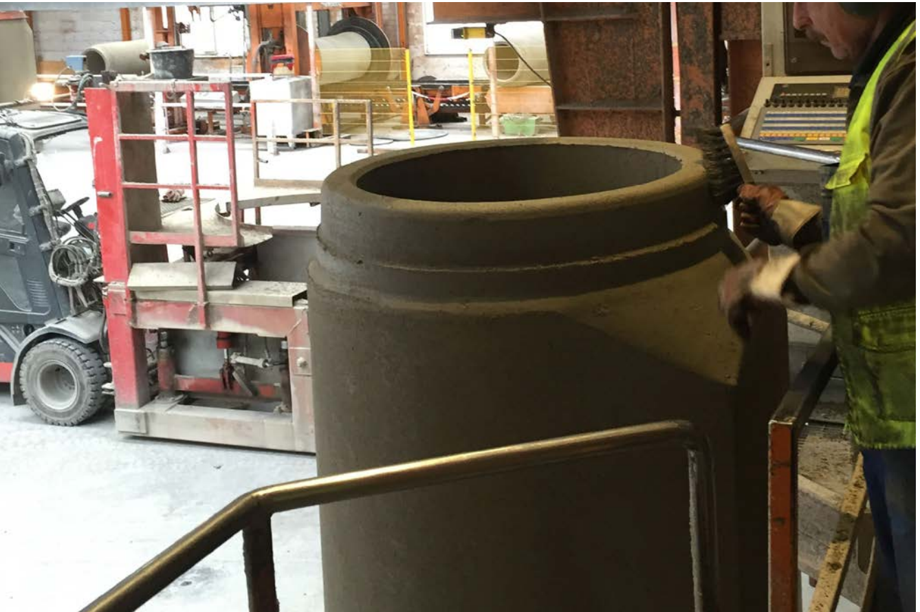
Abb. 50 Nacharbeit der Spitzenden der frisch geformten Rohre
