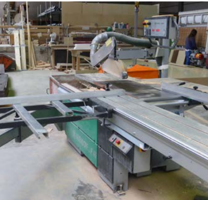
Abb. 21 Kreissäge für den Schalungsbau
