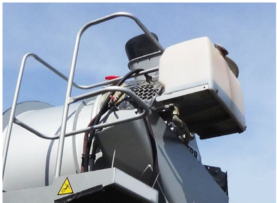
Abb. 12 Zusatzmittelbehälter an Fahrmischer
