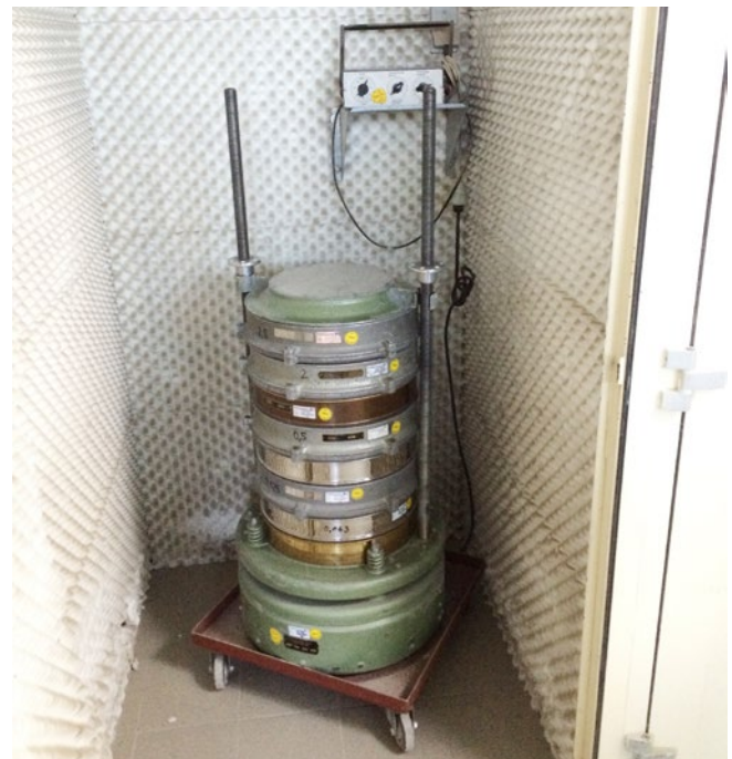
Abb. 55 Labor Siebmaschine im Schallschutzschrank
