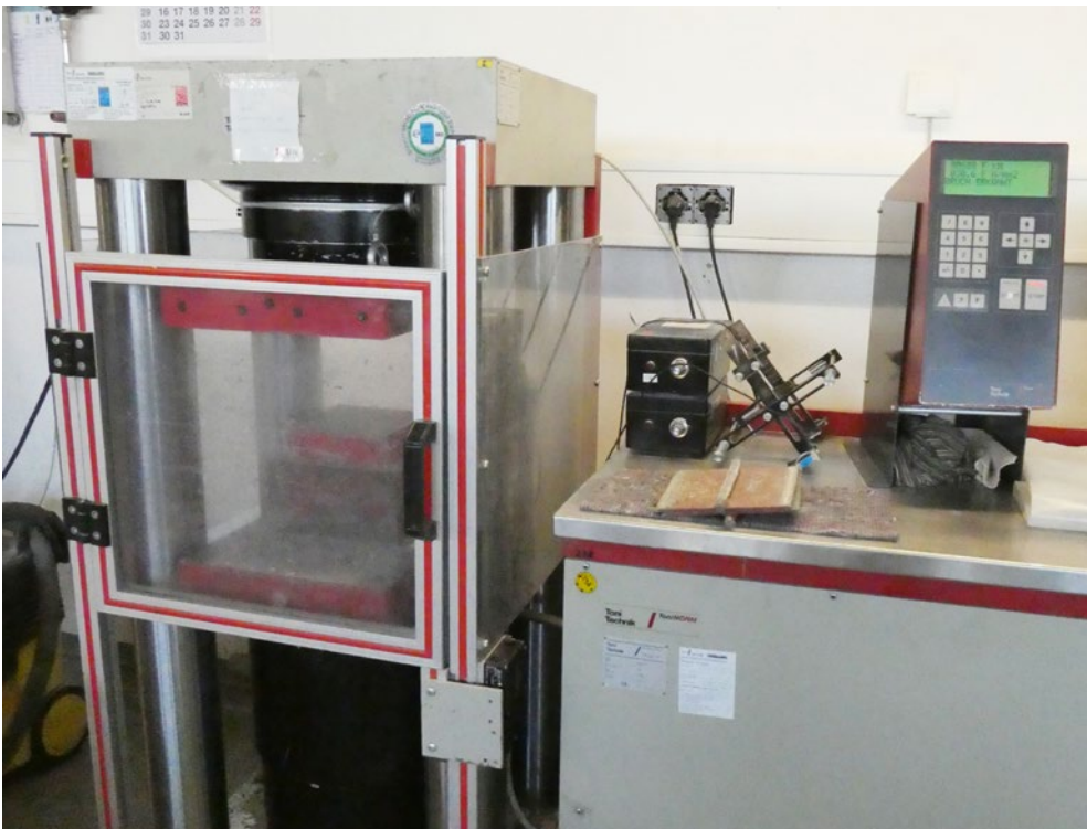
Abb. 60 Prüfpresse mit Splitterschutz
