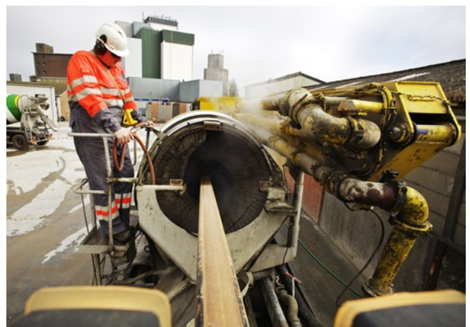
Abb. 48 Hochdruckwasserstrahlsysteme zur Fahrmischertrommel-Reinigung
