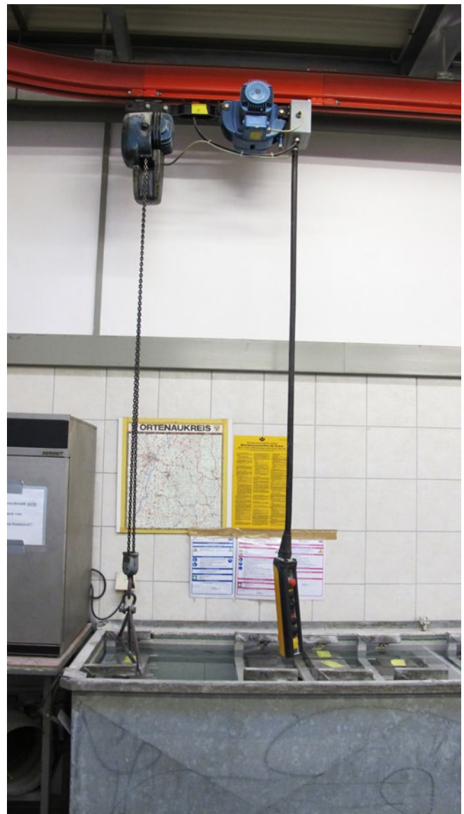
Abb. 58 Hebehilfe für schwere Probekörper
