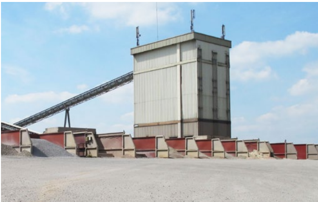
Abb. 3 Frischbetonanlage mit Materialboxen
