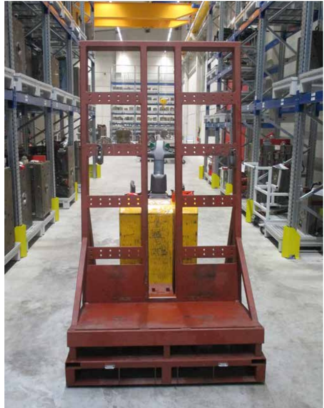
Abb. 46 Geeignete Transportvorrichtung für Spritzgießwerkzeug
