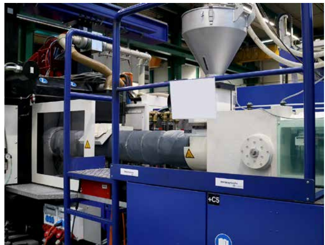
Abb. 14 Best Practice für eine Aufstiegshilfe und Absturz-sicherung an einer Spritzgießmaschine. Bitte beachten Sie: Der Transport von Werkzeugen oder anderen Gegenständen darf die sichere Nutzung von Steigleitern einschließlich Persönlicher Schutzausrüstungen gegen Absturz nicht beeinträchtigen.
