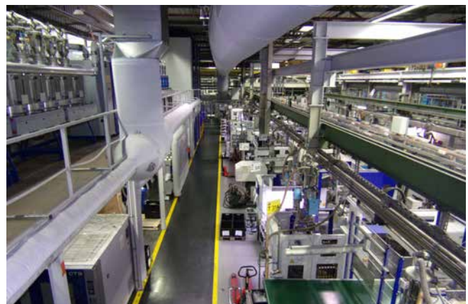
Abb. 43 Gut gekennzeichnete Verkehrsweg in einem Spritzgießbetrieb
