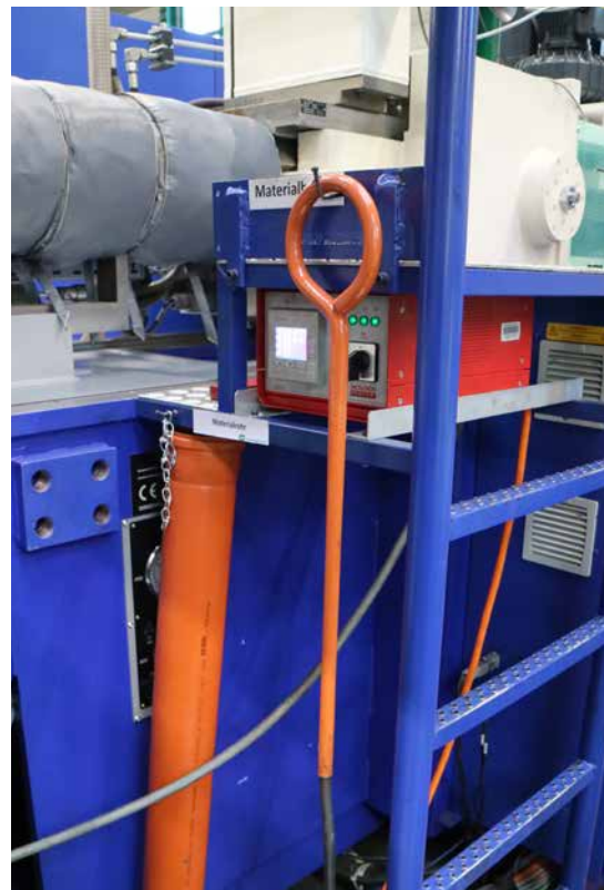
Abb. 48 Beispiel für einen Fladenhaken
