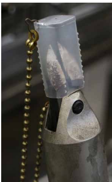
Abb. 5 Automatische Angusschere mit Schutzhülle zur Vermeidung von Schnittverletzungen
