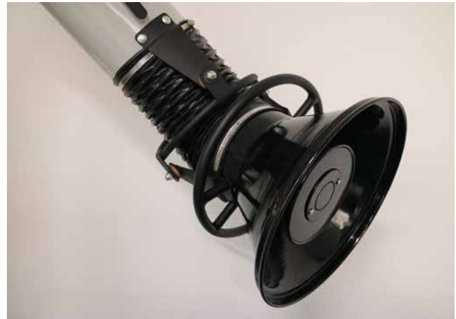
Abb. 27 Best Practice für eine flexible Erfassungseinrichtung für Gase und Dämpfe
