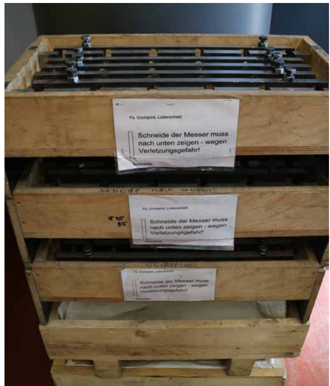
Abb. 77 Transportbehälter für Mühlenmesser zur Vermeidung von Schnittverletzungen
