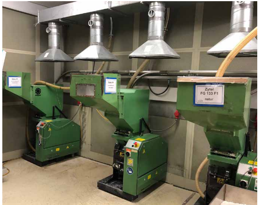
Abb. 74 Mühlen mit Absaugung
