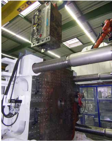
Abb. 12 Arbeitsbereich einer Spritzgieß- maschine bei Ein- bau des Werkzeugs
