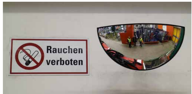
Abb. 16 Best Practice Beispiel zur Installation eines Spiegels an einem unübersichtlichen Verkehrsweg
