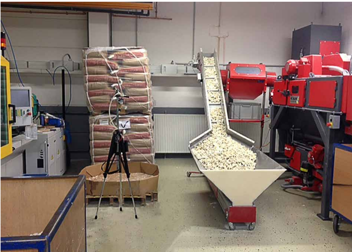
Abb. 85 Materialversorgung und automatische Formteilentgratung bei Duroplast-Spritzgießmaschinen
