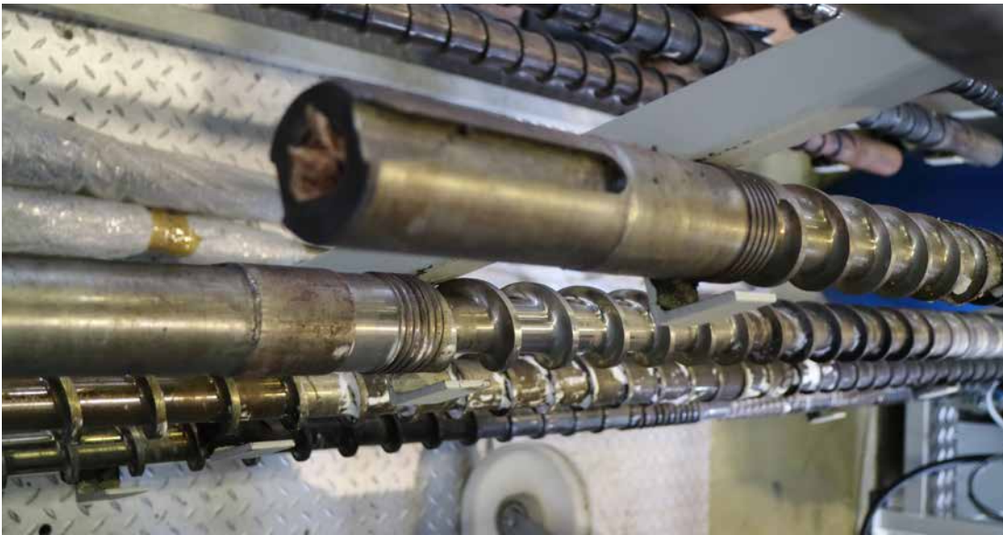
Abb. 51 Sichere und schonende Zwischenlagerung von Plastifizierschnecken
