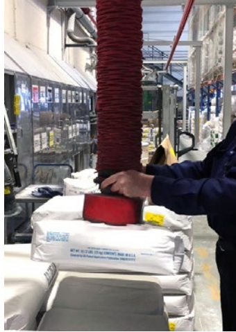
Abb. 7 Vakuümheber zum Umsetzen von Säcken
