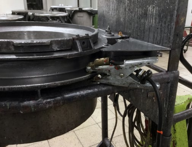
Abb. 62 Erdungszange und Überwachungseinrichtung
