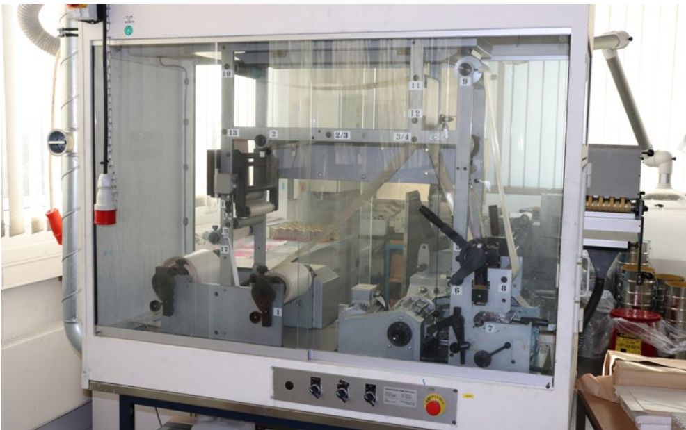
Abb. 29 Labordruckmaschine mit Einhausung und Schiebetüren
