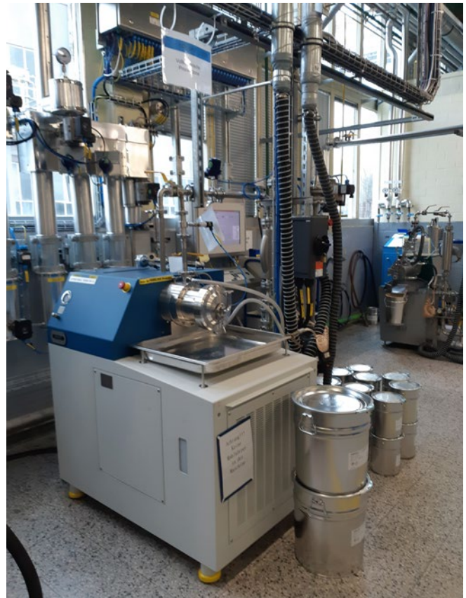
Abb. 19 Rührwerksmühle im Technikumsmaßstab
