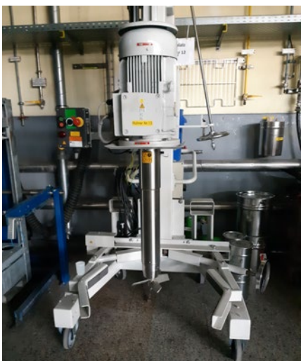
Abb. 12 Rührwerk mit teleskopartigem Rührwellenschutz
