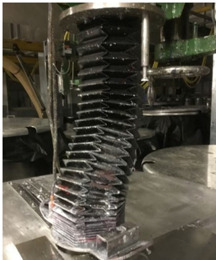
Abb. 10 Wellenschutz eines Rührwerks durch einen Faltenbalg
