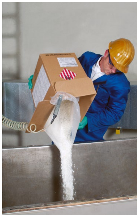
Abb. 60 Korrekte Entleerung von Nitrocellulose-Gebinden; Folieninliner sind ableitfähig ausgelegt
