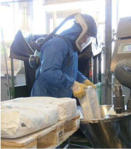
Abb. 6 Produktionsanlage mit Sackschütte
