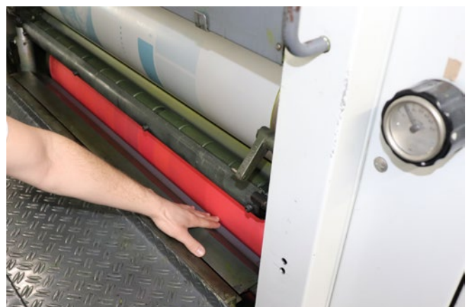
Abb. 31 Fingerschutzabdeckung an Druckwalze
