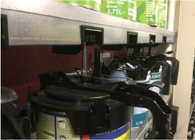
Abb. 15 Rührregale für Kleingebinde mit Wellenschutz
