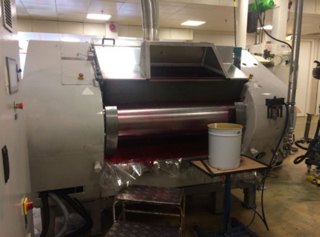
Abb. 21 Dreiwalze mit Schutzhaube und Verriegelung
