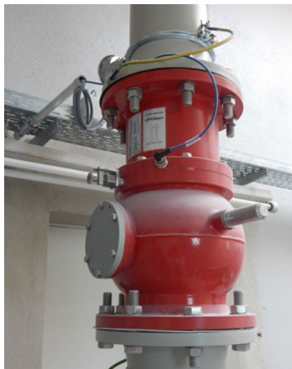
Abb. 59 Explosionssicherungsventil an druckstoßfest ausgelegter Mühle
