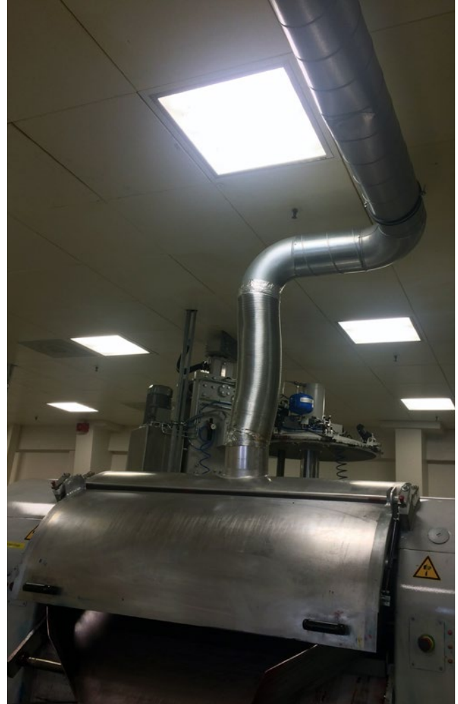
Abb. 23 Vollständig abgedeckter Dreiwalzenstuhl mit Absaugung
