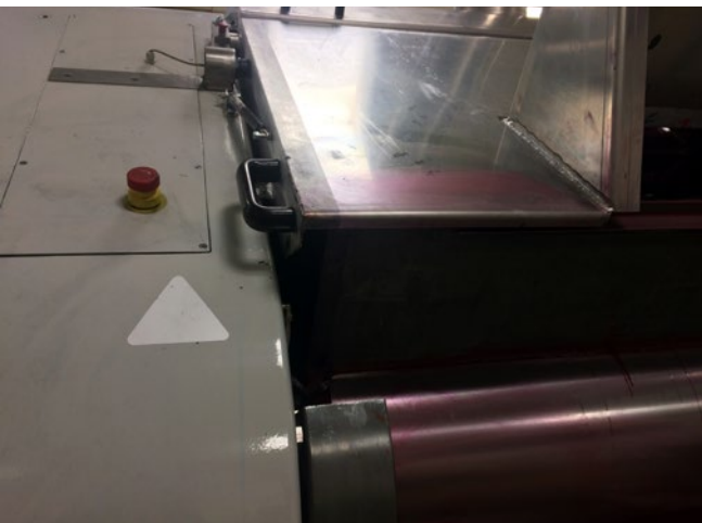
Abb. 22 Verriegelung der Schutzhaube an der Dreiwalze
