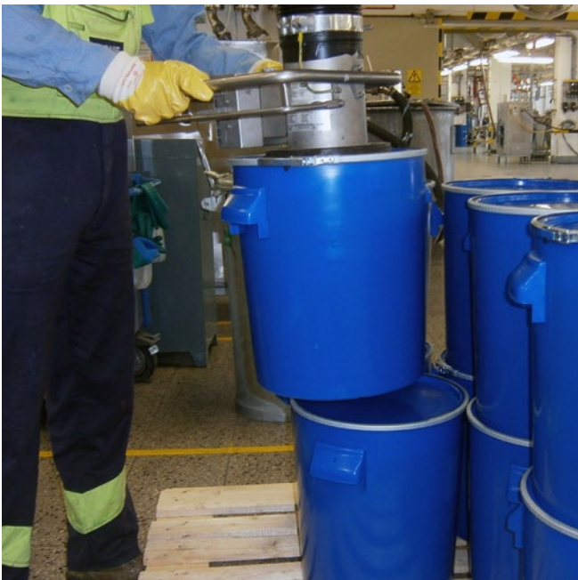
Abb. 34 Vakuümheber für die Handhabung von Hobbocks
