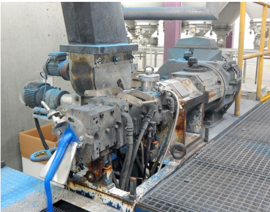
Abb. 55 Extrusionsanlage zur Herstellung von Pulverlacken
