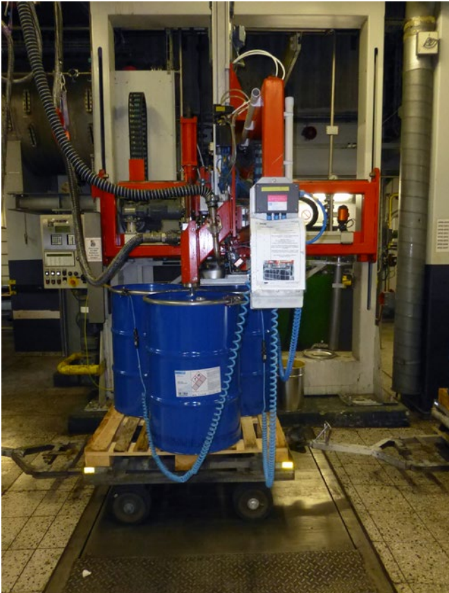
Abb. 38 Fassabfüllung mit Erdungsüberwachung
