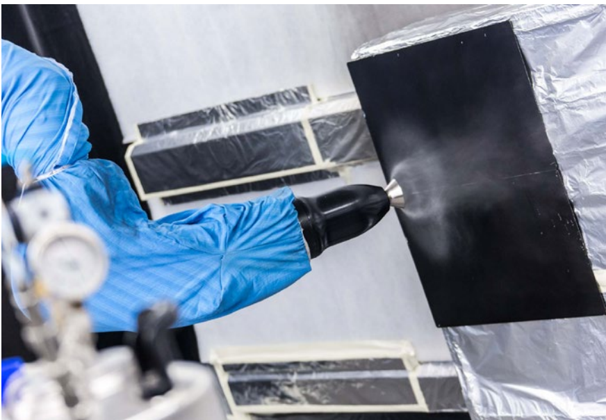
Abb. 28 Lackierroboter zur Beschichtung von Mustern
