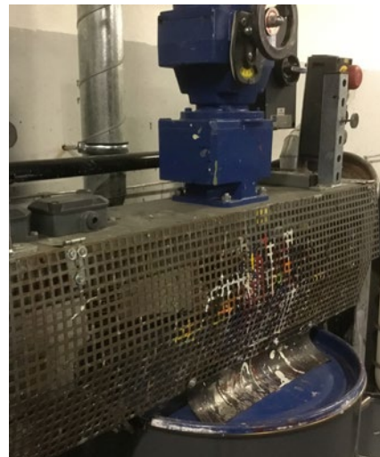
Abb. 11 Wellenschutz eines kleinen Rührwerks
