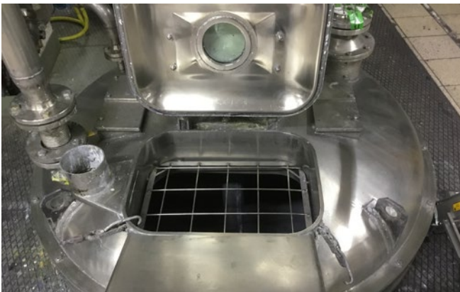
Abb. 4 Schutzgitter an der Einfüllöffnung eines Behälters
