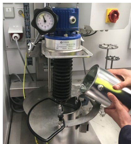
Abb. 17 Laborrührwerk (< 1500 Watt) mit Faltenbalg, Behälter ist gegen Mitdrehen gesichert (mit Antrieb verriegelt)
