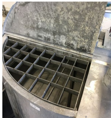
Abb. 54 Reaktionsbehälter mit Schutzgitter an Einfüllöffnung und Absaugung
