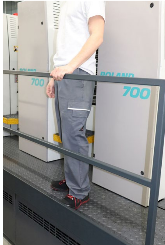
Abb. 30 Abnehmbares Geländer an der Arbeitsplattform einer Druckmaschine
