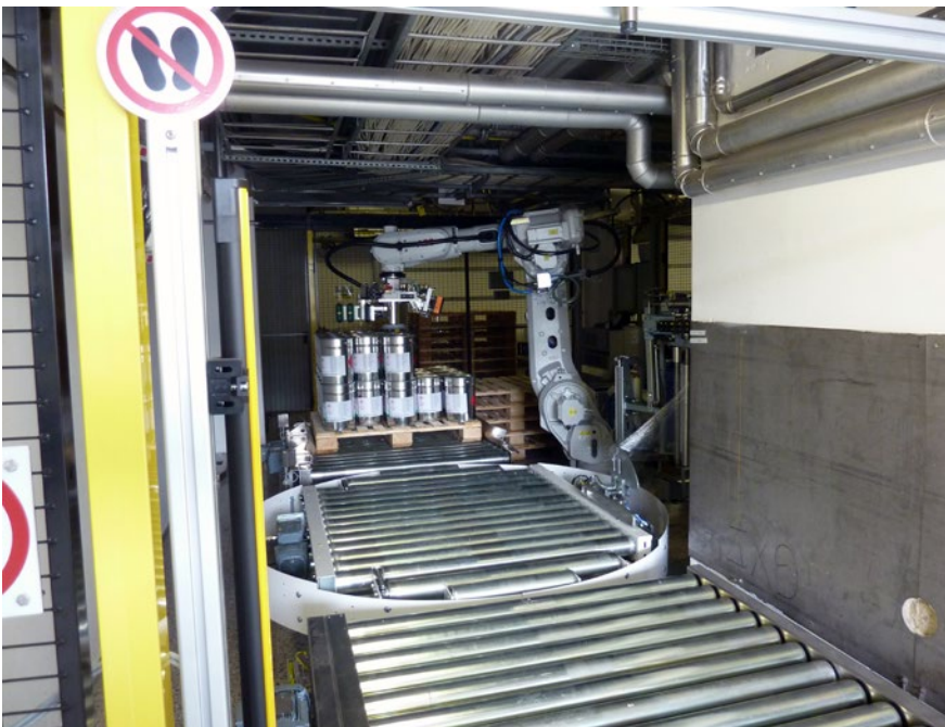
Abb. 41 Palettierroboter mit Sicherheitslichtschranke
