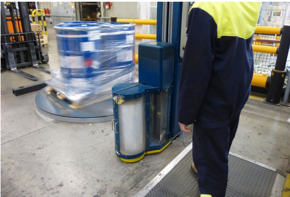
Abb. 40 Halbautomatische Wickelmaschine (Verpackungsmaschine) mit Trittmatte
