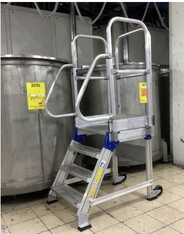
Abb. 47 Aufstiegshilfe mit ableitfähigen Rollen und Standfüßen
