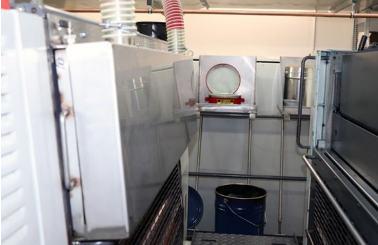
Abb. 32 Aerosolabsaugung an Druckwalze, darunter Gitter als Berührungsschutz
