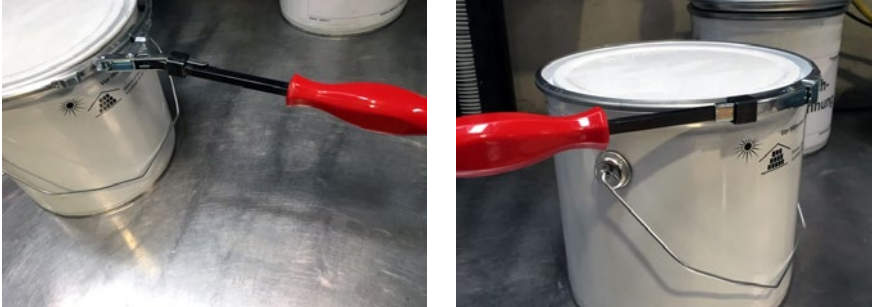
Abb. 33 Werkzeug zum Verschließen von Spannringen
