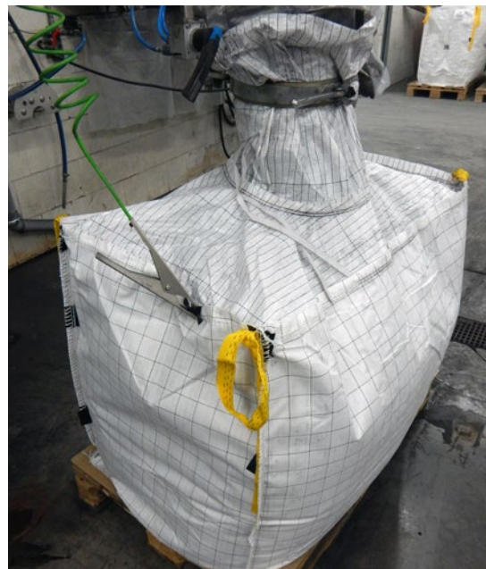
Abb. 63 Ableitfähiger FIBC, Typ C mit Erdung
