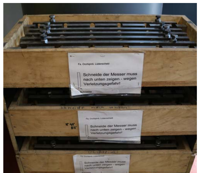
Abb. 75 Transportbehälter für Mühlenmesser zur Vermeidung von Schnittverletzungen
