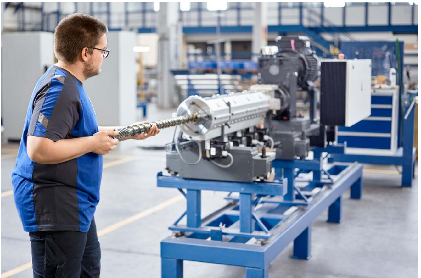
Abb. 58 Schneckenwechsel an einem Extruder
