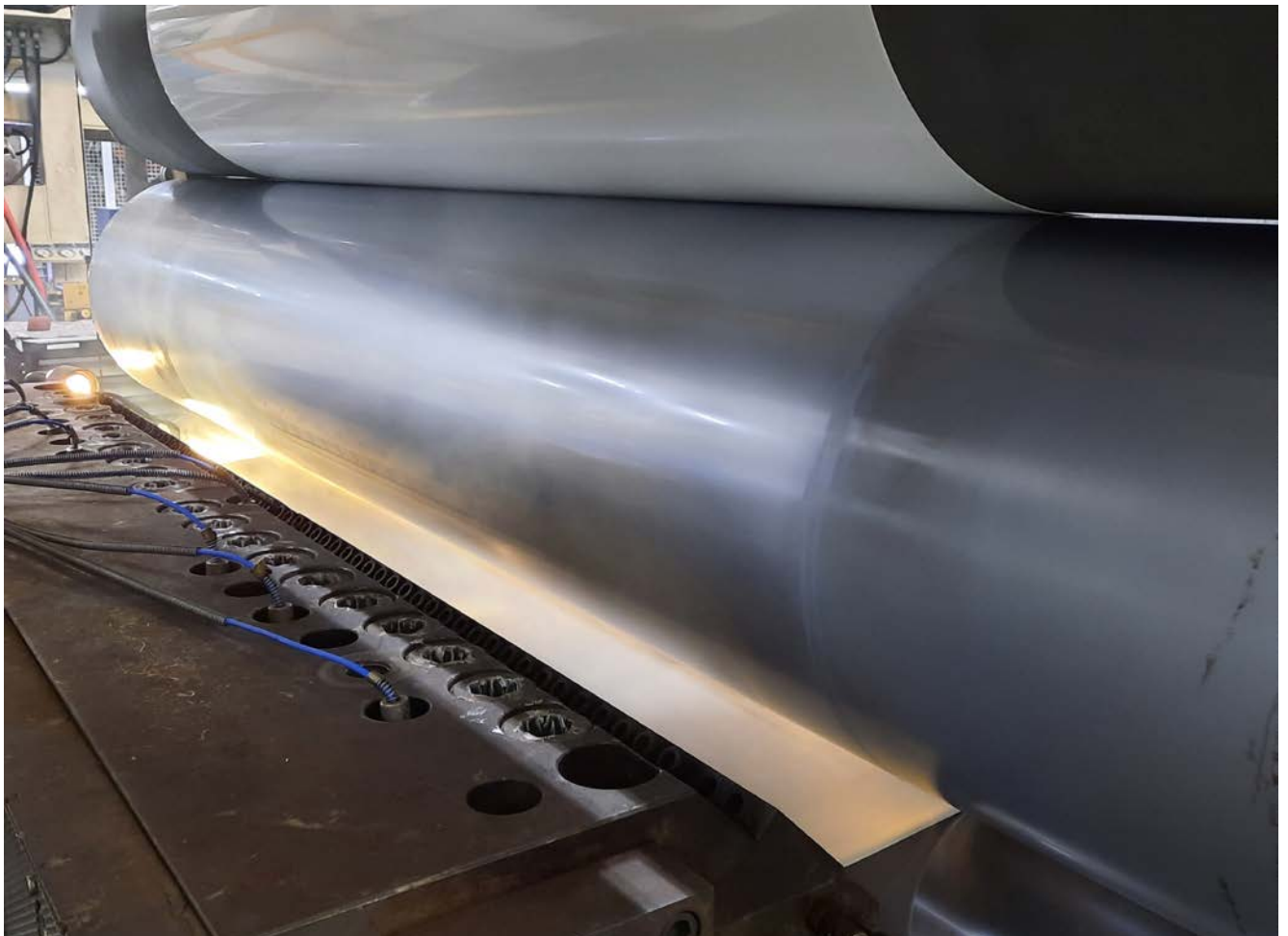
Abb. 47 Einzugsstelle an Kalandern innerhalb einer Schutzeinrichtung
