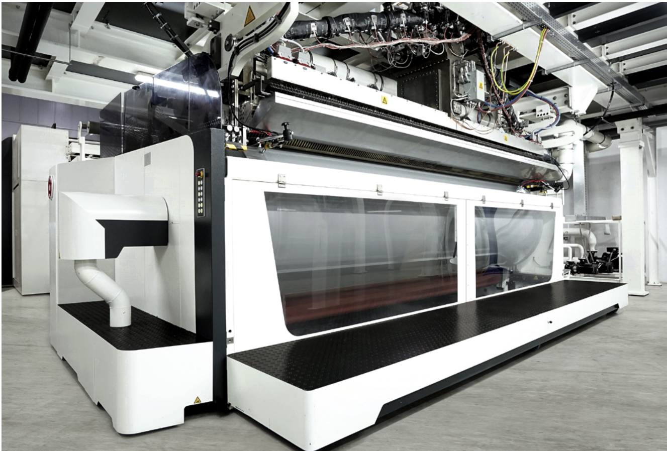
Abb. 82 Chill-Roll-Anlage mit geschlossenen Schutzeinrichtungen
