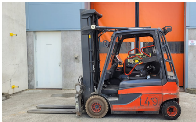
Abb. 20 Gabelstapler mit Bügeltür als Fahrerrückhaltesicherung
