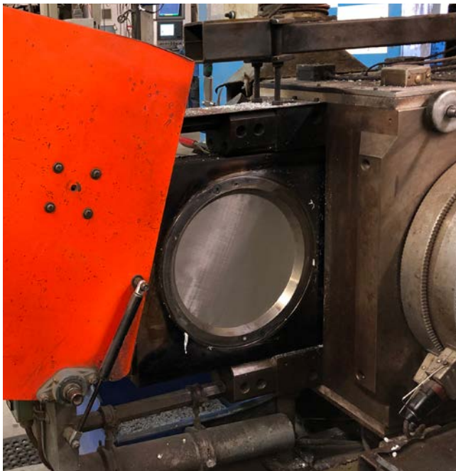
Abb. 52 Siebwechsler an einer Extrusionsanlage
