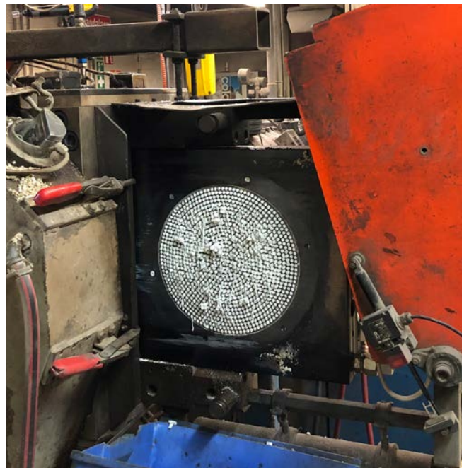
Abb. 53 Beaufschlagtes Sieb mit Rückständen
