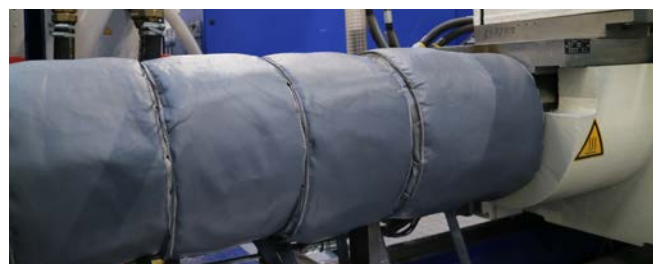
Abb. 8 Gute Praxis für eine Isolation an einer Plastifiziereinheit zur Vermeidung von Verbrennungen
