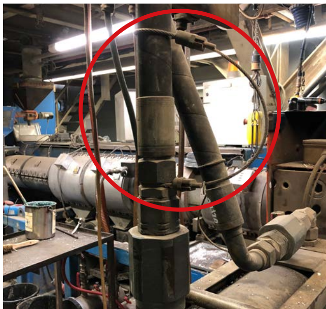
Abb. 54 Fangsicherung an einem Pneumatikschlauch
