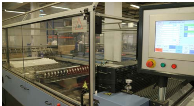
Abb. 39 Mit Verdeckungen nachgerüstete Beutelmaschine
