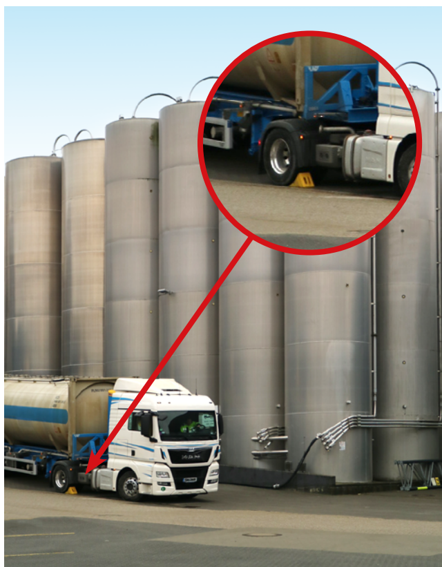
Abb. 69 a+b Sicherung eines LKWs gegen Wegrollen bei der Entladung
