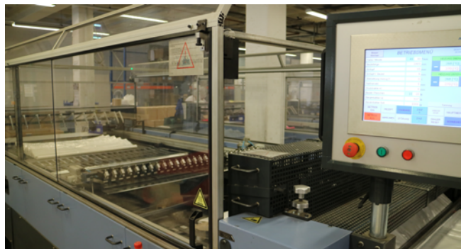
Abb. 39 Mit Verdeckungen nachgerüstete Beutelmaschine
