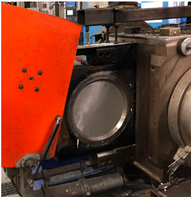
Abb. 52 Siebwechsler an einer Extrusionsanlage
