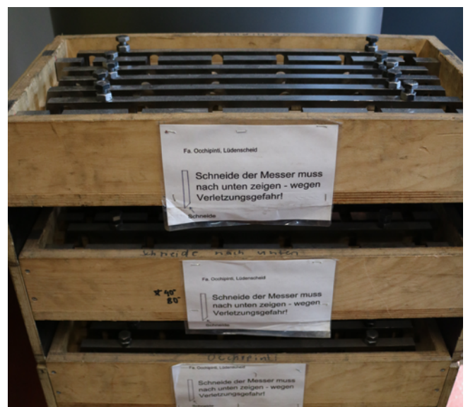
Abb. 75 Transportbehälter für Mühlenmesser zur Vermeidung von Schnittverletzungen
