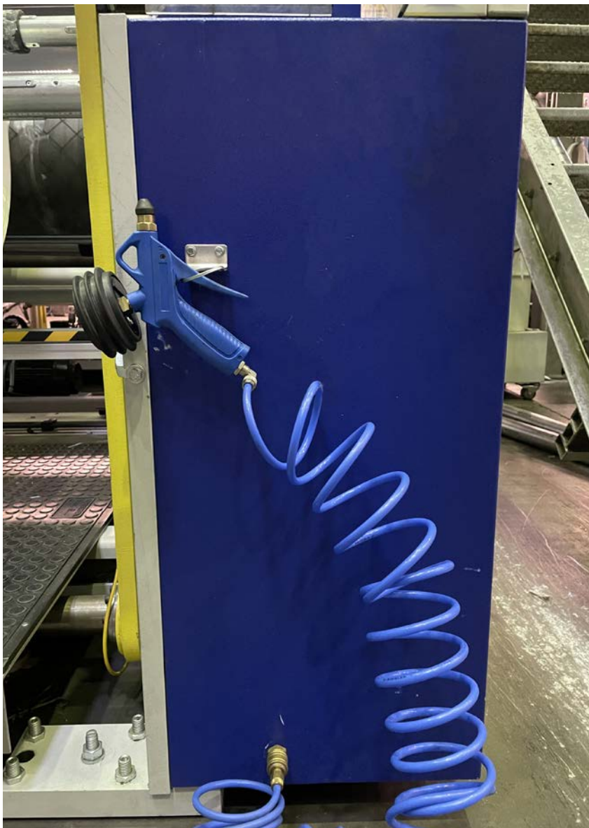
Abb. 28 Druckluft-Einheit zum Fixieren des Kerns auf der Wickelrolle
