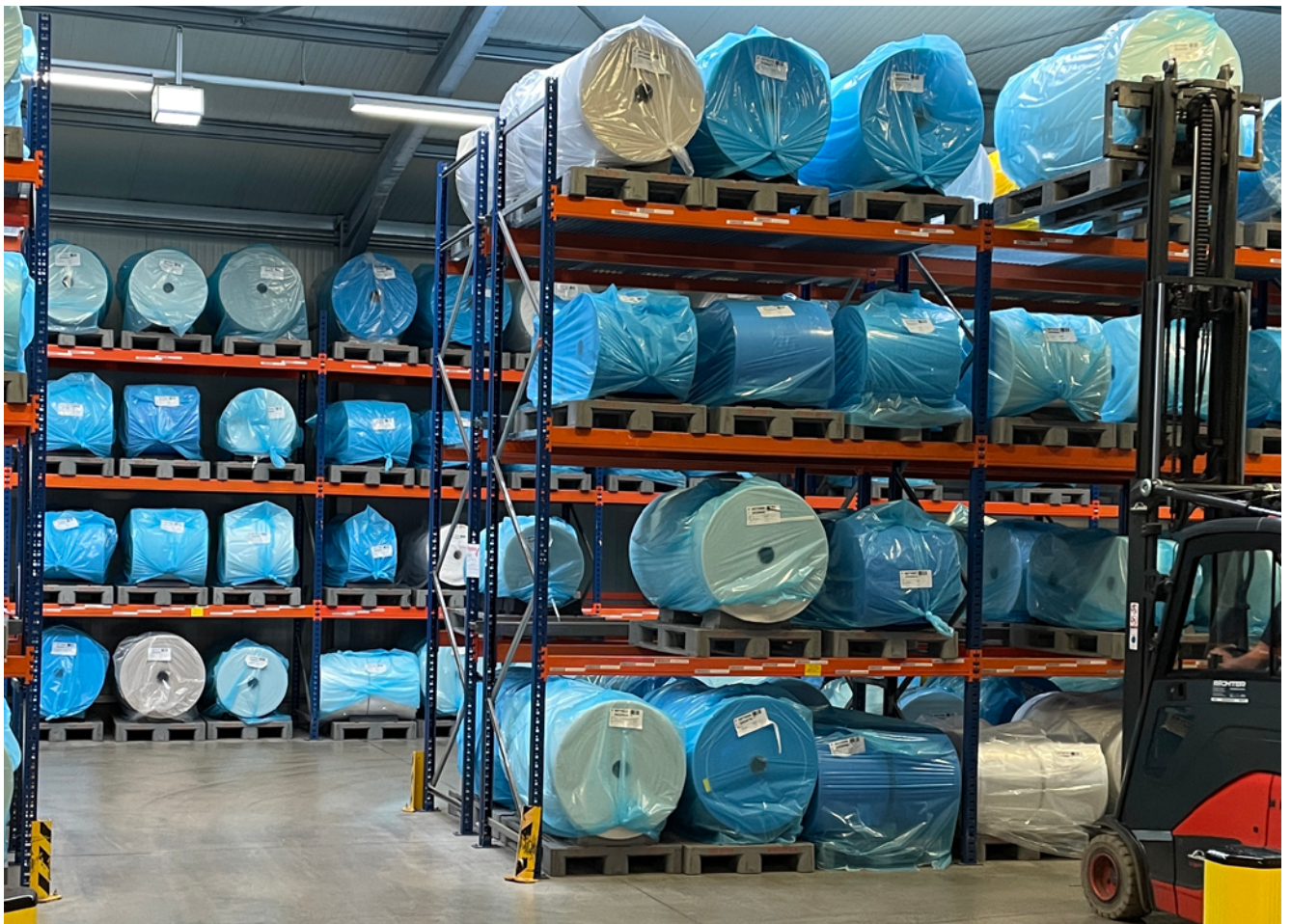
Abb. 3 Regallager für Folienrollen, die Kennzeichnung der Fach- und Feldlasten ist vorhanden, befindet sich allerdings nicht im Bildausschnitt.
