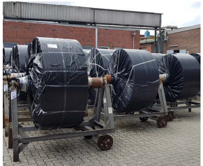
Abb. 77 Sichere Lagerung und innerbetrieblicher Transport von Rollenmaterial
