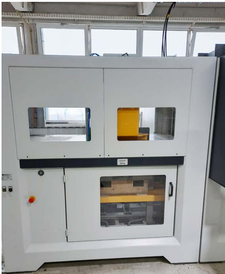
Abb. 80 Mit verriegelten Schutztüren abgesicherte Warmformmaschine
