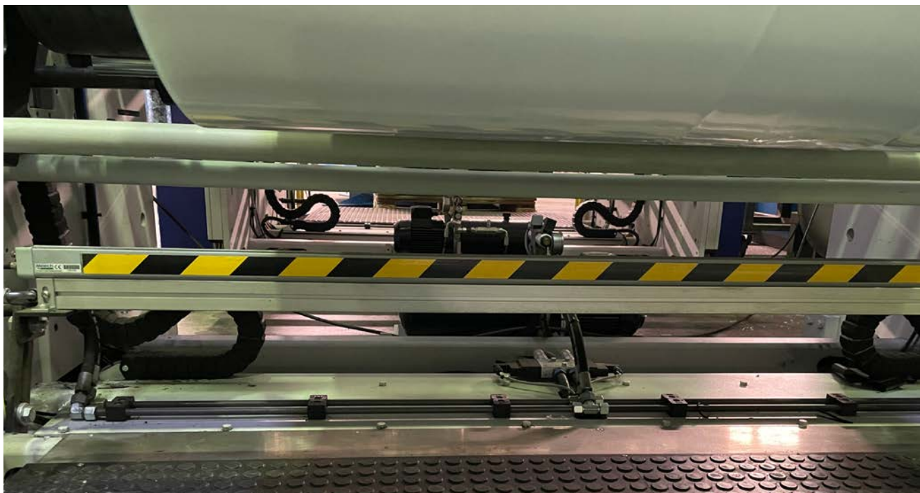
Abb. 26 Die aktive Beseitigung von elektrostatischer Aufladung wird mit Hochspannungsisolationsgeräten durchgeführt. Diese Geräte, im Bild gelb-schwarz markiert, erzeugen positive und/oder negative Ionen, um die elektrostatische Aufladung von dem Produkt zu entfernen.
