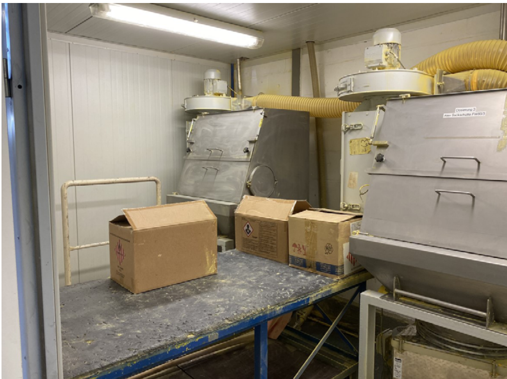
Abb. 81 Separator, mit einer raumlufttechnischen Anlage ausgestatteter Raum zum Abwiegen und Dosieren von pulverförmigen Treibmitteln
