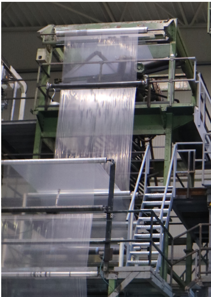
Abb. 14 Treppen, Bühnen und Absturzsicherungen an einer Folienextrusionsanlage
