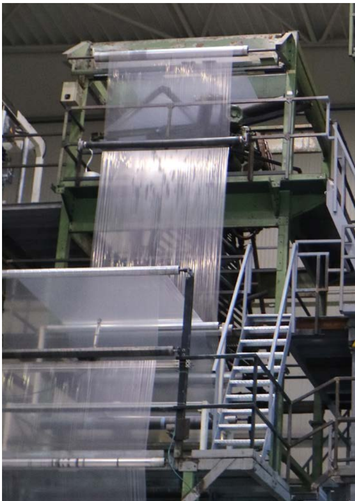
Abb. 14 Treppen, Bühnen und Absturzsicherungen an einer Folienextrusionsanlage
