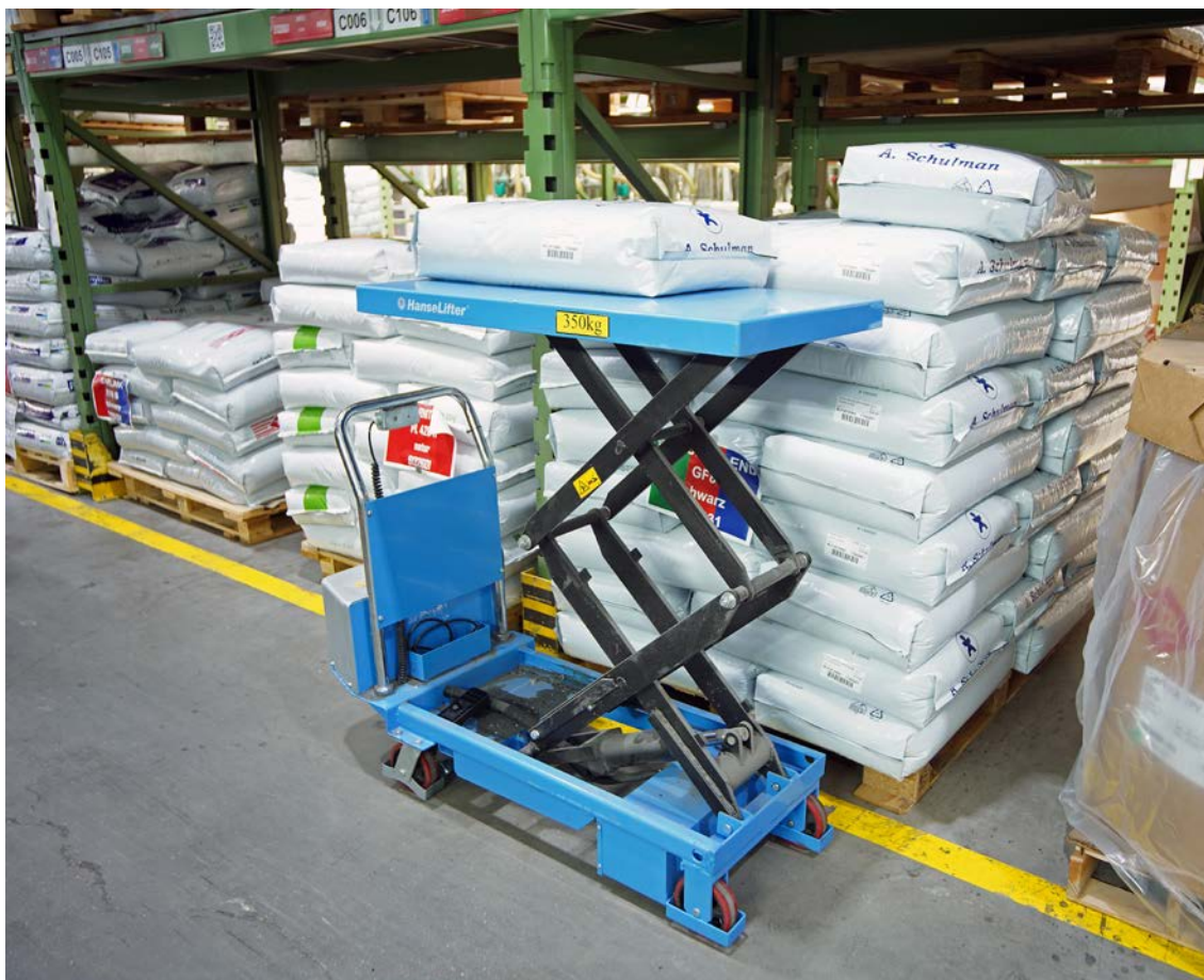
Abb. 35 Ergonomischer Transport und ergonomisches Anheben von Kunststoffsäcken
