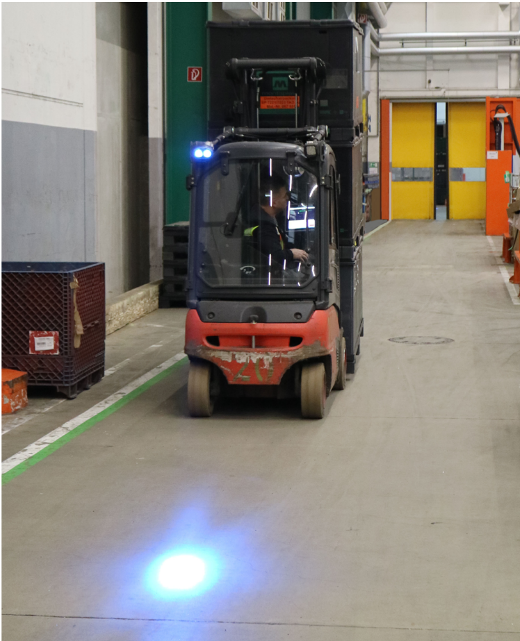
Abb. 19 Erhöhung der Sicherheit von Fußgängerinnen und Fußgängern durch die Verwendung von optischen Warnsignalen an Gabelstaplern
