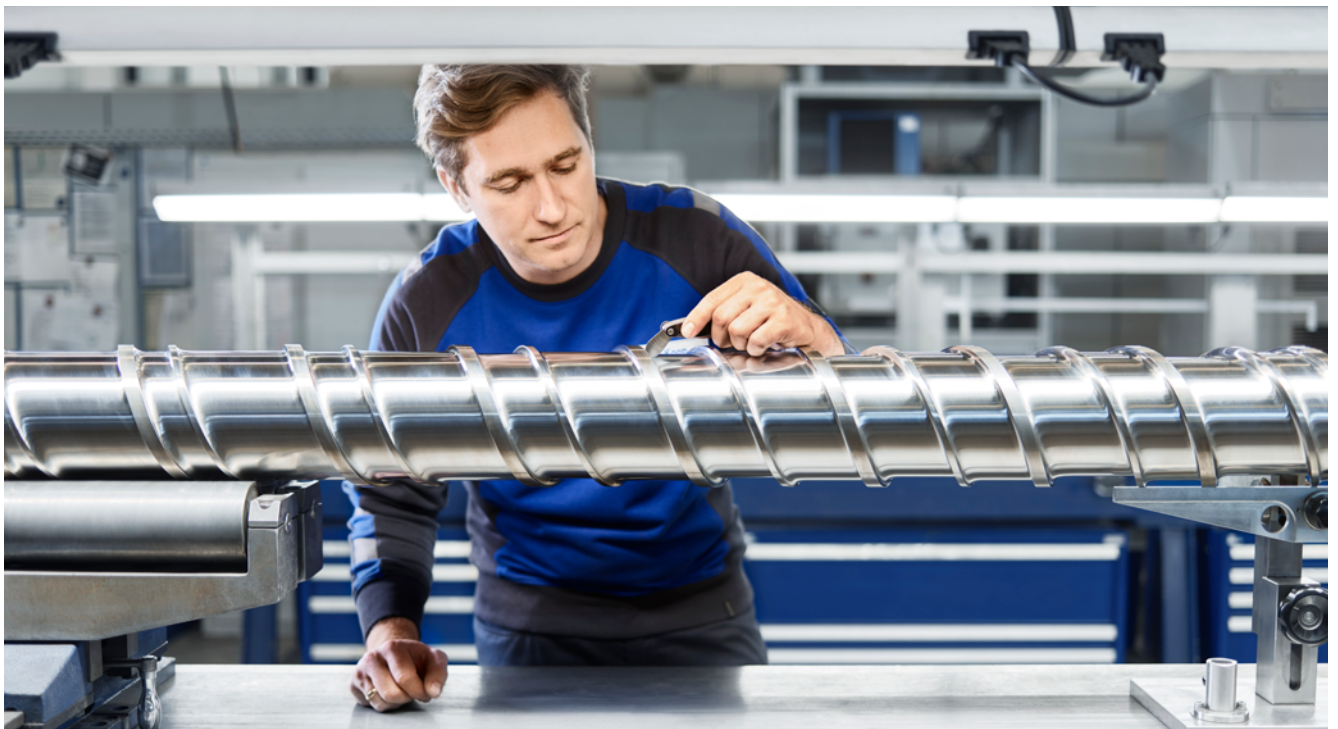
Abb. 60 Instandhaltungsarbeiten an einer Plastifizierschnecke
