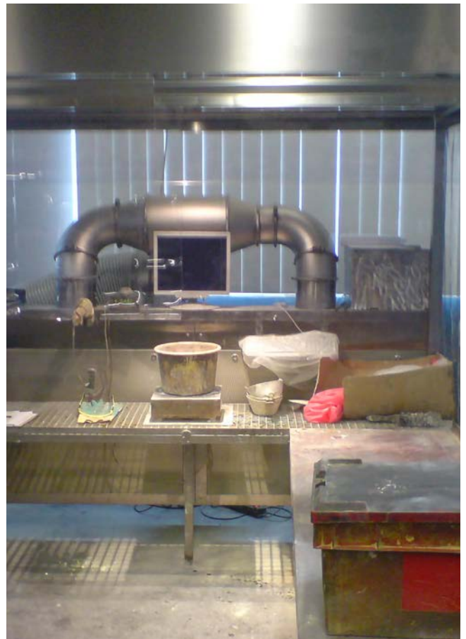
Abb. 25 Gute Praxis für eine Erfassungseinrichtung für Stäube
