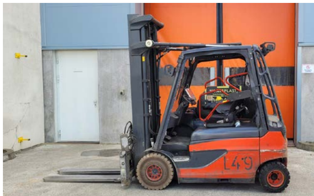
Abb. 20 Gabelstapler mit Bügeltür als Fahrerrückhaltesicherung
