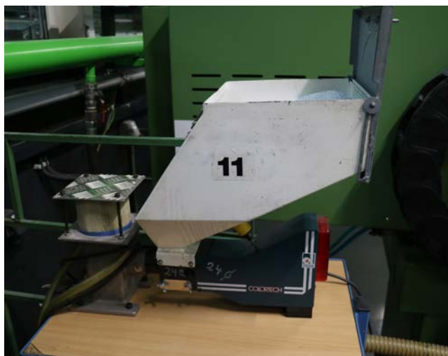
Abb. 15 Ebenerdig erreichbare Aufgabe für Masterbatches
