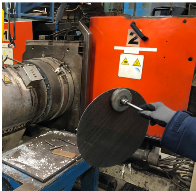
Abb. 55 Einbau eines neuen Siebes mit magnetischer Haltehilfe
