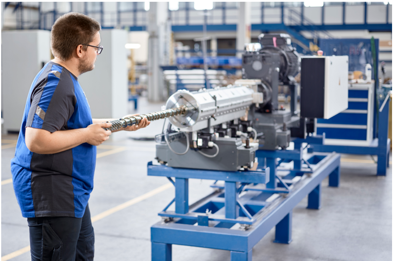
Abb. 58 Schneckenwechsel an einem Extruder
