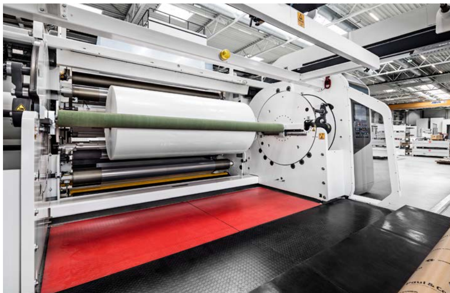
Abb. 51 Kontaktwickler mit Laserscanner und Trittmatte
