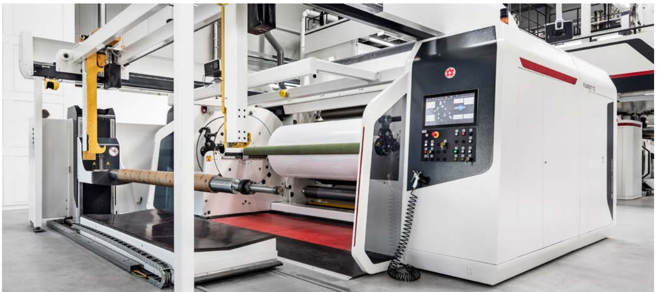
Abb. 48 Zentrumswickler mit Wendeeinrichtung, abgesichert mittels Laserscanner
