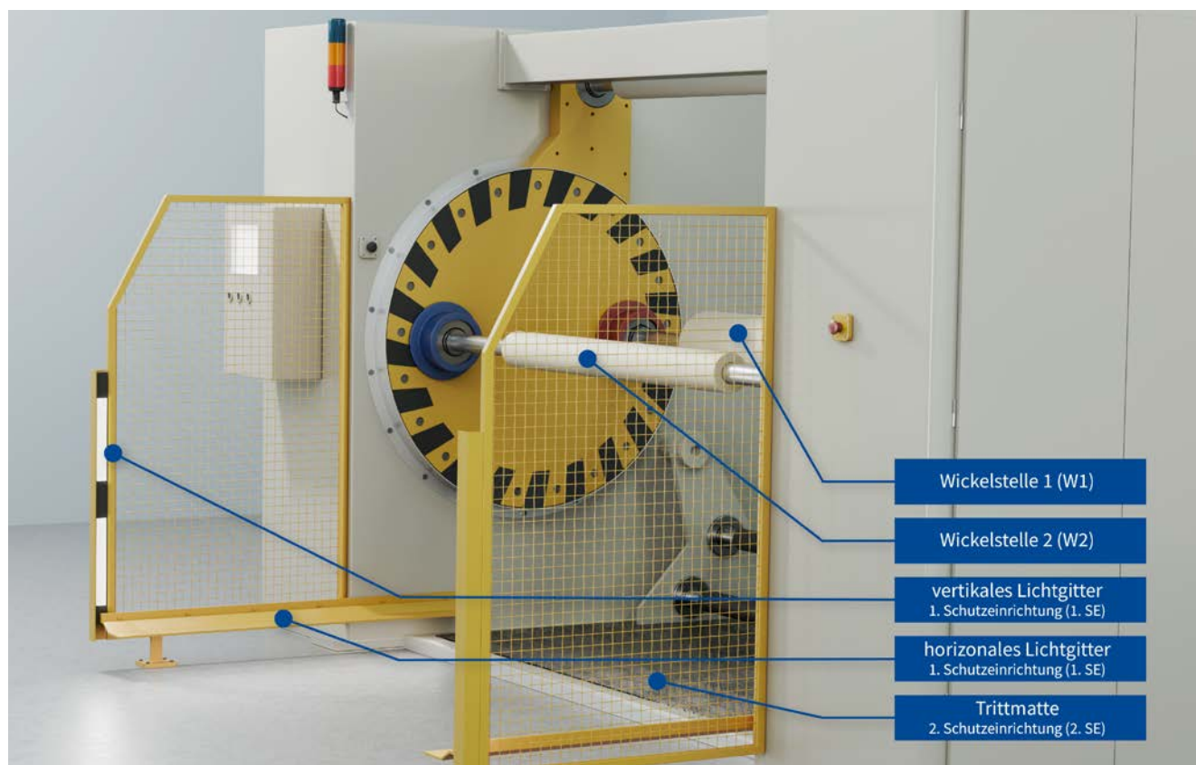
Abb. 49 Aufbau und Schutzeinrichtungen an einem Zentrumswickler mit Wendeeinrichtung
