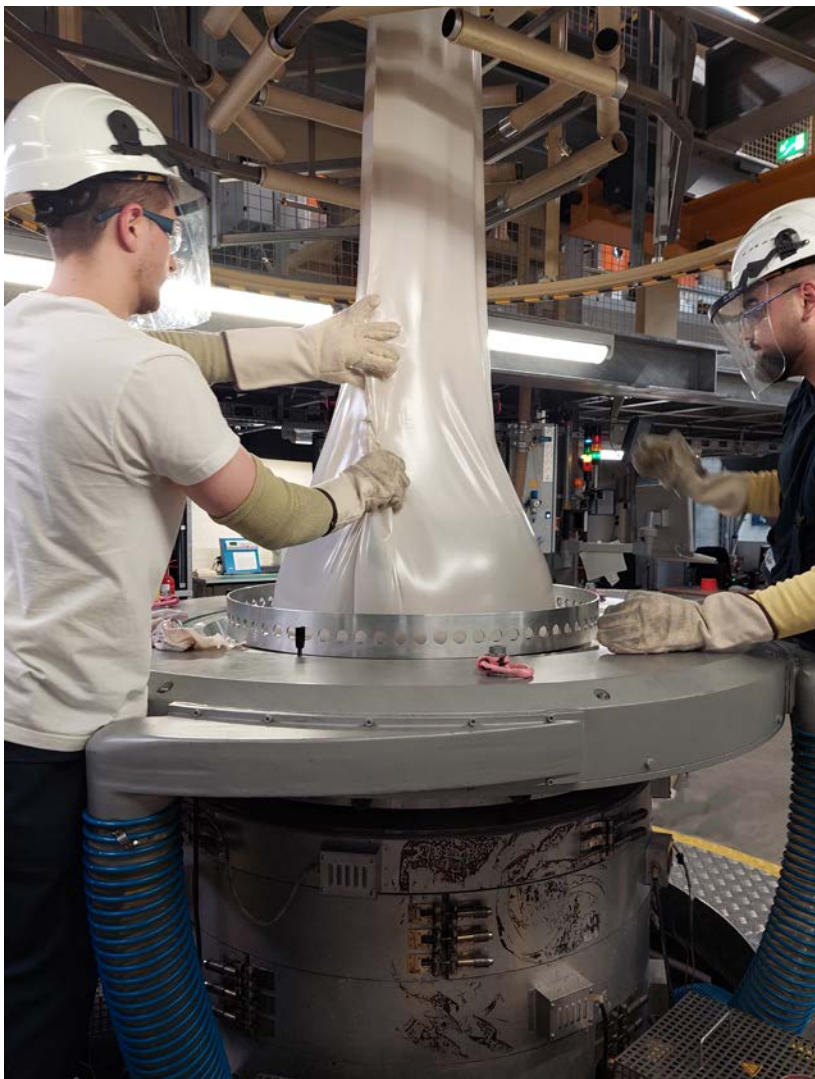
Abb. 21 Beschäftigte mit Persönlichen Schutzausrüstungen (Helm, Visier, Gehörschutz) beim Anfahren einer Blasfolienanlage
