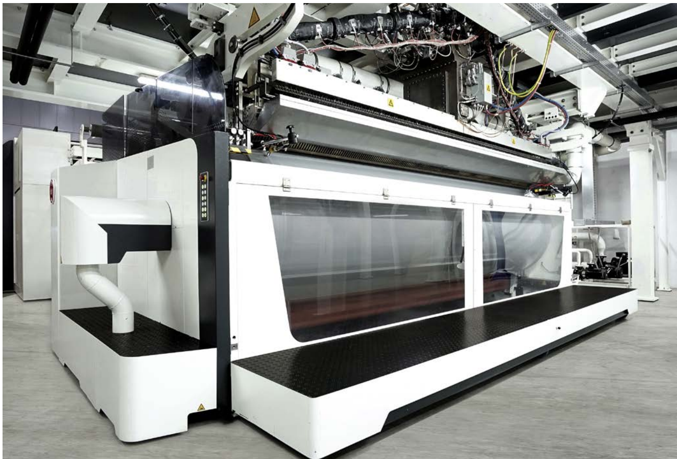
Abb. 82 Chill-Roll-Anlage mit geschlossenen Schutzeinrichtungen
