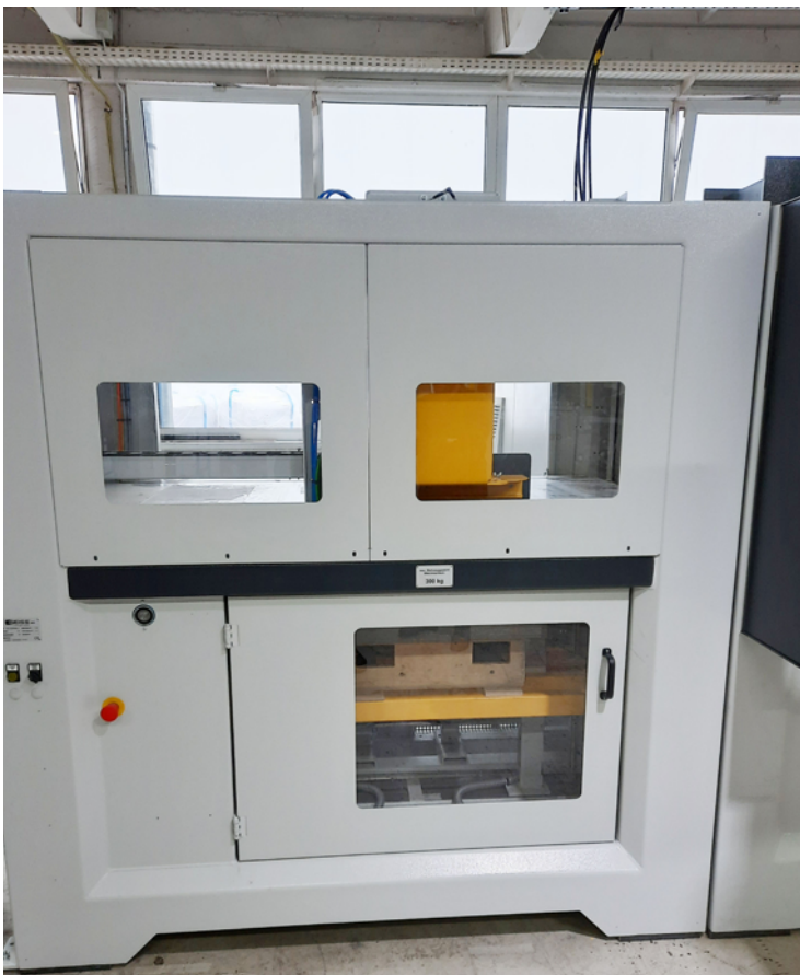
Abb. 80 Mit verriegelten Schutztüren abgesicherte Warmformmaschine
