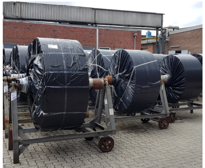
Abb. 77 Sichere Lagerung und innerbetrieblicher Transport von Rollenmaterial
