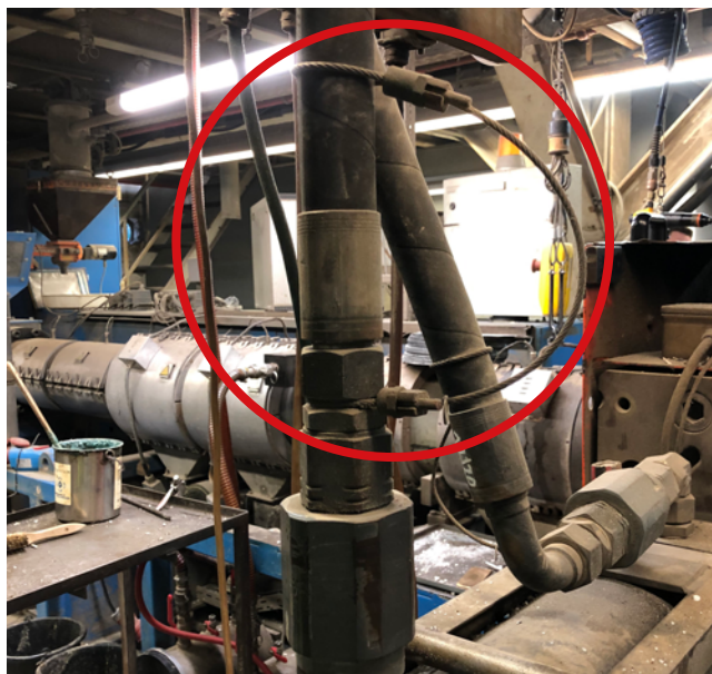
Abb. 54 Fangsicherung an einem Pneumatikschlauch
