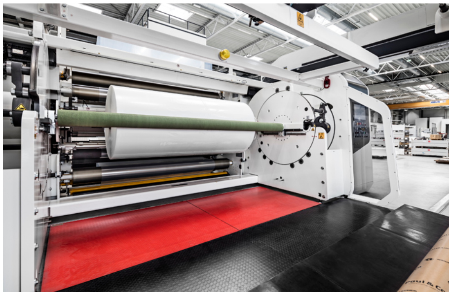
Abb. 51 Kontaktwickler mit Laserscanner und Trittmatte
