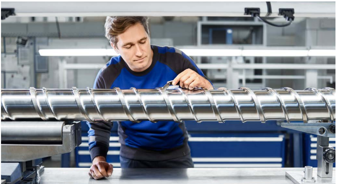
Abb. 60 Instandhaltungsarbeiten an einer Plastifizierschnecke
