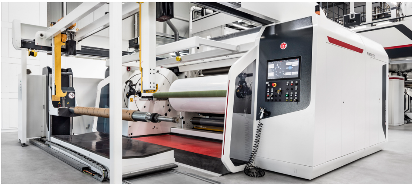
Abb. 48 Zentrumswickler mit Wendeeinrichtung, abgesichert mittels Laserscanner
