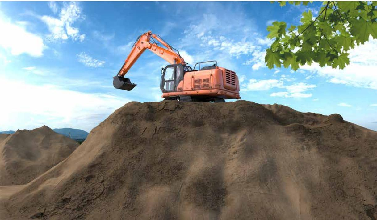
Abb. 80 Kettenbagger sind für den Einsatz auf Dämmen oder Bodenmieten geeignet
