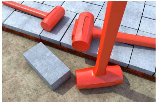
Abb. 47 Schwingungsarmer Hammer
