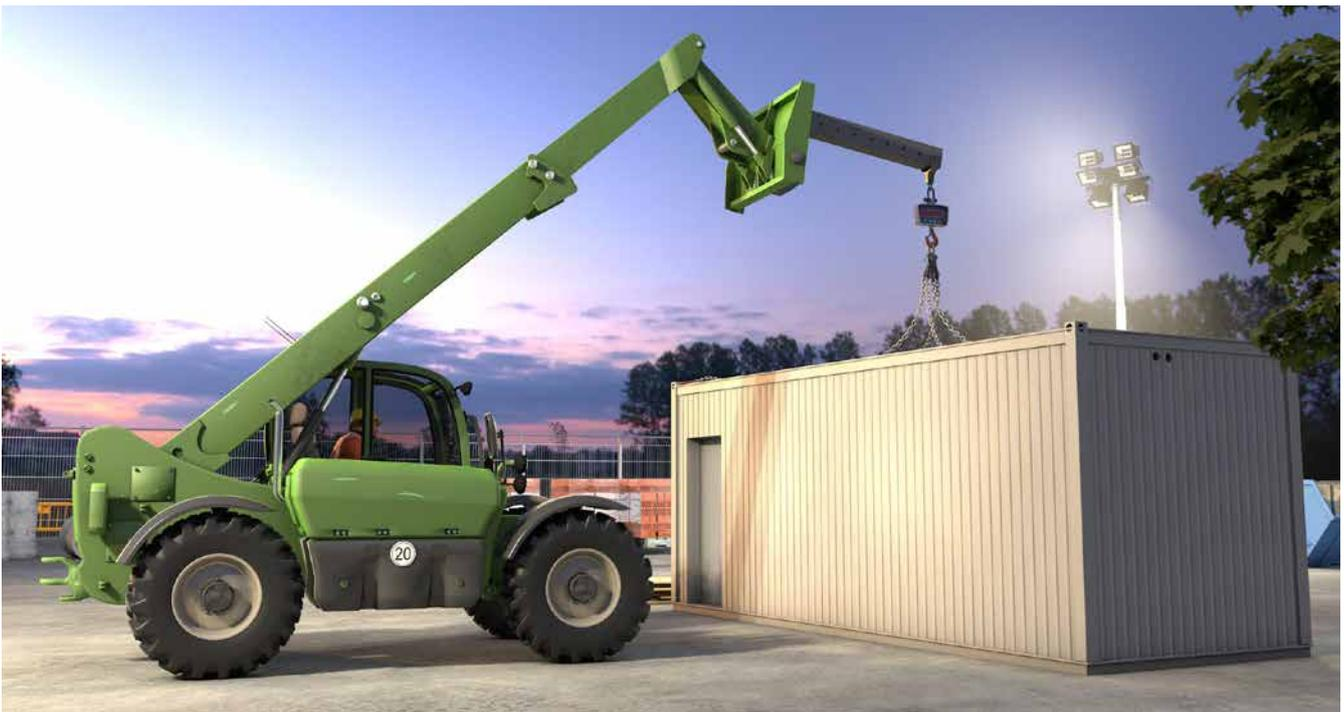
Abb. 61 Sichteinschränkung beim Versetzen großformatiger Lasten
