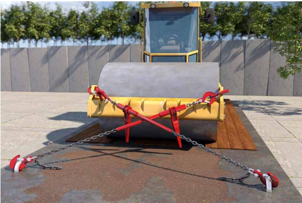
Abb. 85 Mittels Diagonalzurrung gesicherter Walzenzug
