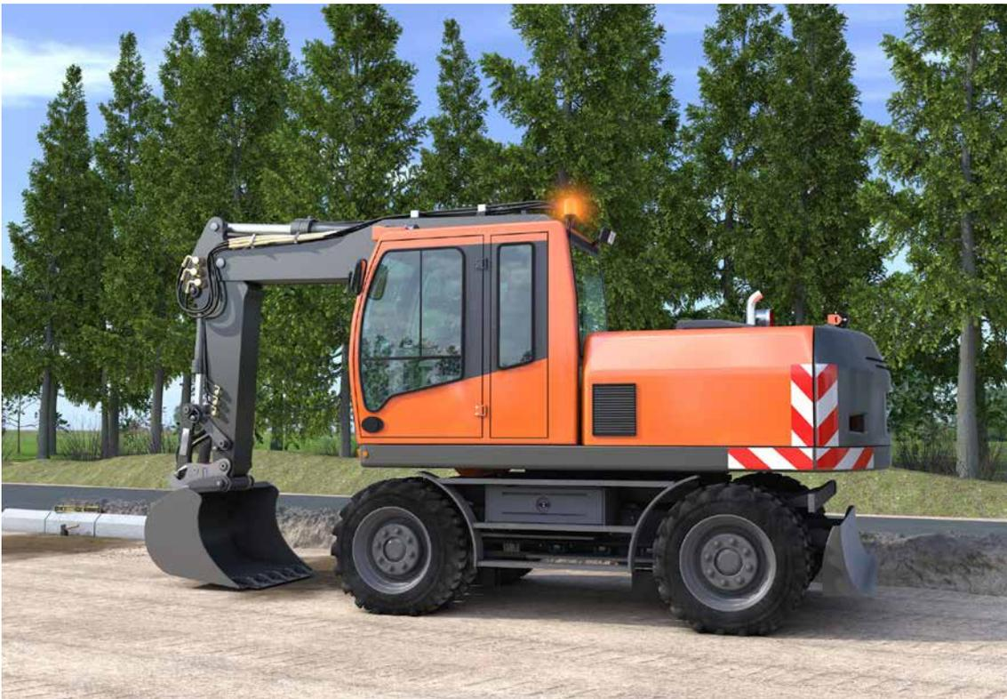
Abb. 67 Sicherheitskennzeichnung und gelbe Rundumleuchte an mobilen Baumaschinen
