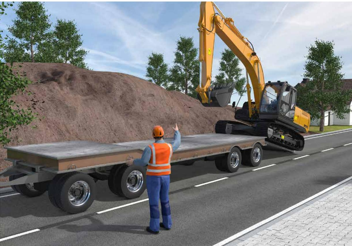
Abb. 83 Verladen eines Baggers
