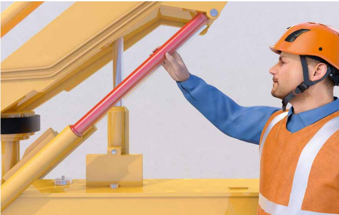
Abb. 94 Formschlüssige Sicherung des Hubgerüsts durch Abstützmanschette
