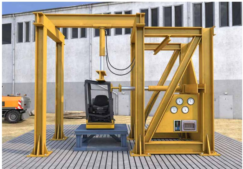
Abb. 82 Baumusterprüfung ROPS (Überrollschutzkonstruktion)
