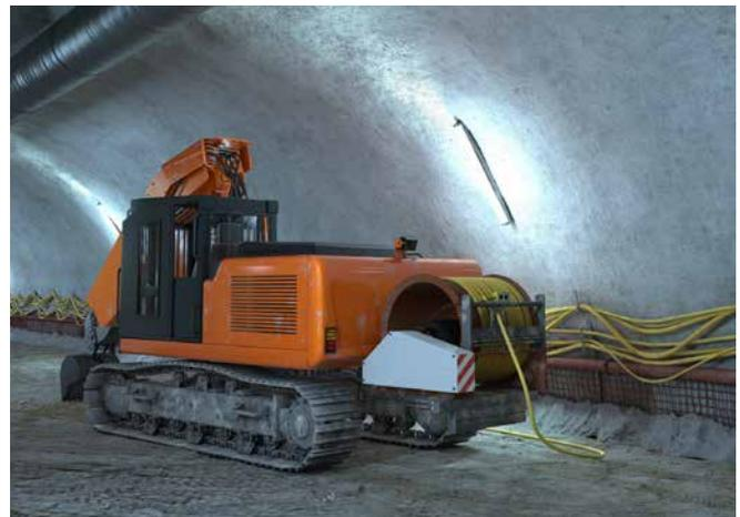
Abb. 143 Bagger mit Elektroantrieb
