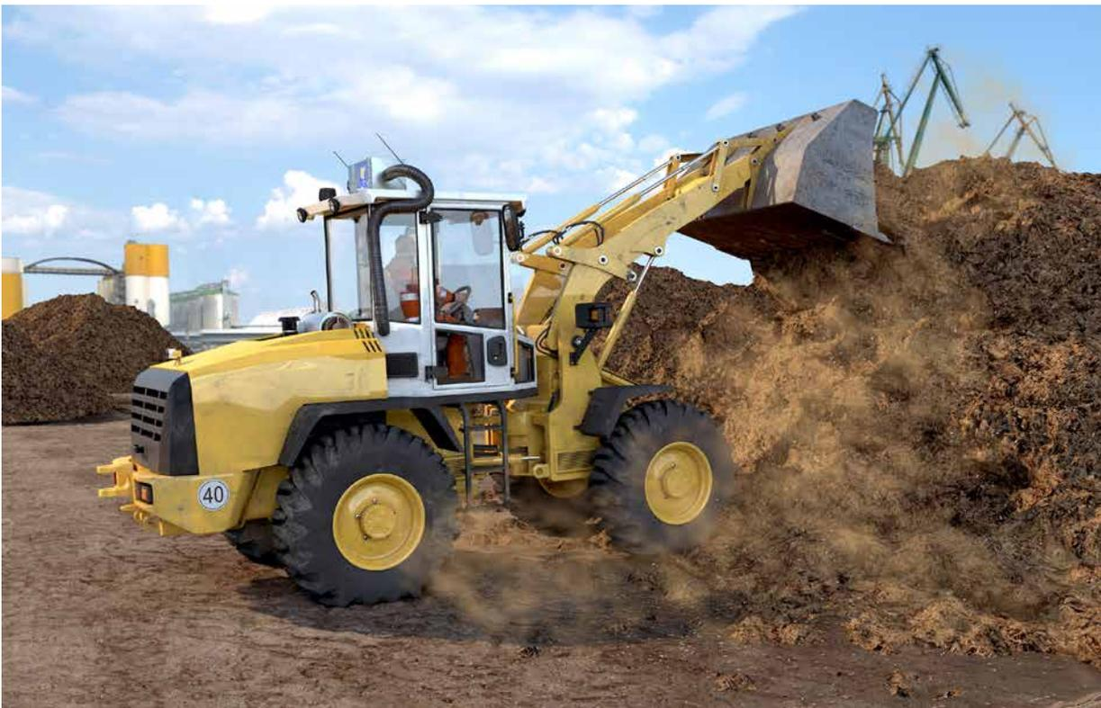
Abb. 91 Radlader mit Filteranlage
