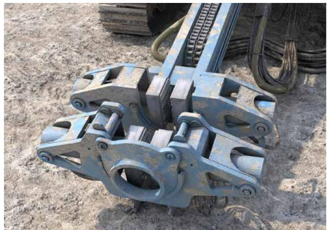
Abb. 130 Gestängebrecheinrichtung
