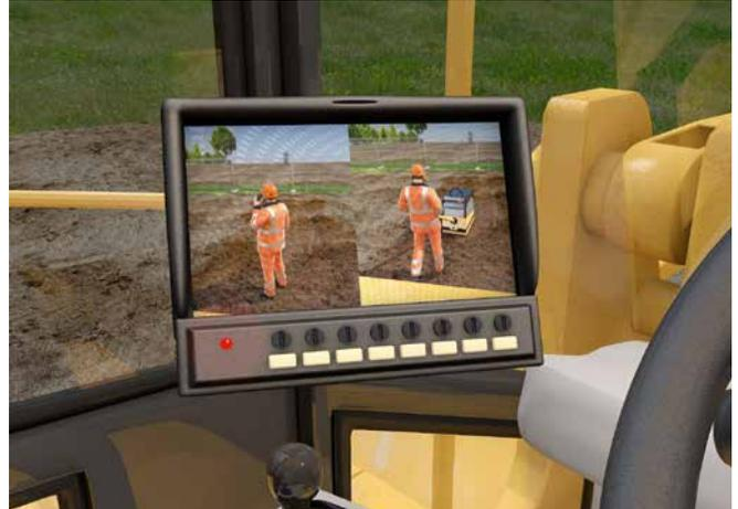
Abb. 74 Splitscreen-Monitor für Rückraum- und Seitenkamera
