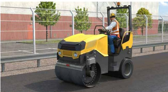
Abb. 101 Bei Umsturzgefahr Überrollschutzeinrichtung und Sicherheitsgurt benutzen
