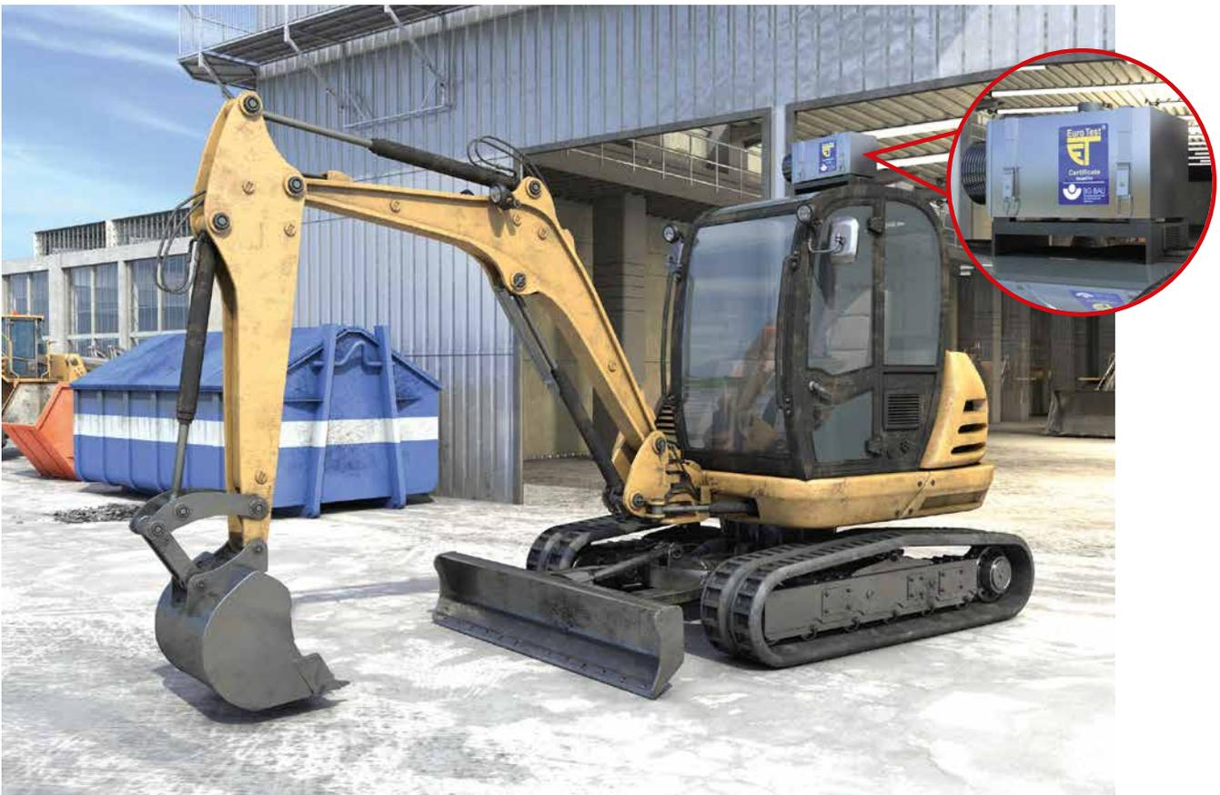
Abb. 17 Bagger mit Schutzbelüftung
