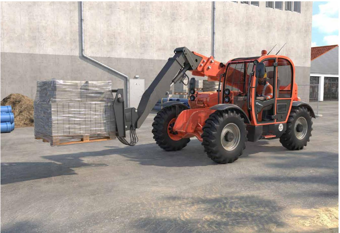
Abb. 60 Sicherer bodennaher Lastentransport
