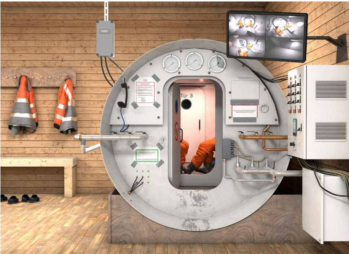
Abb. 142 Personenschleuse bei Arbeiten in Druckluft
