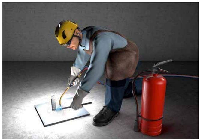
Abb. 66 Schutzausrüstungen beim Gasschweißen
