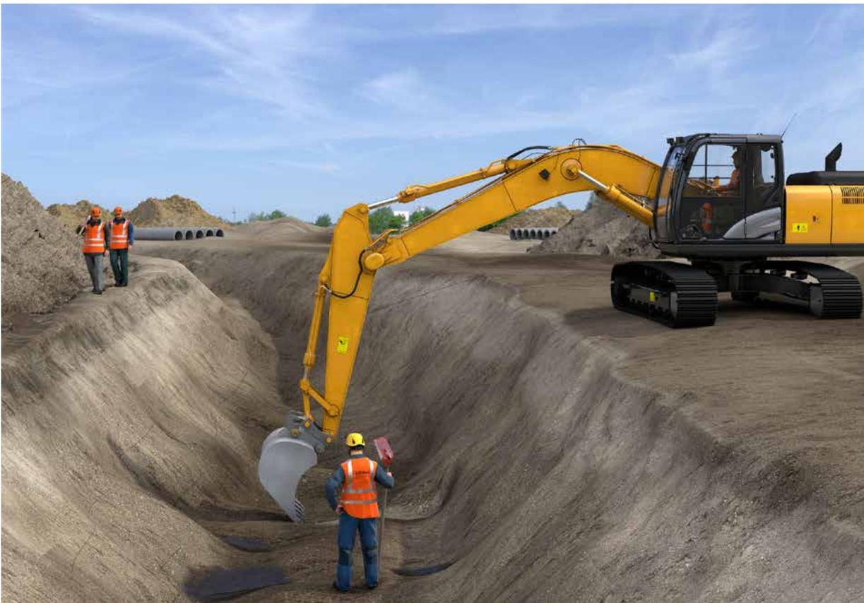
Abb. 104 Schutzstreifen an Baugruben/Grabenrand
