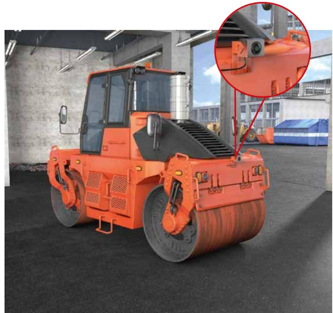
Abb. 96 Sichteinschränkung durch nachgerüsteten DPF wird durch technisches Hilfsmittel ausgeglichen, hier durch Kamera-/Monitorsystem.
