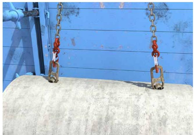
Abb. 87 Formschlüssig wirkende Lastaufnahmemittel (Kugelkopffanker)
