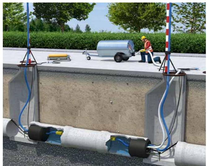
Abb. 119 Durchführung einer Wasserdruckprüfung
