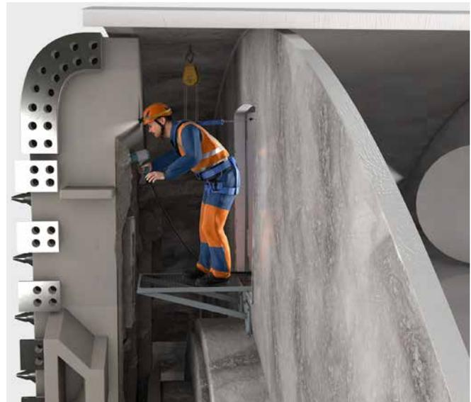
Abb. 141 Arbeitsbühne und PSA beim Werkzeugwechsel
