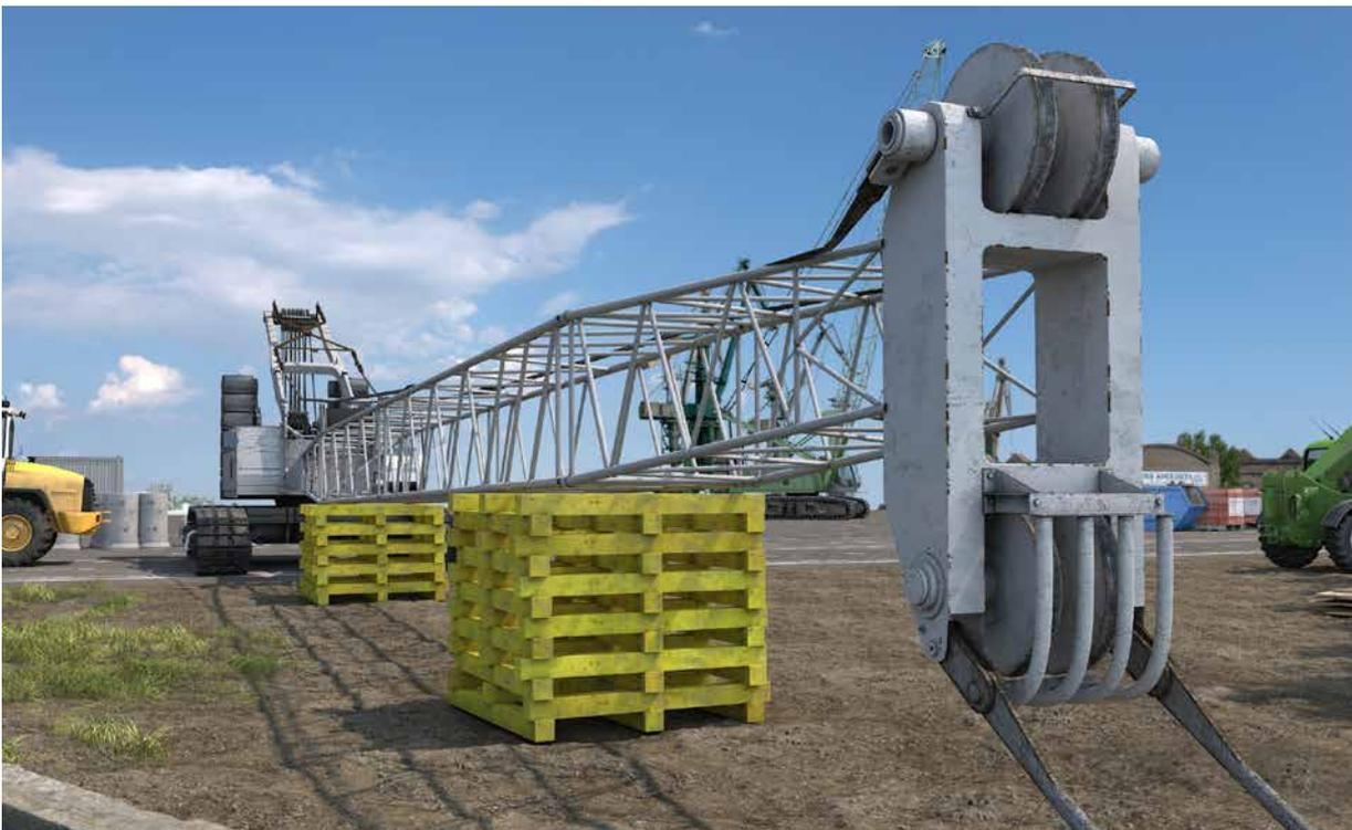
Abb. 131 Auf Pallungen abgelegter Ausleger eines Seilbaggers
