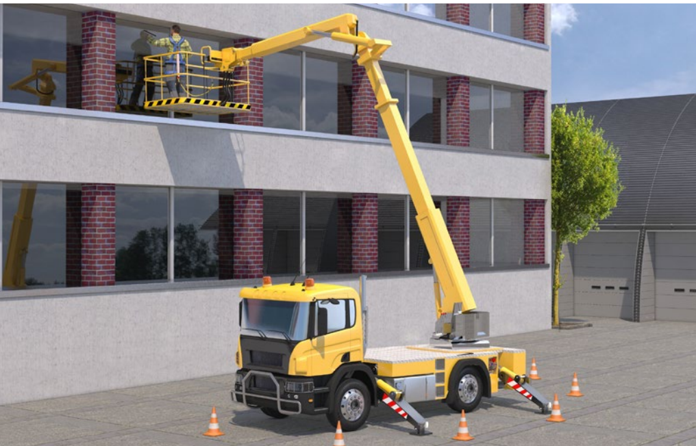
Abb. 41 Teleskopbühne im Einsatz
