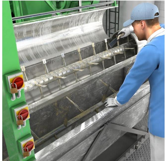
Abb. 73 Anlage gegen Einschalten gesichert
