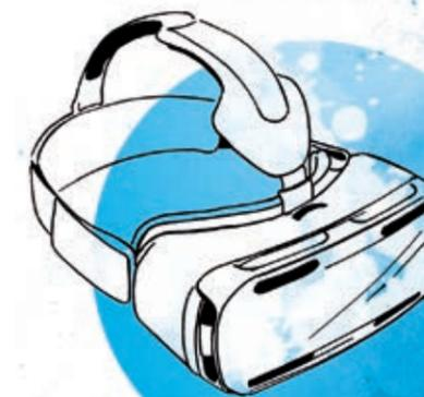
▲ Eine binokulare geschlossene Datenbrille, die eine virtuelle Realität erzeugt.
