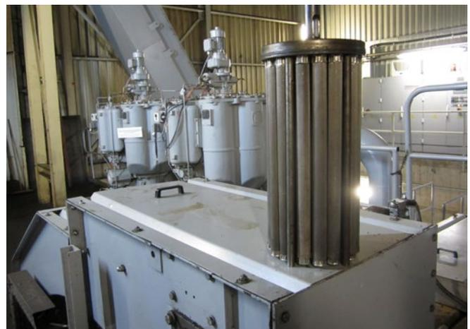
Abb. 5-1 Regenerierbares Filterelement
