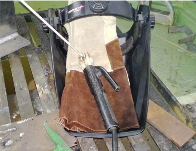
Abb. 6-4 Stabelektrodenhalter immer isoliert ablegen
