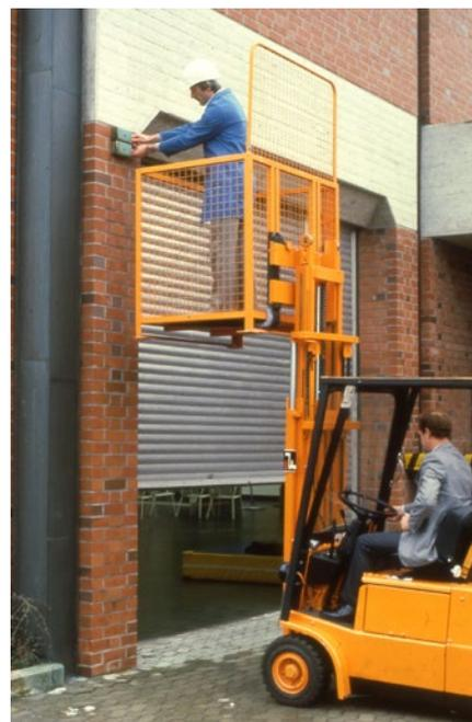
Abb. 4-5 Flurförderzeug mit Arbeitskorb
