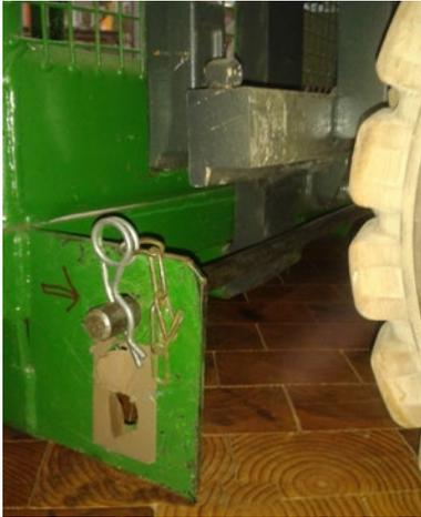
Abb. 4-6 formschlüssige Sicherung gegen Abrutschen
