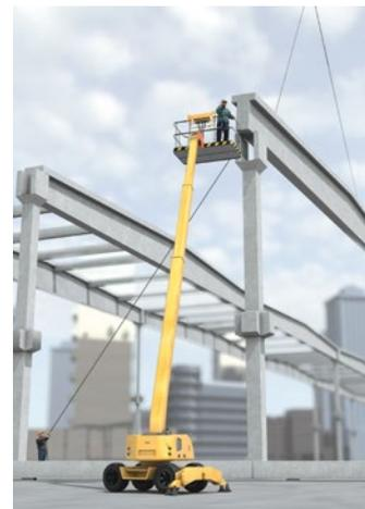
Abb. 4-3 Schwenkarm-Hubarbeitsbühne
