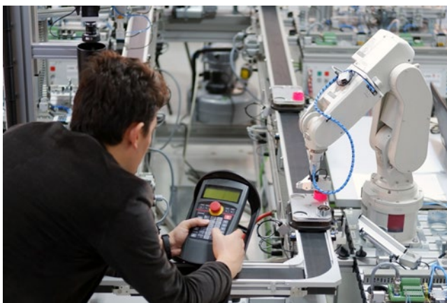
Abb. 14 Bedienung eines Industrieroboters mit Fernbedienung
