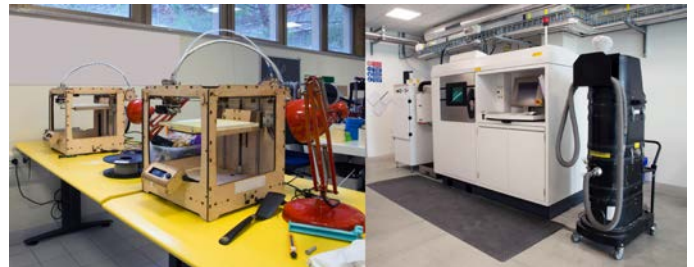
3D-Drucker gibt es als vergleichsweise kleine Tischgeräte (links) und deutlich größere Anlagen (rechts). (Bilder: Moreno Soppelsa, Fotolia.com)
