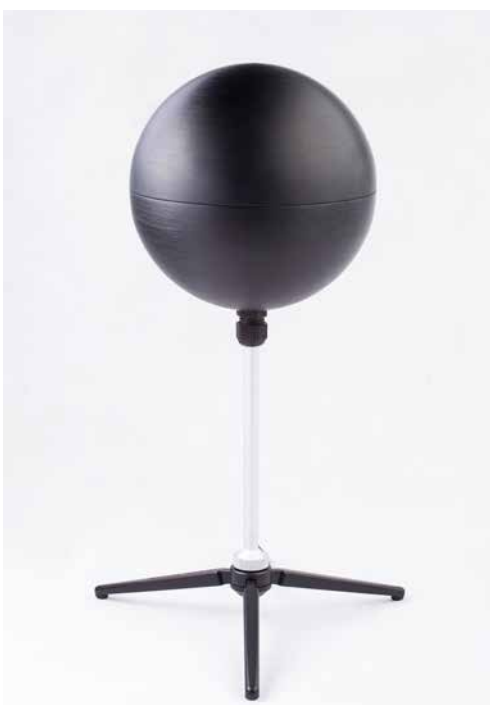
Bild 2: Delta-Radiometer (links) und Globe-Thermometer
