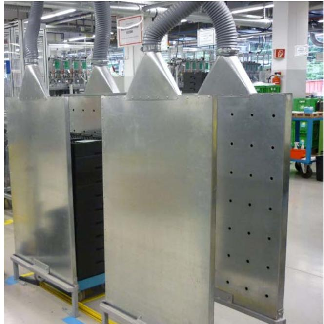
Abbildung 2 Abgesaugter Hordenwagen
