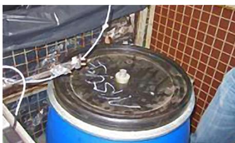
Abb. 12 Sammelbehälter für Bruch mit modifiziertem Spannringdeckel (Verschlussstopfen für verkleinerte Einwurfsöffnung)
