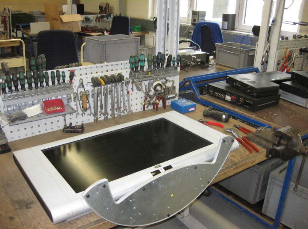
Abb. 1 Demontagearbeitsplatz (nicht abgesaugt)
