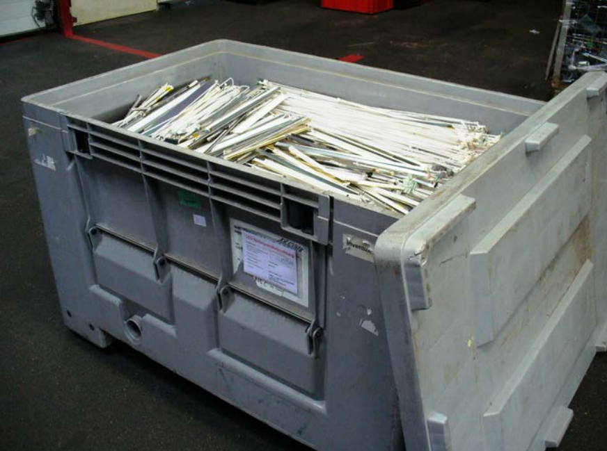
Abb. 5 Sammelbehälter für unbeschädigt ausgebaute Röhrchen
