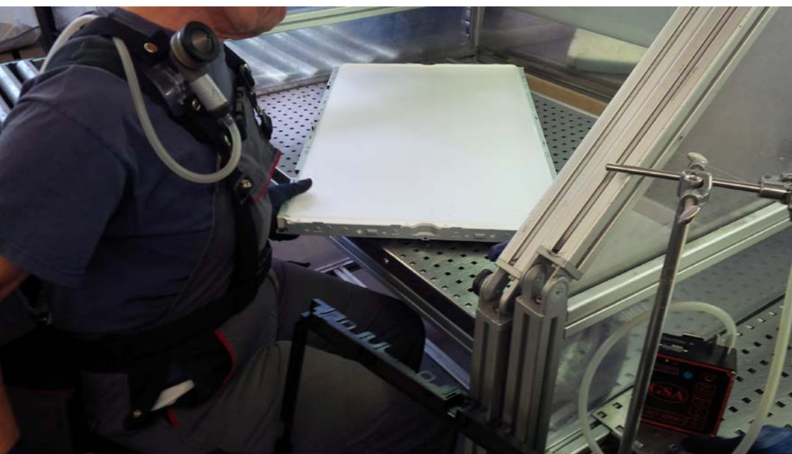
Abb. 2 Demontagearbeitsplatz (abgesaugt), Quecksilbermessung an der Person
