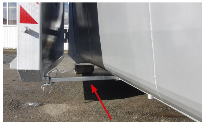
Abb. 24 Sicherung der Entladungstür am geöffneten Behälter
