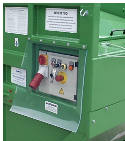
Abb. 19 Spritzschutz durch einen Abweiser
