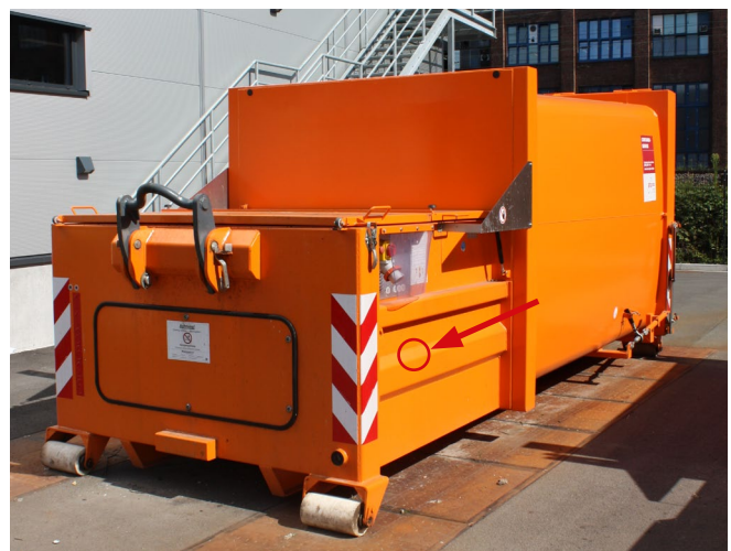
Abb. 9 Abgeschrägter Querspant; Aufstieg erschwert
