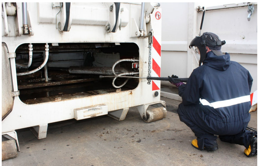
Abb. 12 Reinigung des Arbeitsraums mit Hochdruckwasserstrahl
