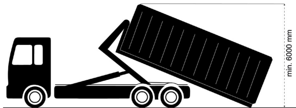
Abb. 37 Rangierhöhenbedarf für Abrollkipper
