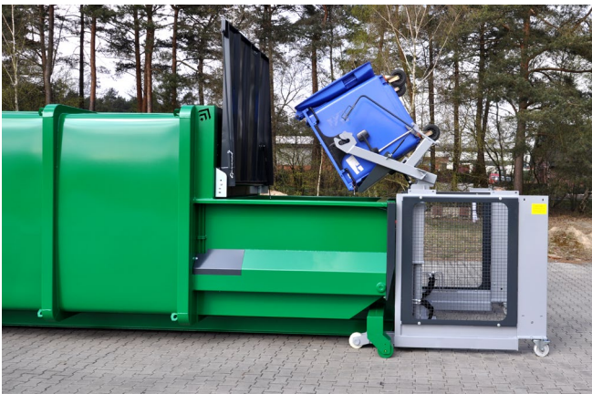
Abb. 15 Trennende Schutzeinrichtung an externer Hub-Kippvorrichtung
