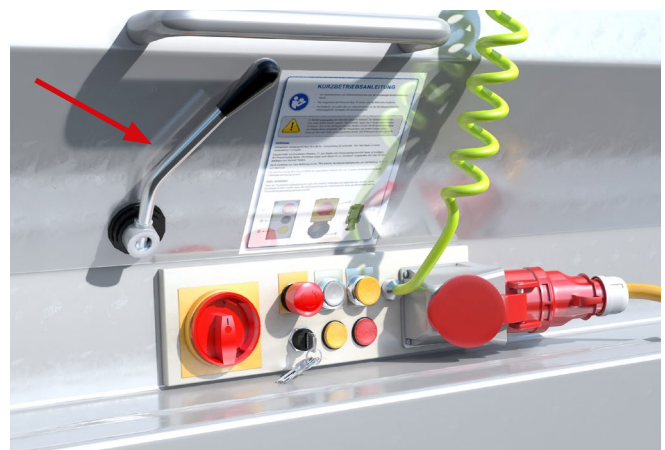
Abb. 14 Stellhebel für eine Kippvorrichtung mit darüberliegendem Schutzbügel
