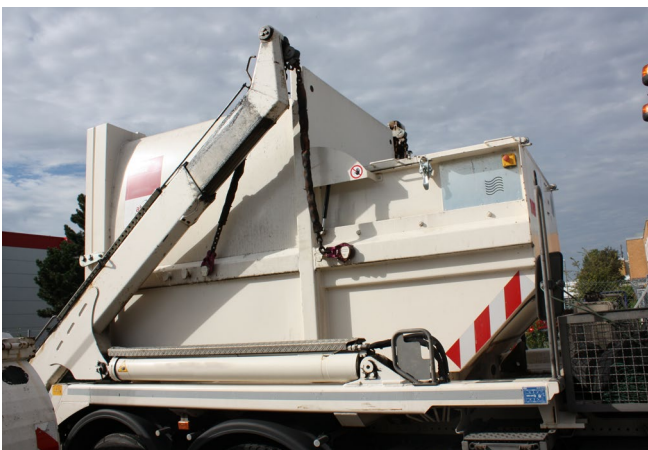
Abb. 1 Mobile Behälterpresse mit horizontalem Pressschild für ein Absetzkipperfahrzeug
