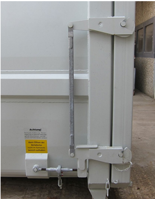
Abb. 25 Verriegelung der Entladungstür
