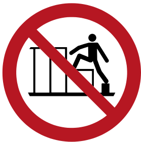
Abb. 30 Hineingreifen oder Betreten des Zuführtrichters/ der Zuführöffnung verboten (DIN EN 16486:2014-10, Bild 7)
