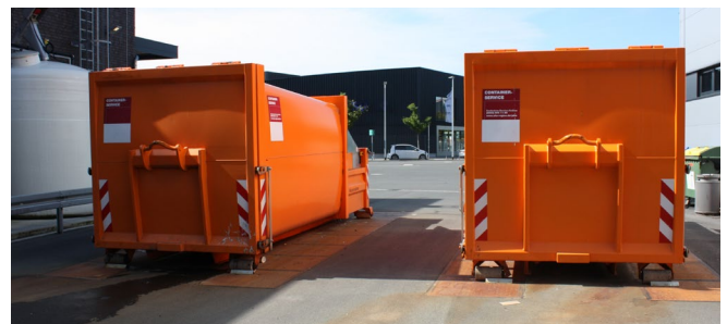
Abb. 36 Ideale Voraussetzungen zur Einhaltung der Sicherheitsabstände bei Aufstellung mobiler Behälterpressen
