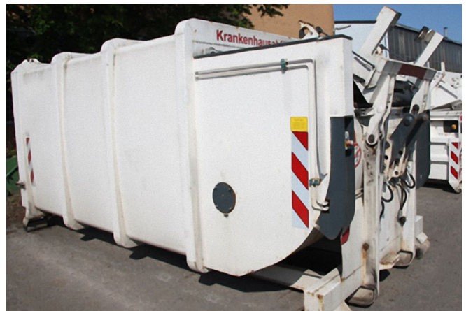
Abb. 4 Mobile Schwingkolbenpresse für ein Abrollkipperfahrzeug mit integrierter Hub-Kipp-Vorrichtung
