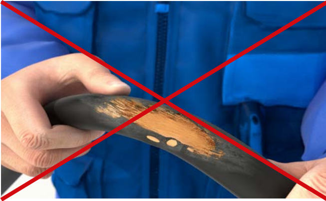
Abb. 12 Beschädigte elektrische Leitung
