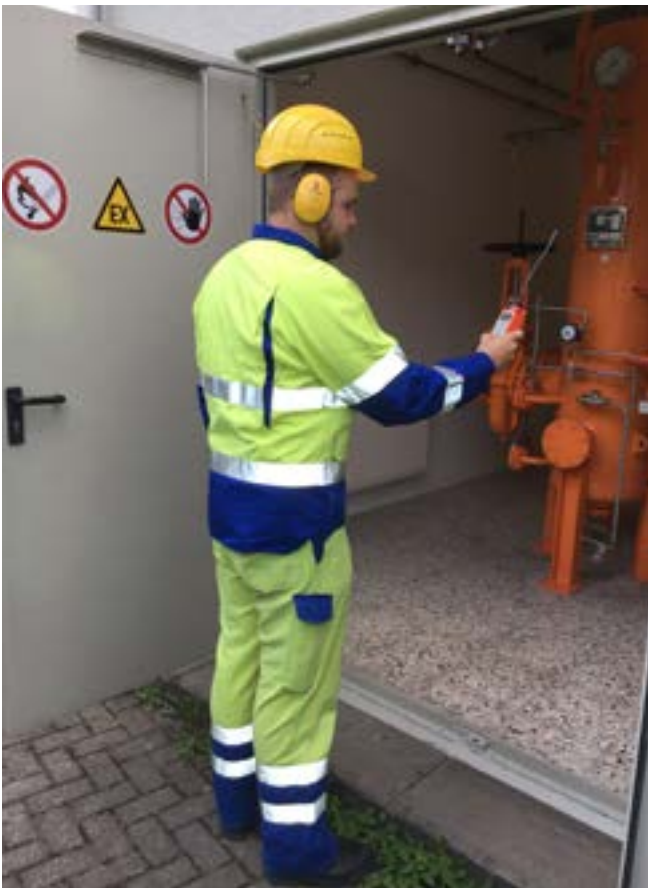
Abb. 12 Arbeitsplatzüberwachung mit einem tragbaren Gaswarngerät
