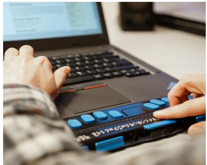
Abb. 13 Ein- und Ausgabegerät für Brailleschrift
