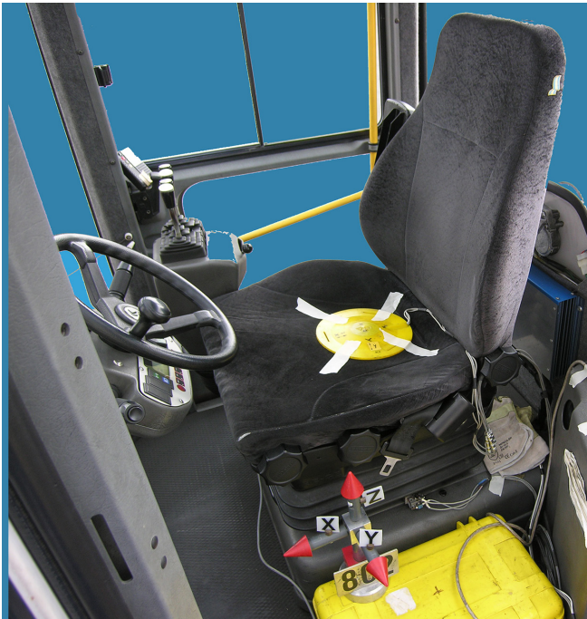
Abbildung 6: Beispiel für die Anbringung der Messsensoren für GKV
