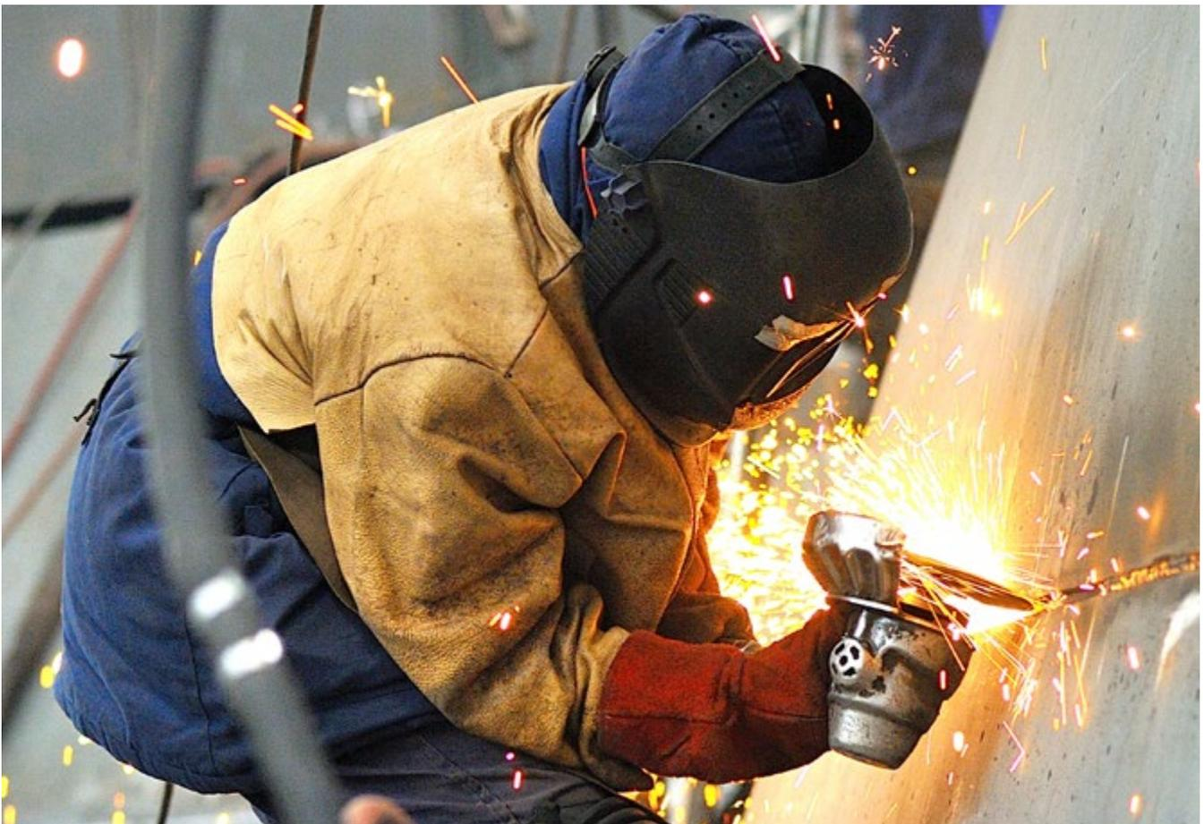
Abb. 23 Ausschleifen einer Außenhautschweißnaht
