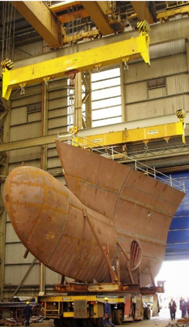
Abb. 69 Transport einer Schiffssektion mit Schwerlasttransporter
