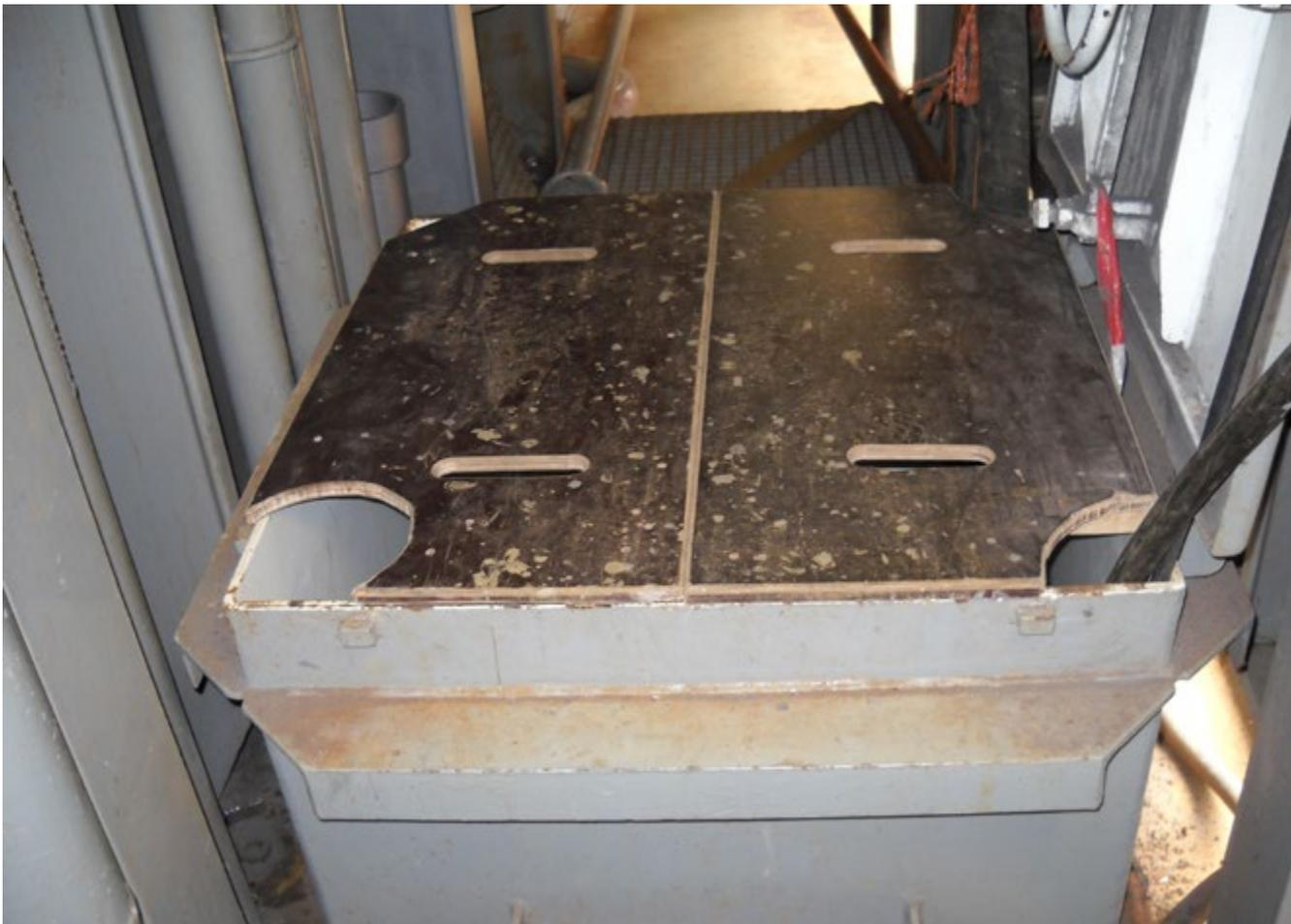
Abb. 24 Abdeckung eines Laderaumzugangs mit Siebdruckplatten
