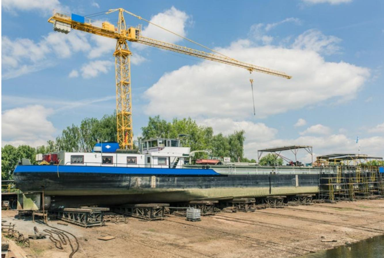
Abb. 63 Querslipanlage mit Binnenschiff
