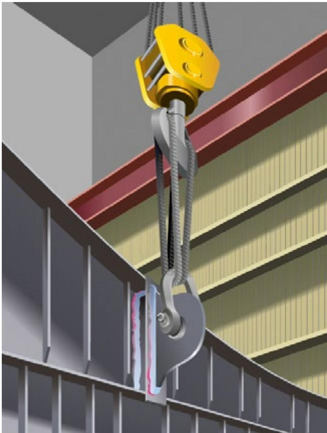
Abb. 65 Geprüfte Schweißanschlüsse an einem Transport- und Anschlagpunkt
