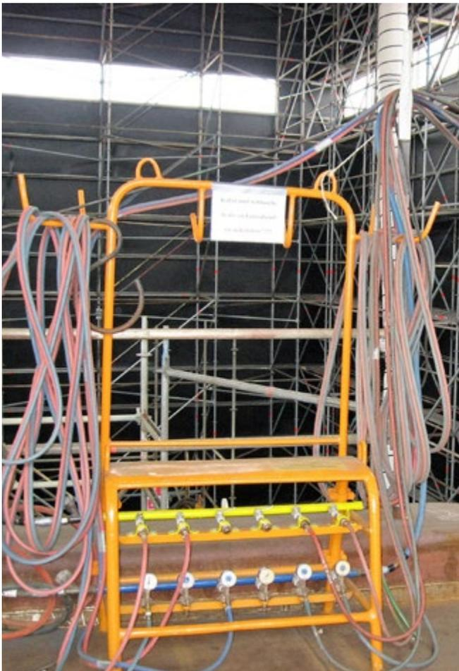
Abb. 41 Entnahmestelle für Acetylen und Sauerstoff an Bord
