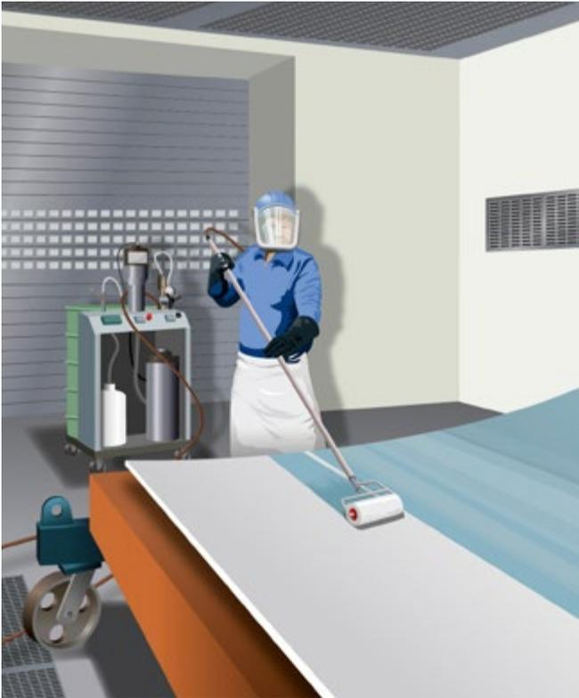
Abb. 75 GFK-Fertigung in der Werkstatt
