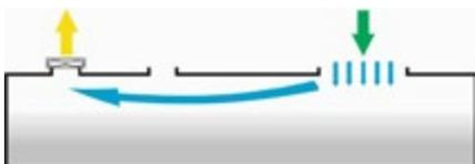
Enge Zuluftöffnungen sorgen für höhere Strömungsgeschwindigkeiten und damit für bessere Durchmischung der Luft im Tank/Behälter. Engen Sie deshalb die Zuluftöffnungen ein, z. B. durch Verkleinerungen des Mannlochs.
