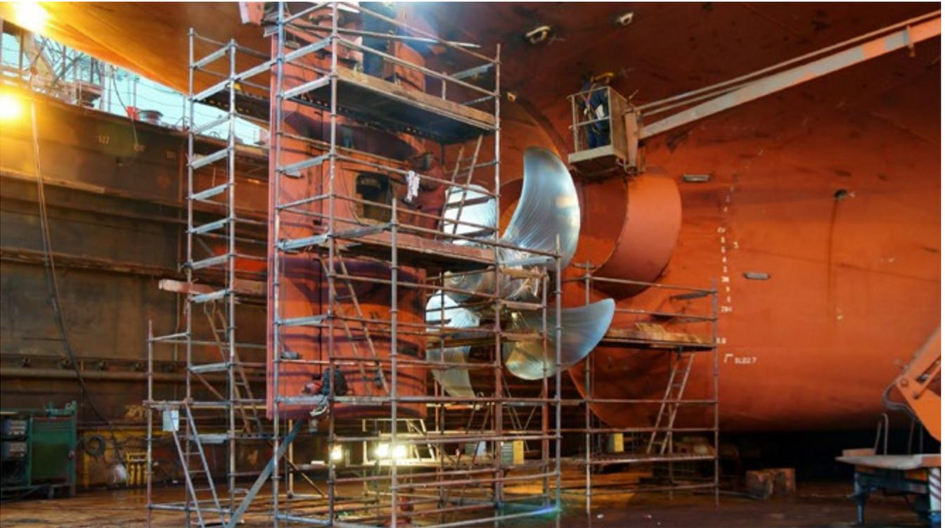
Abb. 54 Reparaturarbeiten an der Ruderanlage im Dock
