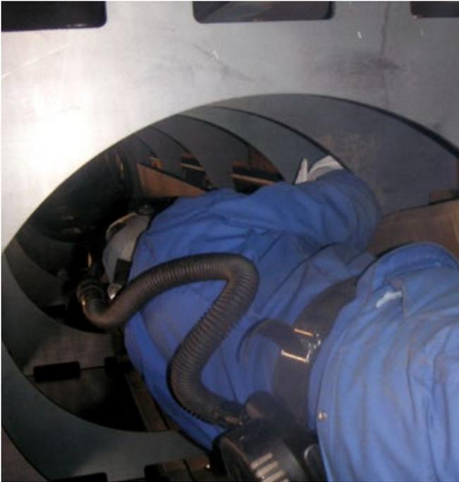
Abb. 49 Schweißen in einem engen Raum
