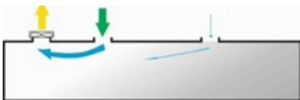
Eine effektivere Durchspülung erreichen Sie ohne Kurzschluss, indem Sie immer nur die diagonal am weitesten voneinander entfernten Öffnungen nutzen. Alle anderen Öffnungen sind geschlossen zu halten, wenn sie nicht mit einem Lüfter besetzt sind.
