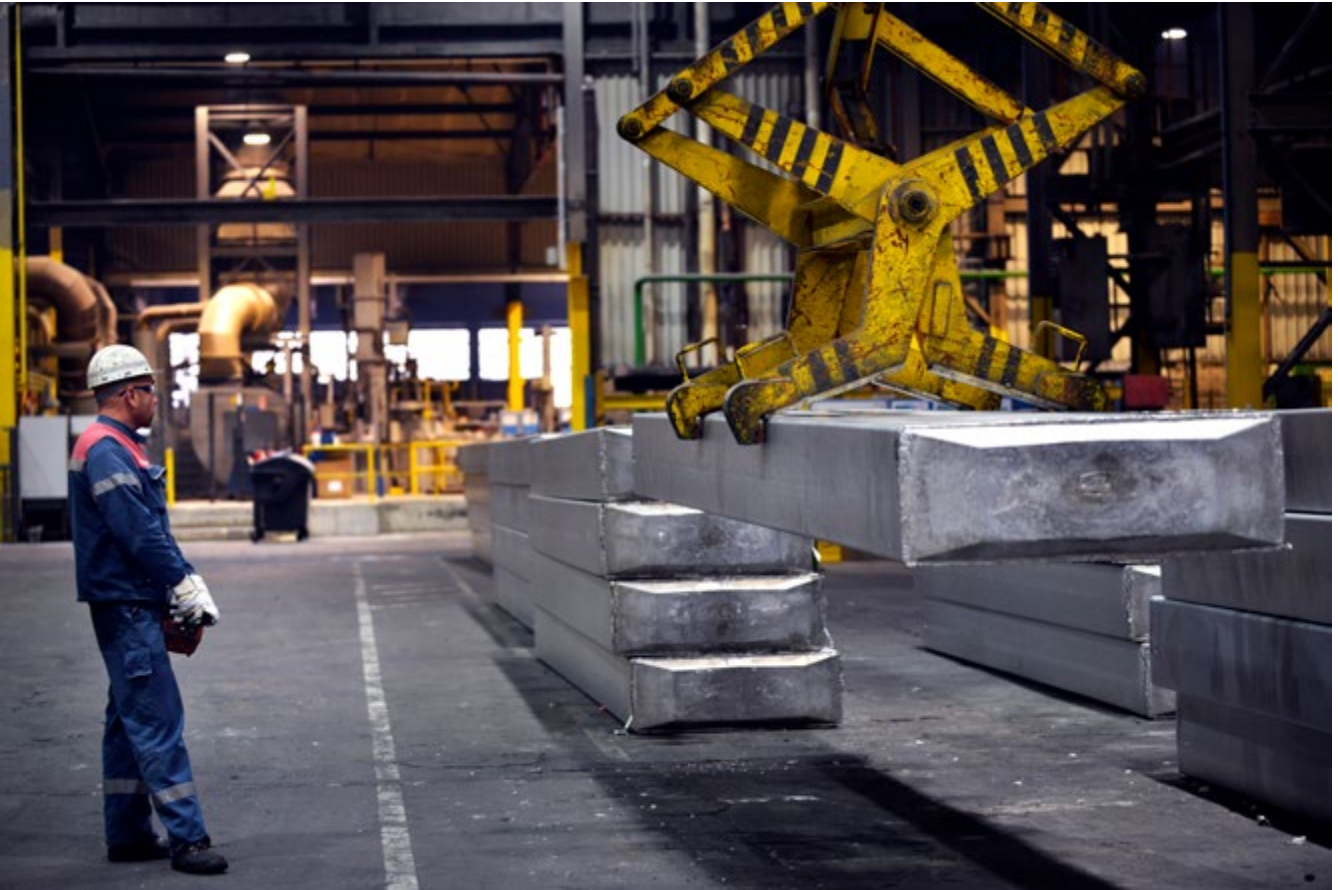
Bild 2 Krantransport von Aluminiumbrammen
