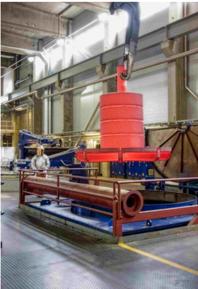
Abb. 11 Rotglühende Charge am Kran (vor Abschrecken)
