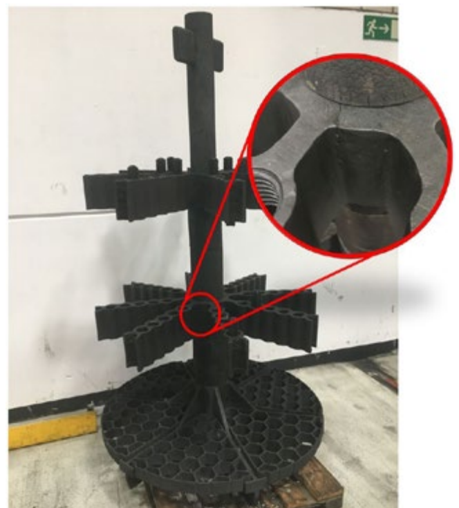
Abb. 38 Rissbildung an Chargengestell
