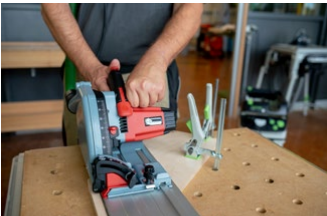
Abb. 3.3.1-10 Sägevorgang mit sicher fixiertem Werkstück
