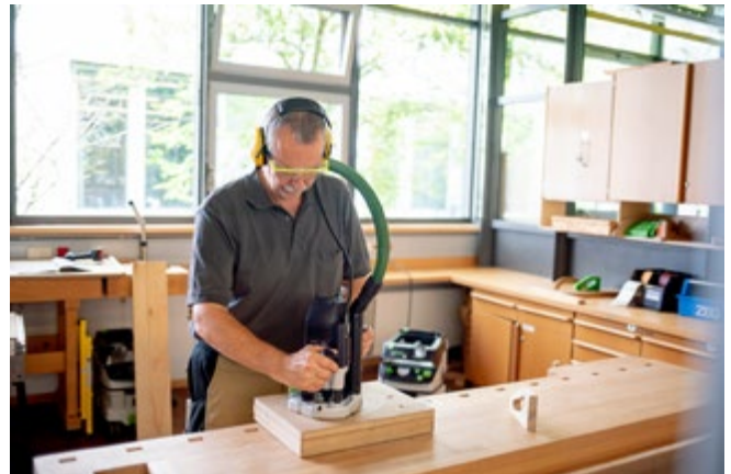
Abb. 3.3.2-02 Maschine an Absaugeinrichtung anschließen
