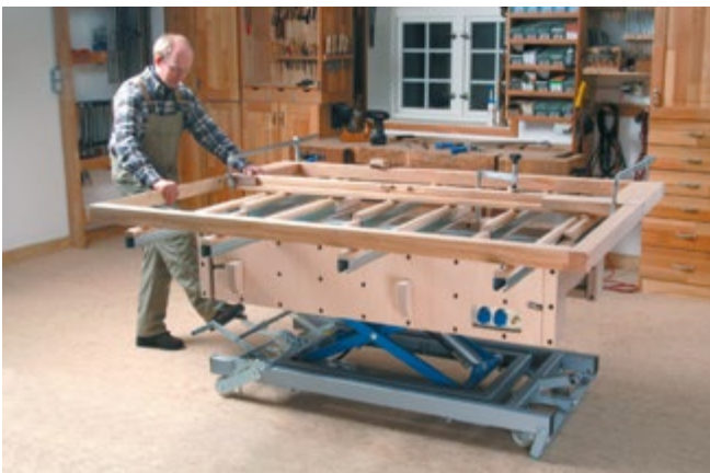
Abb. 3.4.5-03 Scherenhubtisch zur Montage
