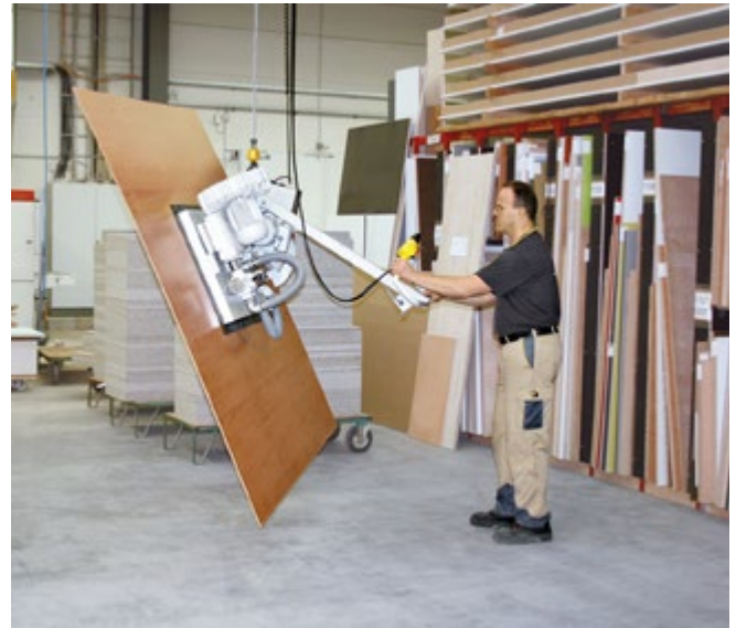
Abb. 3.1.2-08 Vakuum-Hebegerät für das Plattenhandling
