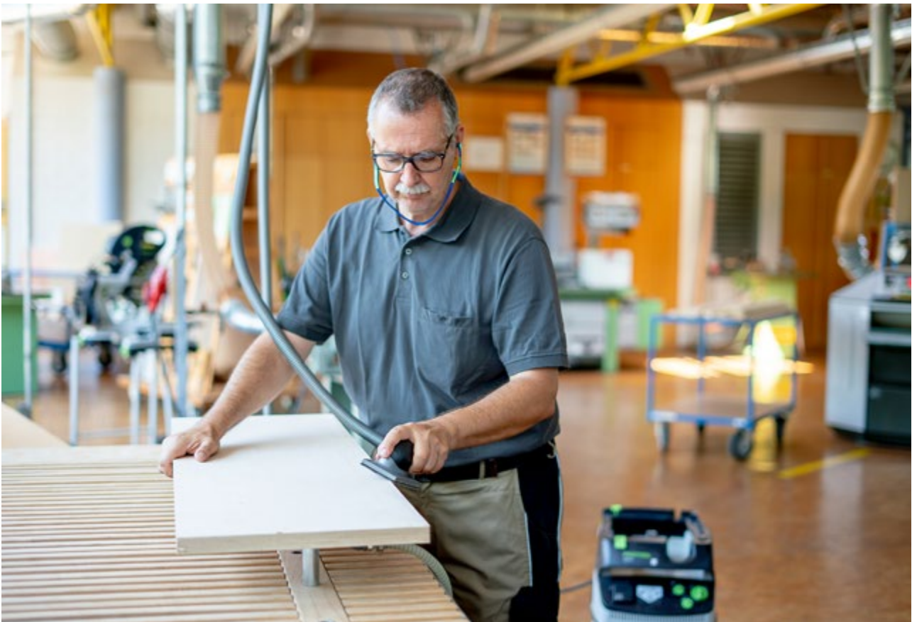
Abb. 3.3.6-01 Handschleifarbeiten mit abgesaugtem Handschleifklotz
