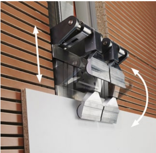
Abb. 3.1.2-04 Klemmvorrichtung für Besäumschnitt
