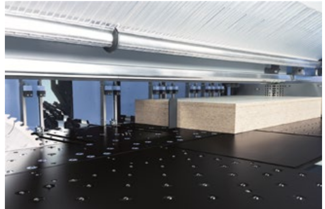
Abb. 3.1.3-02 Hohes Plattenpaket mit Winkelandrückvorrichtung
