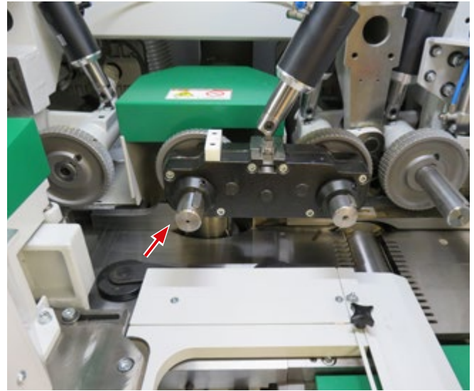
Abb. 3.1.13-05 Verdeckung einer hinteren Vertikalspindel mit Aufsteckspindel
