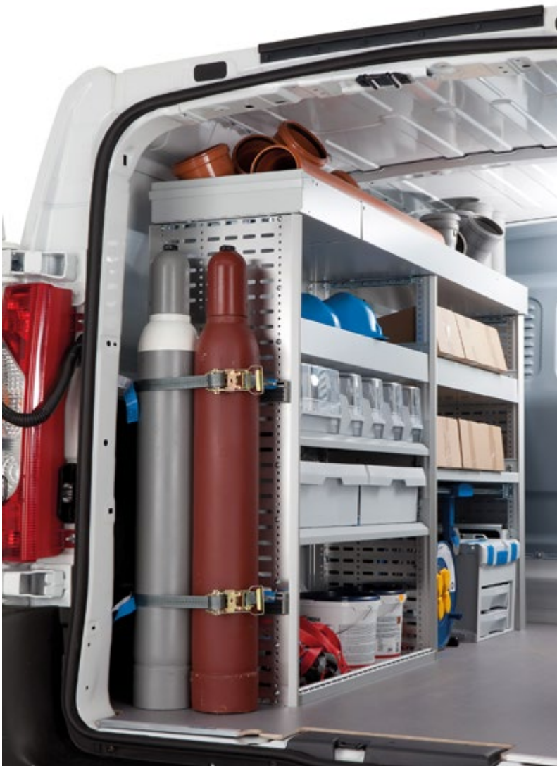
Abb. 3.5.6-01 Fahrzeug mit Einrichtungen zur Ladungssicherung
