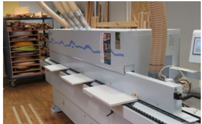
Abb. 3.1.12-04 Kantenanleimmaschine mit Absauganschlüssen
