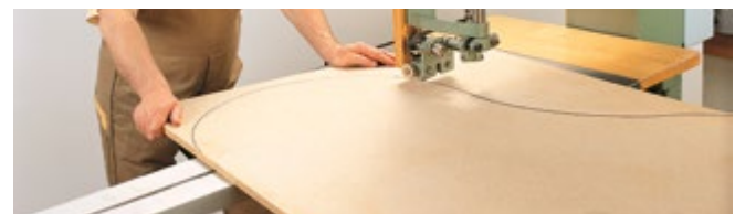
Abb. 3.1.6-09 Sägen sperriger Werkstücke mit zusätzlicher Tischverbreiterung
