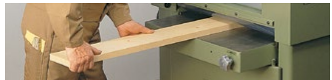
Abb. 3.1.10-05 Werkstück auf Dicke hobeln
