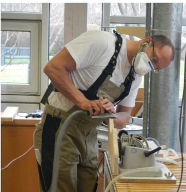
Abb. 2.2.3-07 Arbeiten mit Schutzmaske
