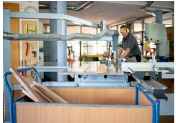
Abb. 3.1.1-05 Sammelbehälter für Materialstücke bereitstellen
