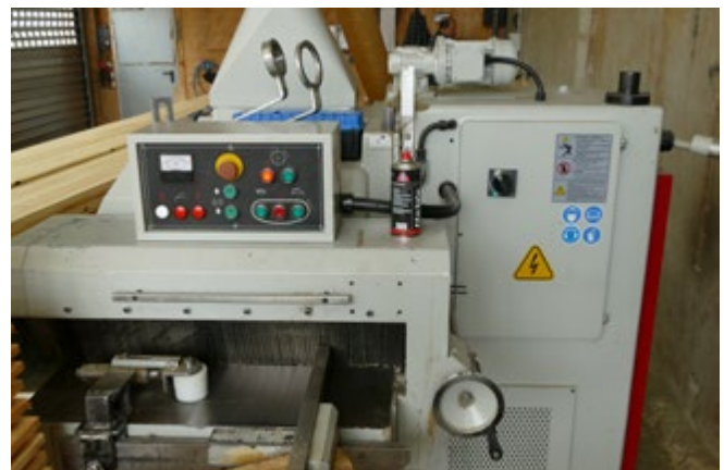
Abb. 3.1.14-04 Einschubbereich mit Splitterfänger
