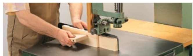
Abb. 3.1.6-10 Sägen kurzer Werkstücke mit Zuführhilfe
