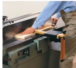
Abb. 3.1.9-07 Schwenkbarer Hilfsanschlag (Abrichten schmaler Leisten)
