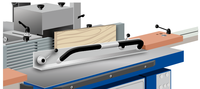
Abb. 3.1.7-06 Spannlade zum Einsetzfräsen kurzer Werkstücke
