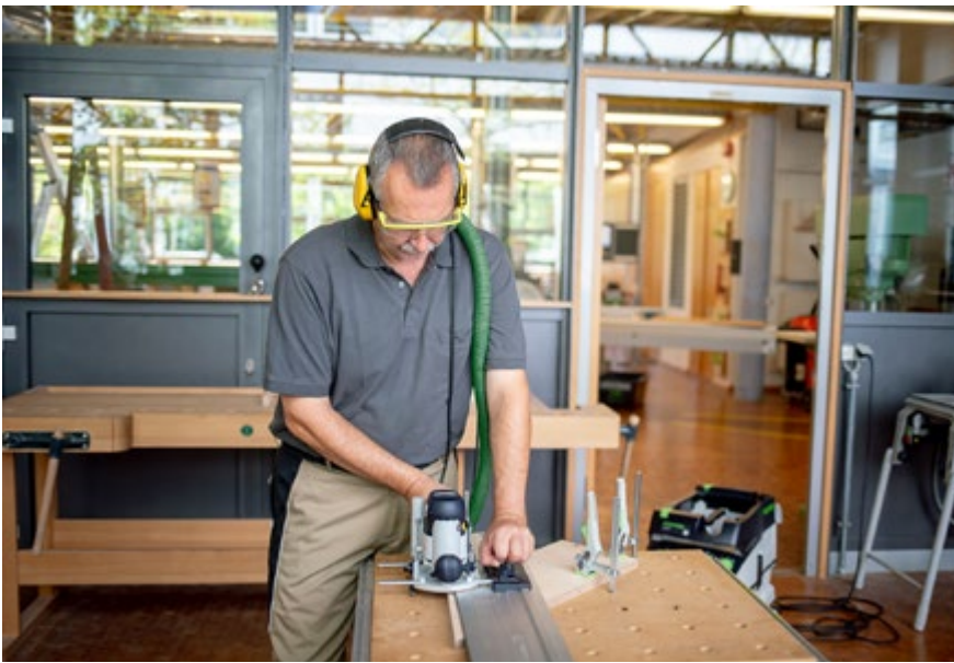
Abb. 3.3.2-03 Einfräsen von Nuten mit einer Führungsschiene
