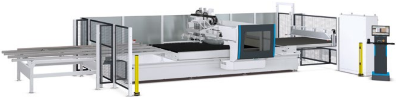
Abb. 3.1.11-01 CNC-Bearbeitungszentrum mit Schutzzaun und Kontakttrittmatte
