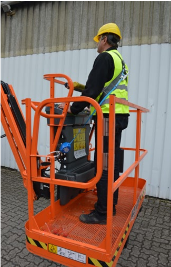
Abb. 3.5.4-02 Einsatz eines Höhensichtungsgeräts im Arbeitskorb
