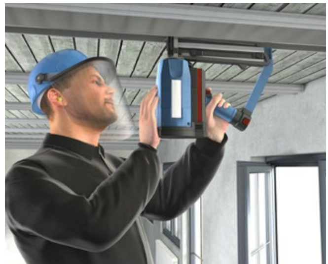
Abb. 3.3.7-03 Eintreibgerät mit Auslösesicherung
