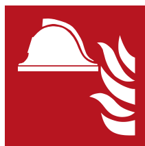
f004 Mittel und Geräte zur Brandbekämpfung
