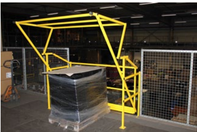
Abb. 3.4.3-05 Sicherheitschleuse für Lagerbühne
