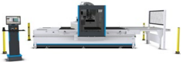
Abb. 3.1.11-02 CNC-Bearbeitungszentrum mit Zugangssicherung durch Lichtschranken
