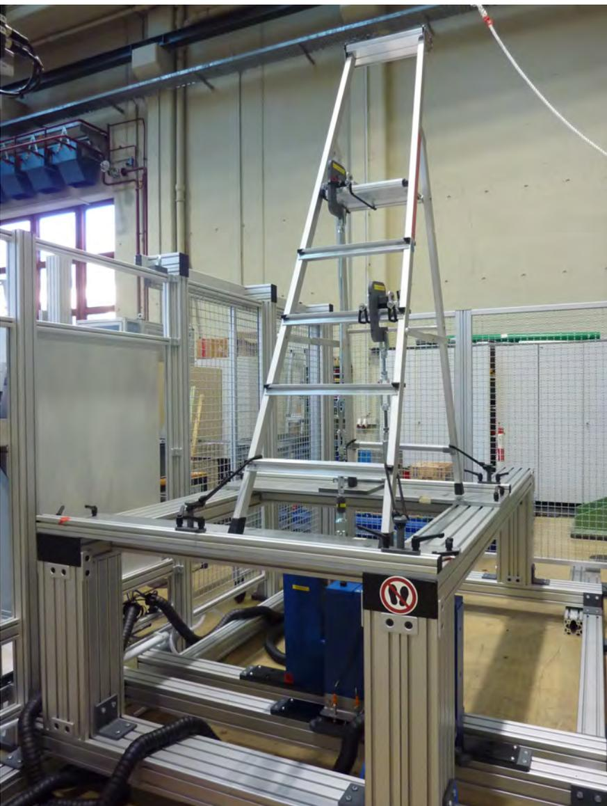
Prüfstand für die Dauerhaltbarkeit von Stehleitern
