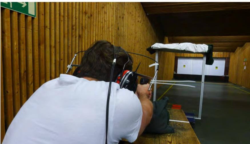
Messung der Lärmexposition eines Schützen in einer Raumschießanlage. Der Schallpegel wird in der Nähe der Ohren ermittelt.
