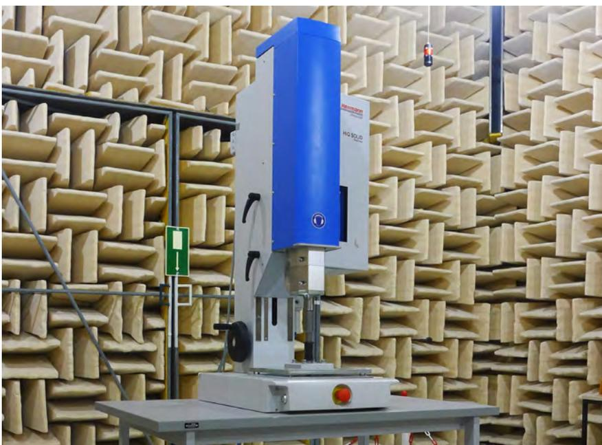
Referenzarbeitsplatz zur Erforschung eines Messverfahrens für luftgeleiteten Ultraschall
