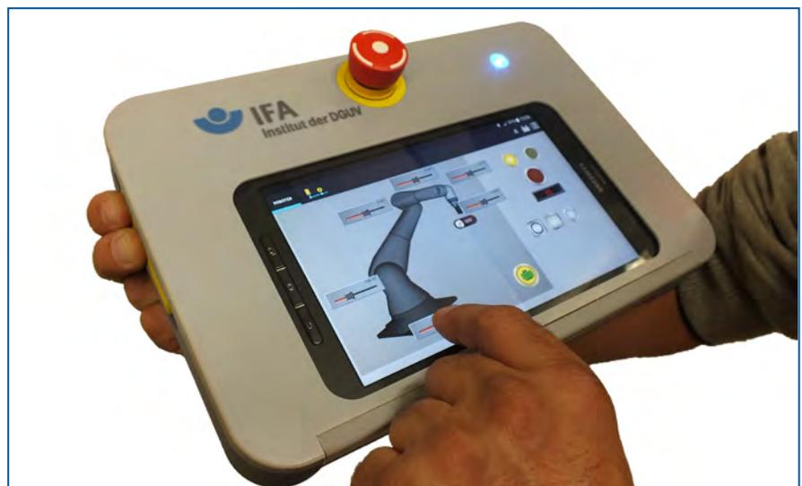
Demonstrationsmodell eines Tablet-Rahmens
