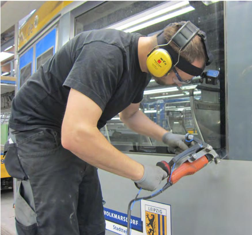
Ermittlung der Vibrationsminderung von Oszillationsmessern
