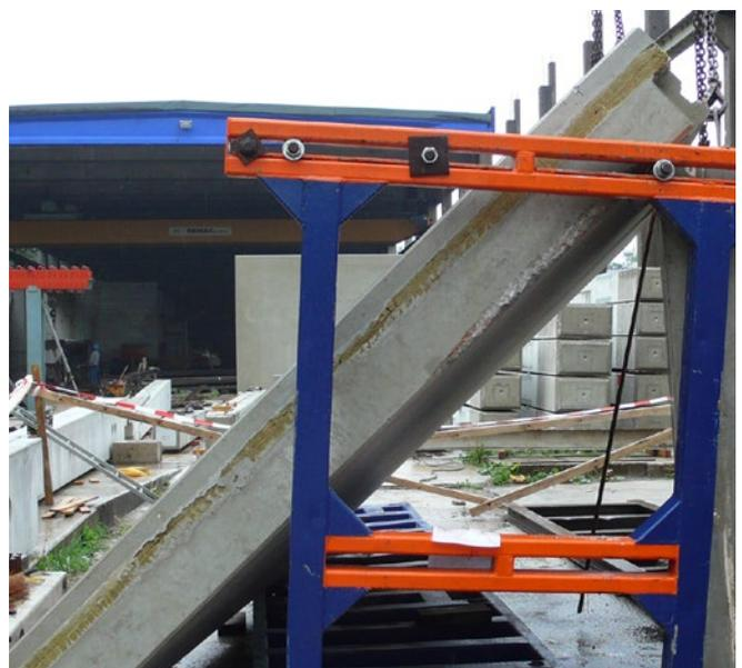
Abb. 11: Umsturz der Last durch Einwirken äußerer Kräfte
