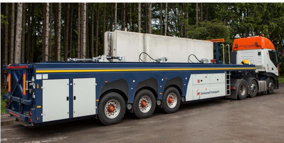
Abb. 3: Innenlader-Fahrzeug mit beladener IP
