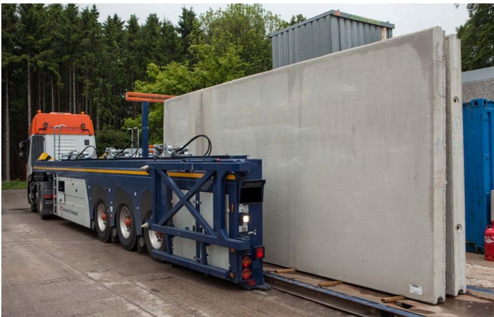
Abb. 2: Aufnehmen einer beladenen IP mit dem Innenlader-Fahrzeug
