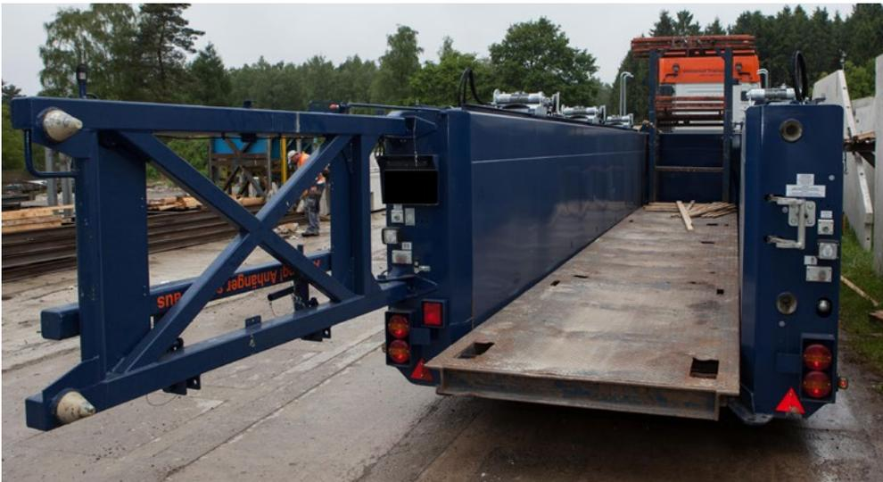
Abb. 1: Innenlader-Fahrzeug mit unbeladener IP
