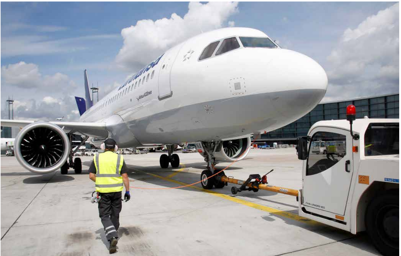
Abb. 94 Pushback (Flugzeugschleppen) mit Walk-Out-Assistent
