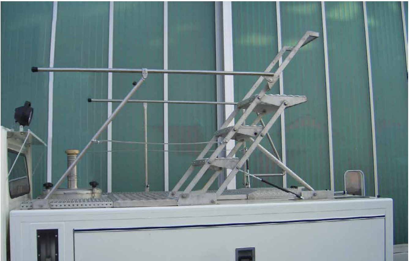
Abb. 79 Absturzsicherung auf einem Servicefahrzeug
