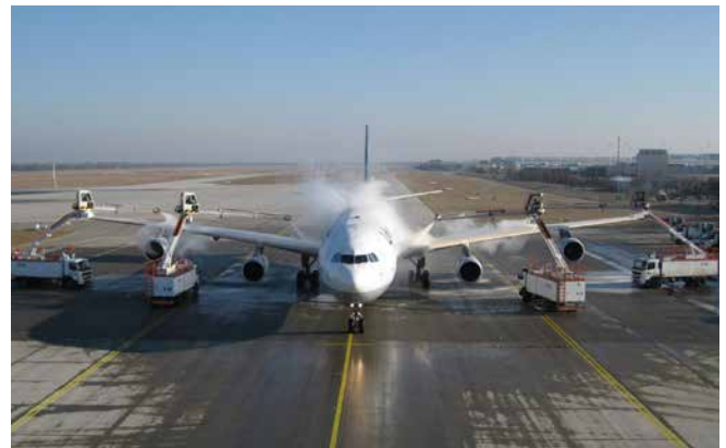
Abb. 87 Enteisung eines Großraumflugzeuges
