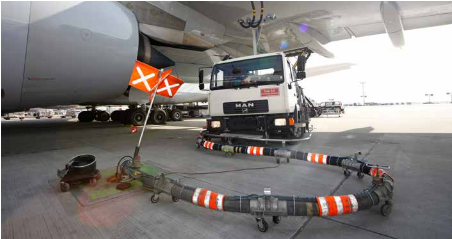
Abb. 84 Betanken eines Luftfahrzeugs mittels Dispenser
