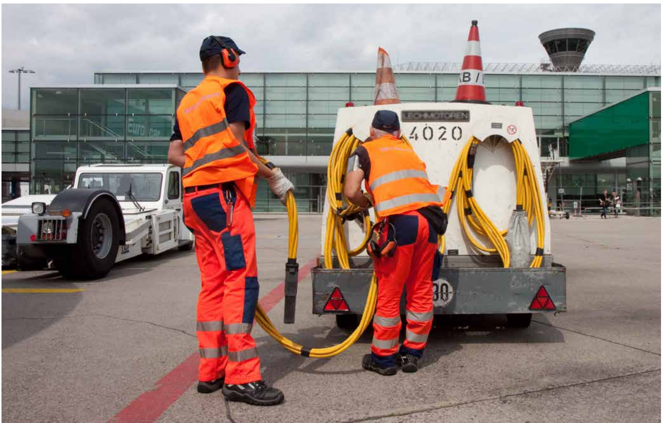
Abb. 35 Ground Power Unit (GPU) mit Kabelhalterung
