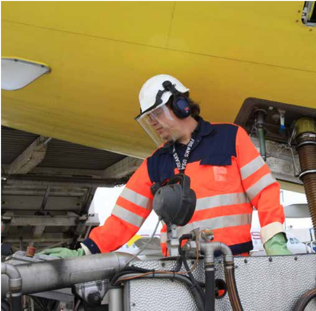
Abb. 20 PSA bei der Entsorgung von Fäkalien
