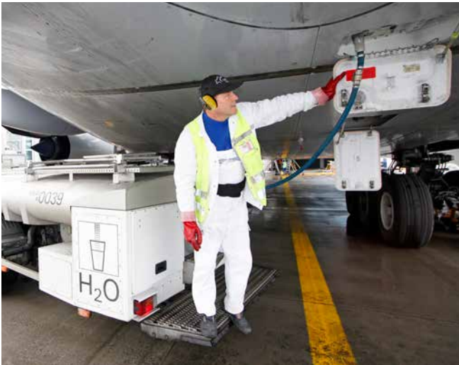
Abb. 80 Frischwasserversorgung am Luftfahrzeug
