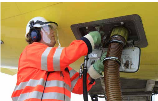
Abb. 81 PSA mit Gesichtsschutz beim Fäka-Service
