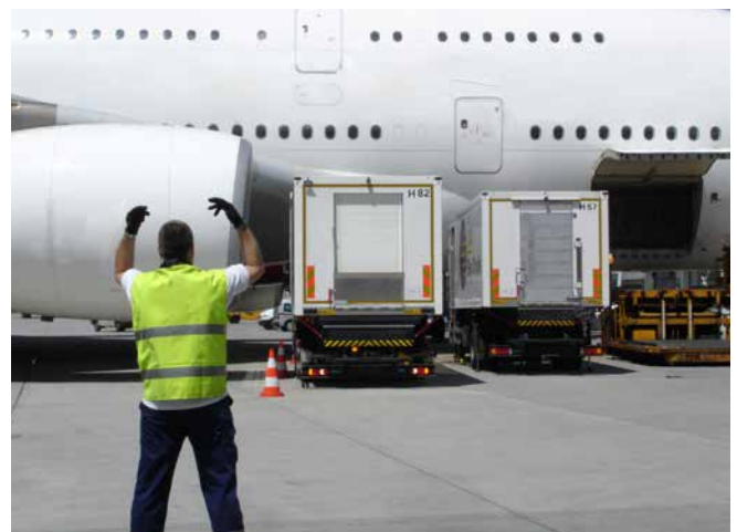
Abb. 76 Einweiser beim Zurücksetzen des Catering-Hubfahrzeuges
