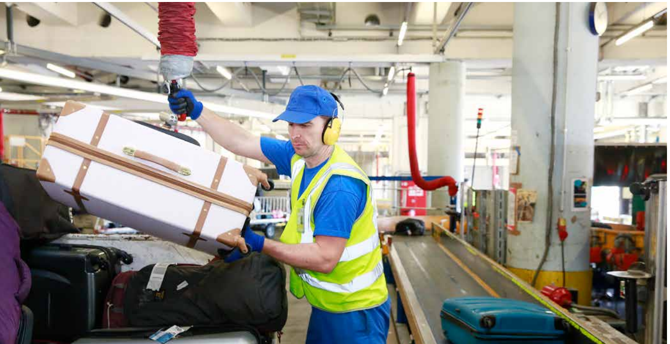
Abb. 65 Arbeiten mit Vakuum-Hebehilfe
