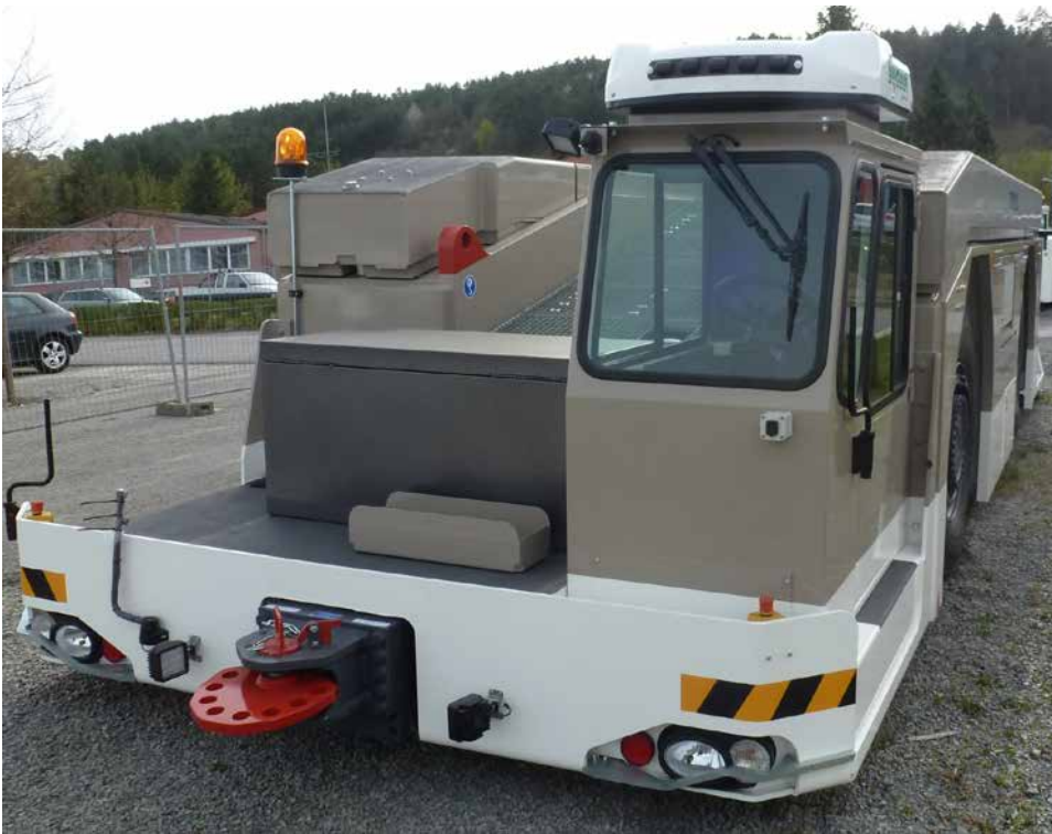
Abb. 98 Flugzeugschlepper mit Klimaanlage
