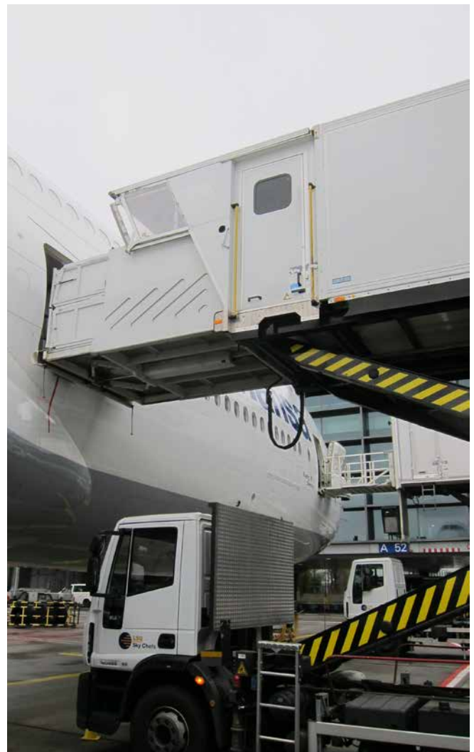
Abb. 77 Catering-Hubfahrzeug mit breiter Plattform
