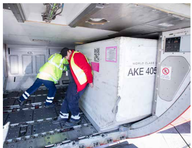
Abb. 54 Positionieren eines Frachtcontainers im Frachtraum
