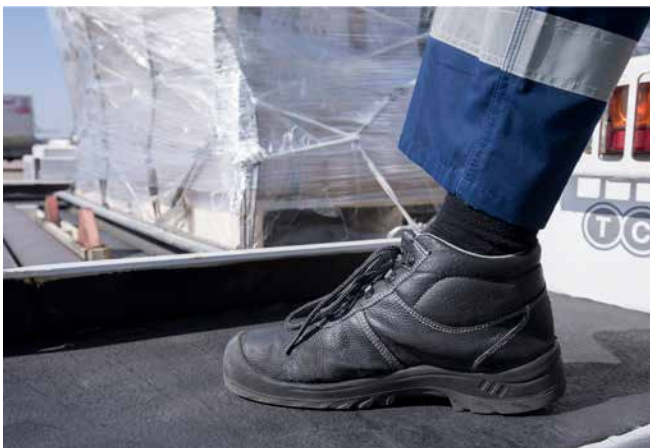
Abb. 3 Arbeitsplattform mit rutschhemmendem Fußbodenbelag
