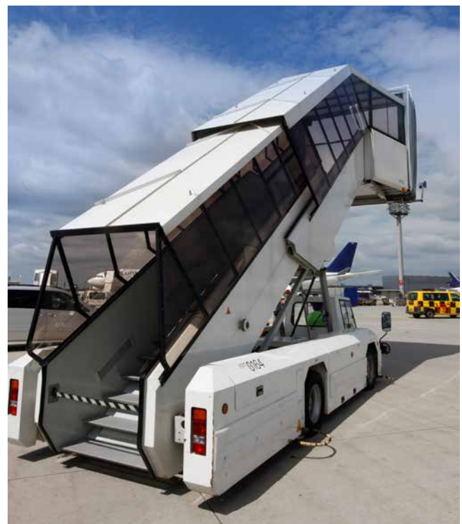
Abb. 44 Fluggasttreppe mit Witterungsschutz
