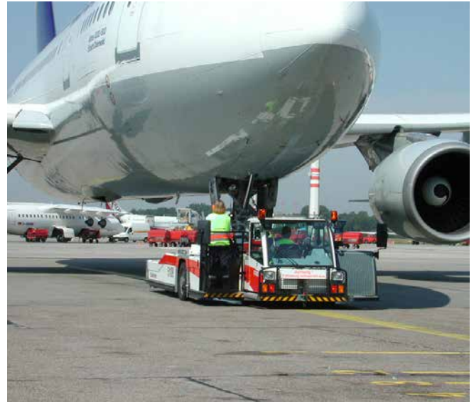
Abb. 97 Flugzeugschlepper mit Mitfahrerstehplatz
