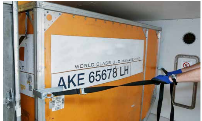
Abb. 52 Zurrgurt zum Verladen von Containern
