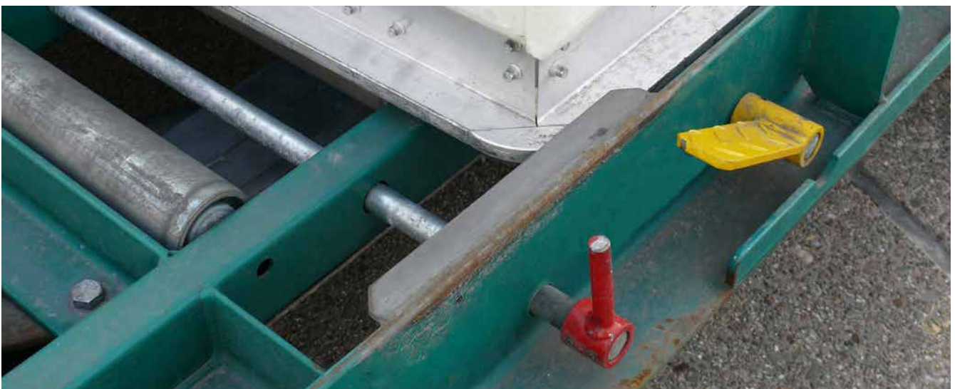
Abb. 62 Dolly mit zusätzlichem Sicherungsblech
