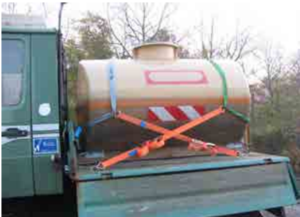
Abb. 161 Formschlüssige Ladungssicherung eines Tankes
