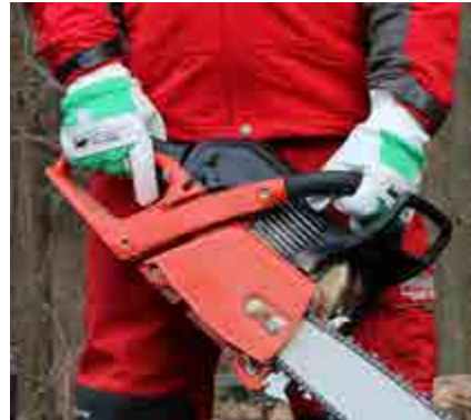
Abb. 82 Tragefreundlicher und griffsicherer Textilhandschuh für Motorsägearbeit
