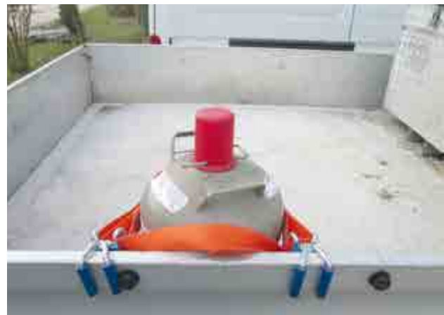
Abb. 162 Sicherung einer Flüssiggasflasche mit Umreifungsgurt und Bordwandkrallen
