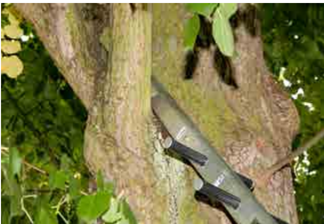
Abb. 129 Leiterkopf zum Anlegen in eine Astgabel
