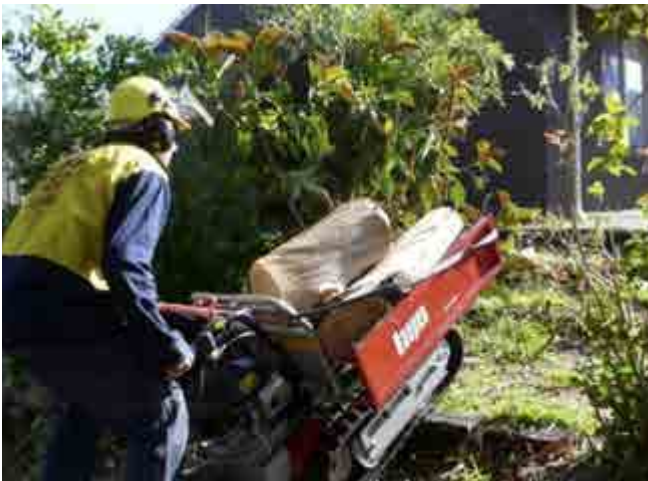
Abb. 152 Mini-Dumper/Motorschubkarre für ergonomischen Materialtransport im Gelände
