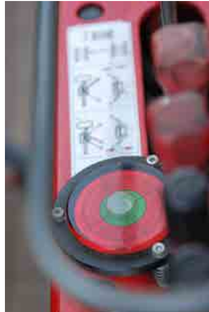
Abb. 115 Libelle zur Überprüfung der waagerechten Aufstellung
