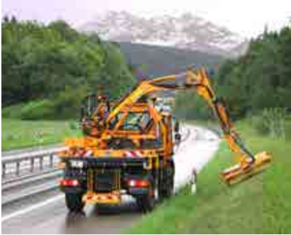
Abb. 52 Alternative am Hang: Auslegermäherwerk
