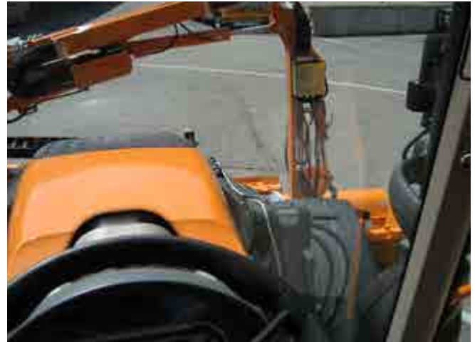
Abb. 46 Sichteinschränkung durch Auslegergeräte
