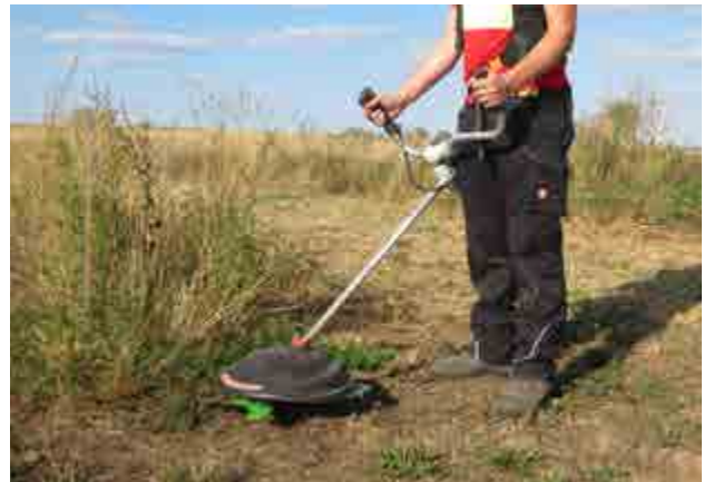
Abb. 58 Luftkissenprinzip und spezielle Schutzhaube
