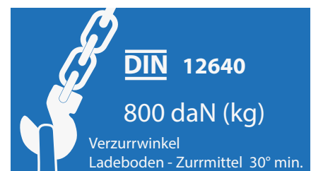
Abb. 159 Kennzeichnung eines Zurrpunktes
