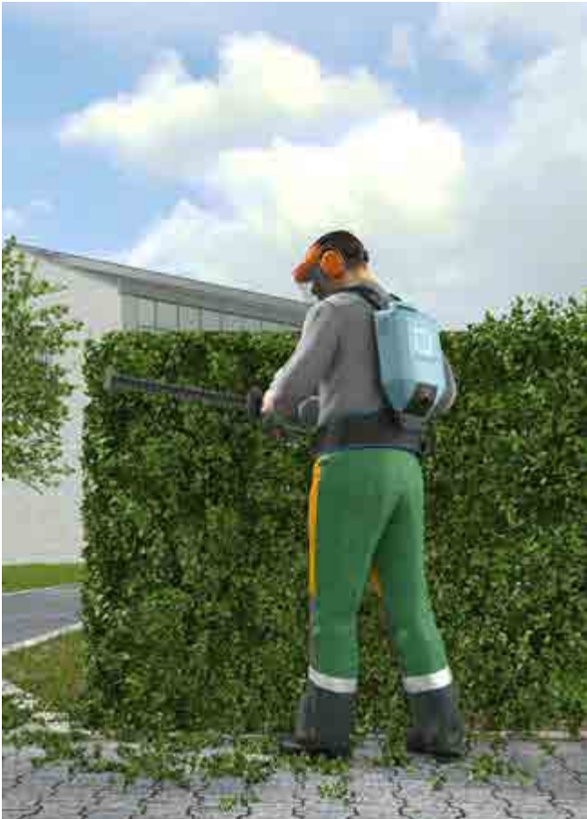
Abb. 67 Ergonomisch vorteilhaft: Heckenschere mit rückentragbarem Akku
