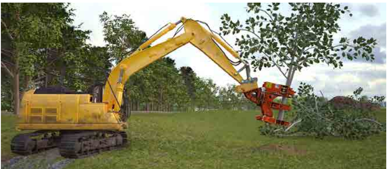
Abb. 110 Trägerfahrzeug mit Baumschere
