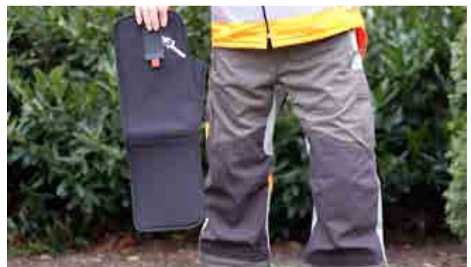
Abb. 68 Hosen mit Schnittschutzprotektoren für den Heckenschnitt
