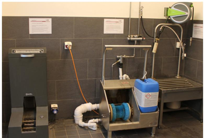
Abb. 65 Schuhreinigungs- und Desinfektionsanlage
