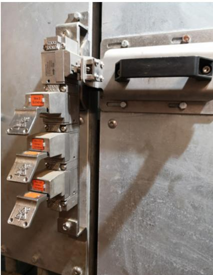
Abb. 13 Schlüsseltransfersystem, Zuhaltung an einer Gehegetür
