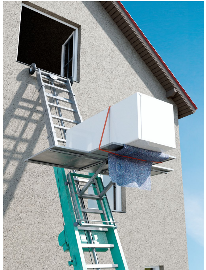
Abb. 25 Der Einsatz eines Anlegeaufzugs vermeidet Ganzkörperkräfte beim Transport schwerer Möbelstücke über enge Treppenhäuser.
